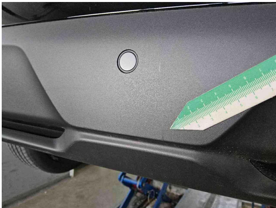
Bild 19 : Stoßfänger hinten Spoiler zerkratzt
