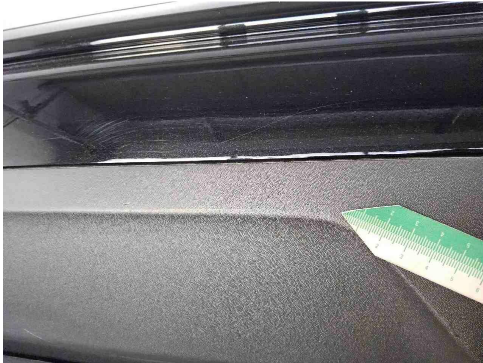
Bild 20 : Stoßfänger hinten Spoiler zerkratzt
