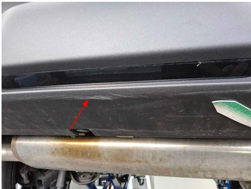
Bild 21 : Stoßfänger hinten Spoiler zerkratzt
