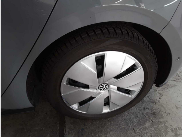
Beschädigung #3: Rad/Reifen: Radblende hinten links - verkratzt / verschürft - erneuern
