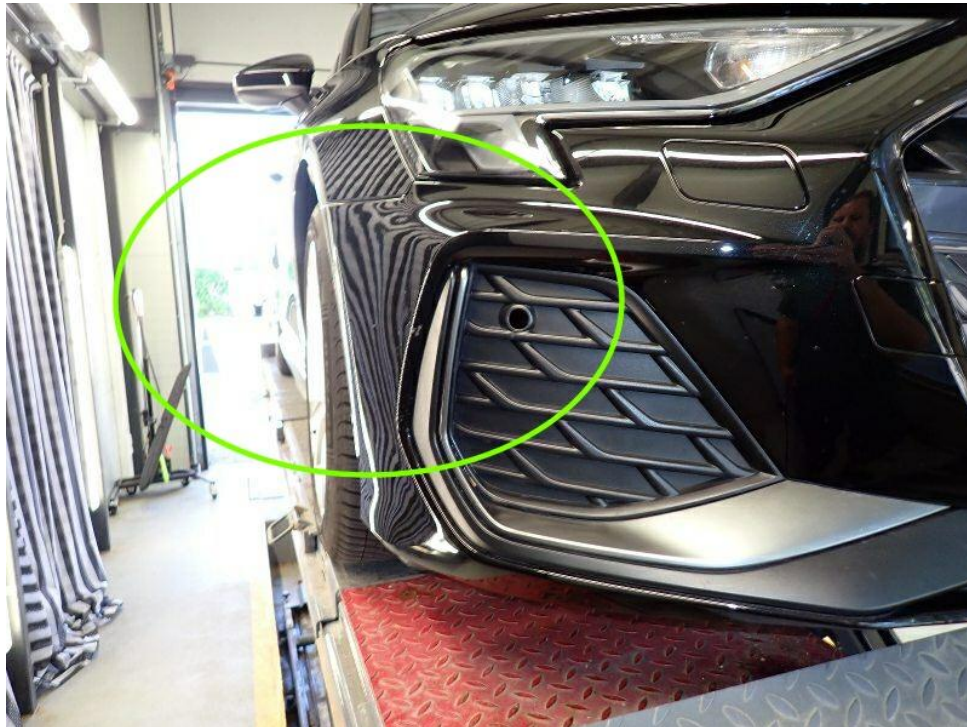
Bild 13 : Streifschaden VR (Stoßfänger vorn, Blende VR, Einparksensor VR außen einedrückt)
