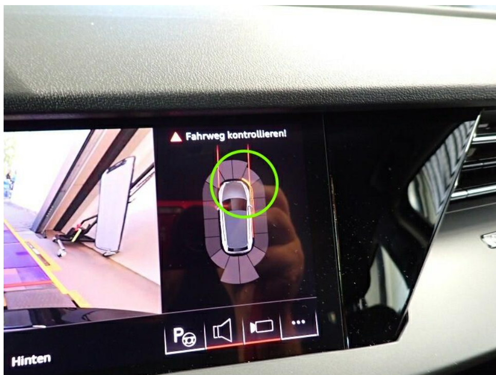
Bild 14 : Streifschaden VR (Stoßfänger vorn, Blende VR, Einparksensor VR außen einedrückt) Fehlermeldung Sensor
