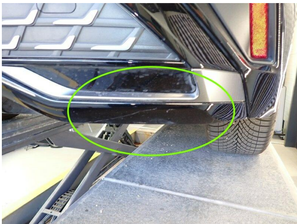
Bild 20 : Stoßfänger hinten Unterteil Kratzer
