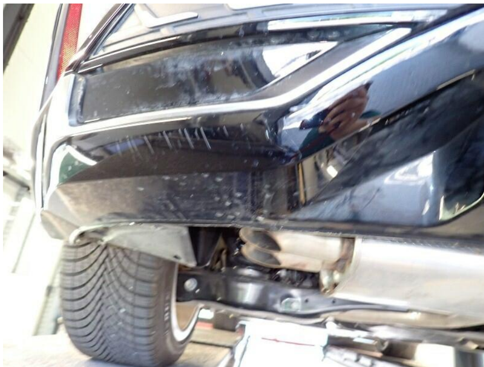
Bild 26 : Stoßfänger hinten Unterteil Kratzer
