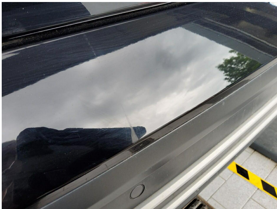
Bild 7 : Stoßfänger hinten Lackierung, zerkratzt, polieren
