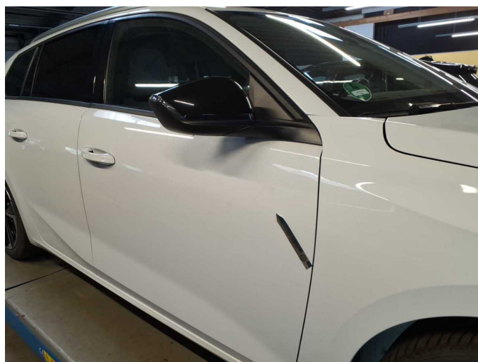
Damage 2: Door - front right side: Door (Kleberreste) - Smart repair
