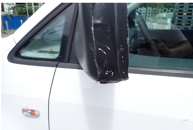
Beschädigung 9: Außenspiegel links: Abdeckkappe - gebrochen / gerissen - erneuern
