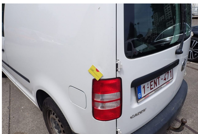
Beschädigung 5: Seitenwand links: Radlauf - Delle(n) - Smart Repair
