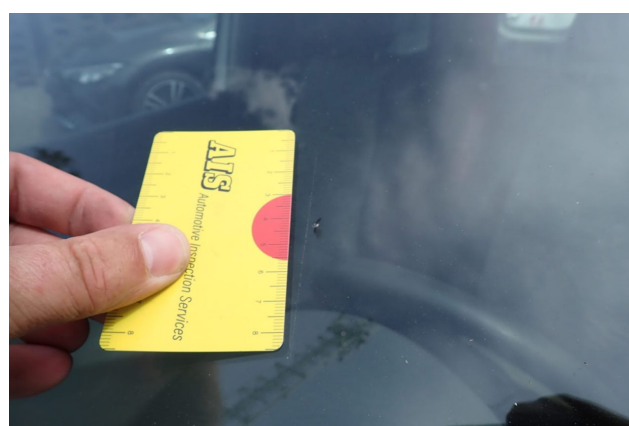
Beschädigung 6: Verglasung: Frontscheibe - Steinschlag - Smart Repair
