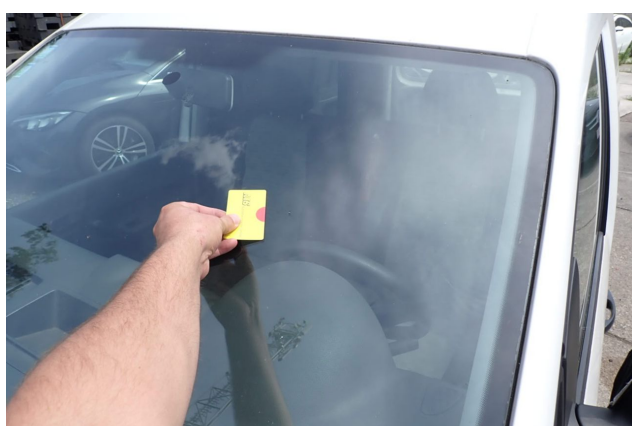
Beschädigung 6: Verglasung: Frontscheibe - Steinschlag - Smart Repair
