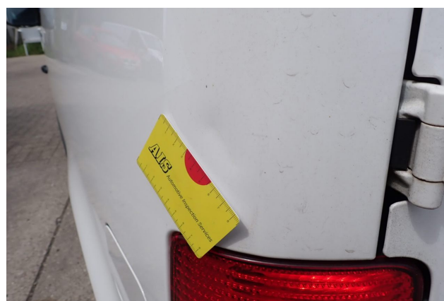
Beschädigung 5: Seitenwand links: Radlauf - Delle(n) - Smart Repair
