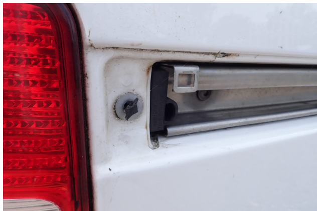
Beschädigung 4: Schiebetür rechts: Türdichtung - fehlt - erneuern
