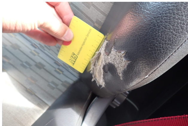
Beschädigung 11: Sitz vorn: Sitzbezug links - gebrochen / gerissen - erneuern
