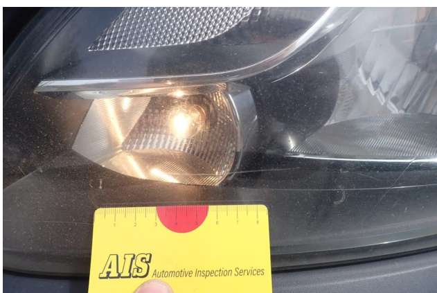
Beschädigung 3: Scheinwerfer: Scheinwerfer links - verkratzt / verschürft - kein Abzug
