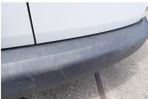
Gebrauchsspur 1: Stossfänger hinten: Stossfänger hinten - verkratzt / verschürft - kein Abzug
