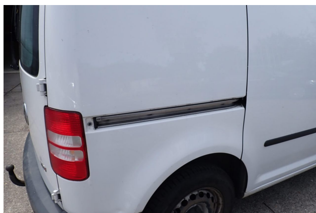
Beschädigung 4: Schiebetür rechts: Türdichtung - fehlt - erneuern
