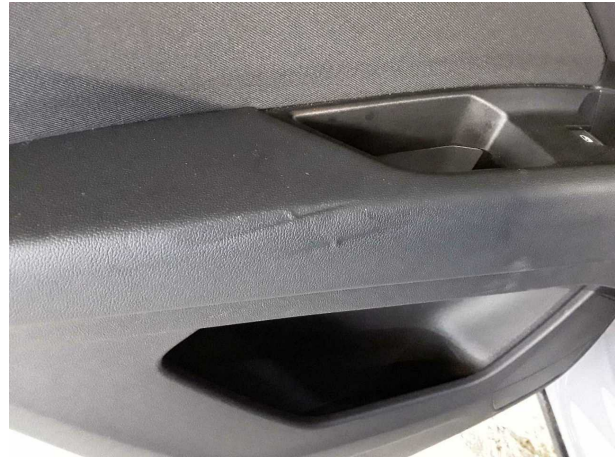
Beschädigung #1: Verkleidungen/Abdeckungen: Türverkleidung hinten links (Druckstellen) - kein Abzug
