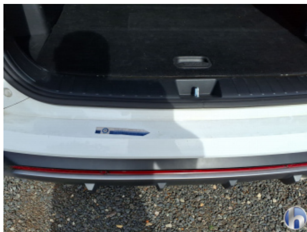
1. Stoßfänger Hinten Oberflächenkratzer - Aufbereiten / Polieren
