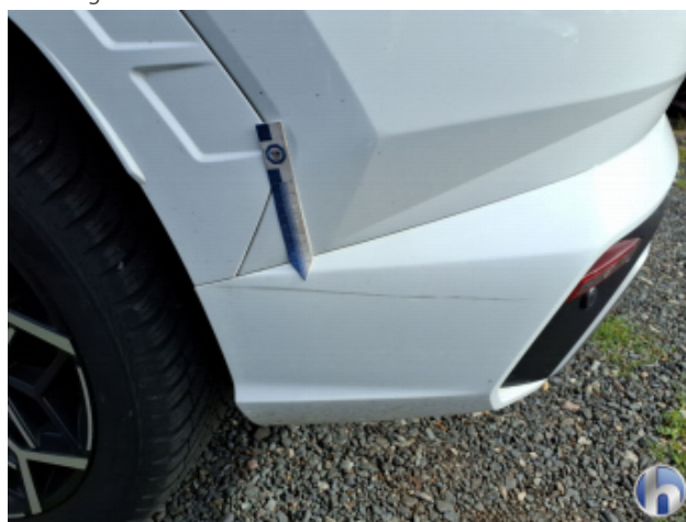
1. Stoßfänger Hinten Oberflächenkratzer - Aufbereiten / Polieren
