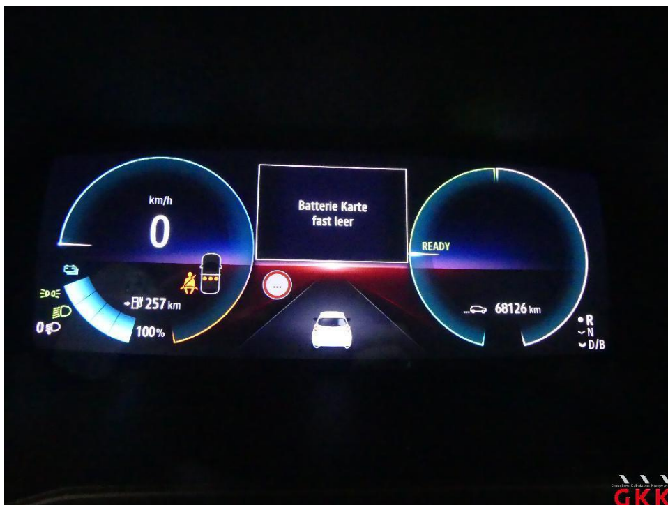
Bild 14 Hauptschlüssel, Batterie, entladen, ersetzen
