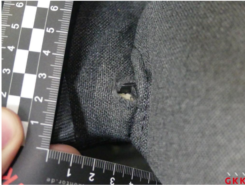
Bild 33 Sitz vorne links, Bezug Sitzkissen -Stoff-, gerissen, ersetzen
