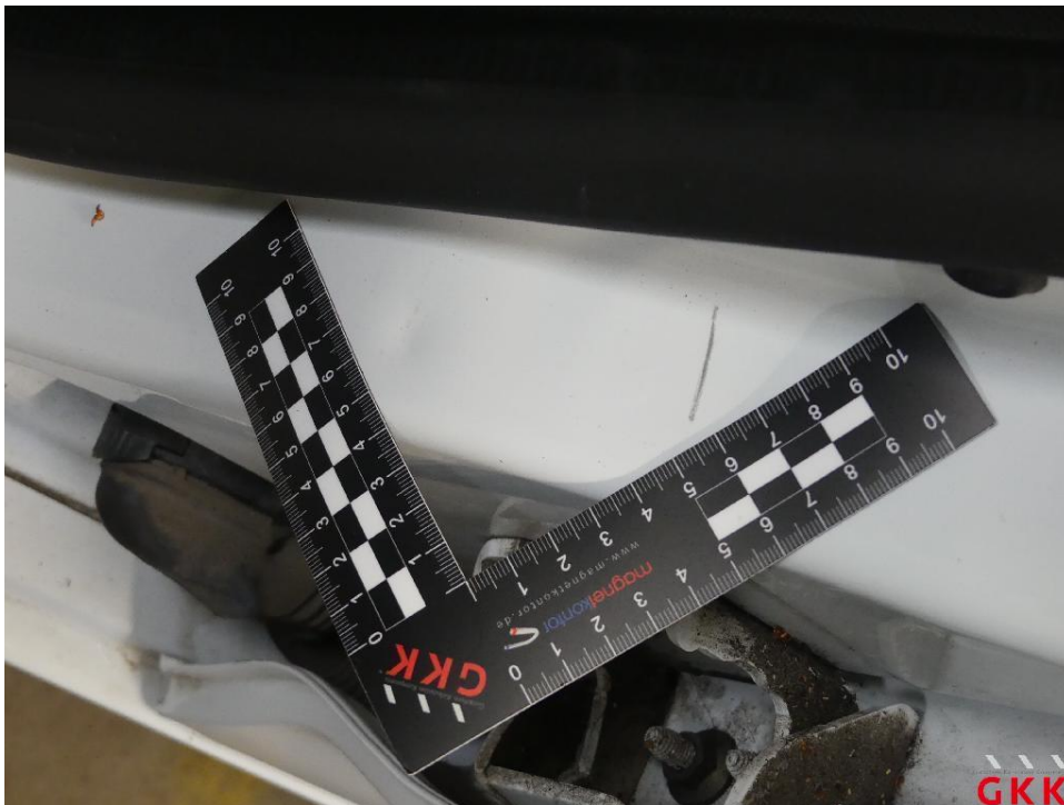
Bild 30 Tür vorne links, Einstieg, beschädigt, Smartrepair
