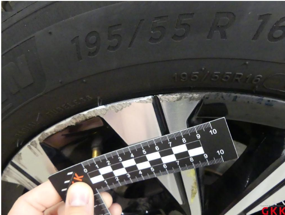
Bild 17 LM-Rad, vorne rechts, beschädigt, ersetzen
