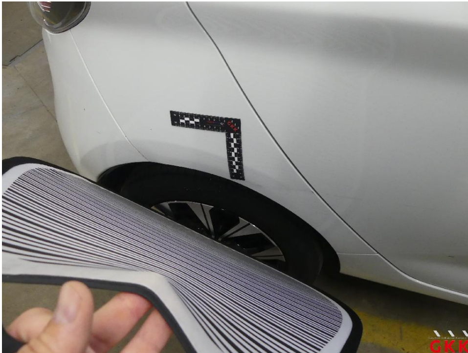
Bild 23 Seitenwand rechts, beschädigt, instand setzen - lackieren
