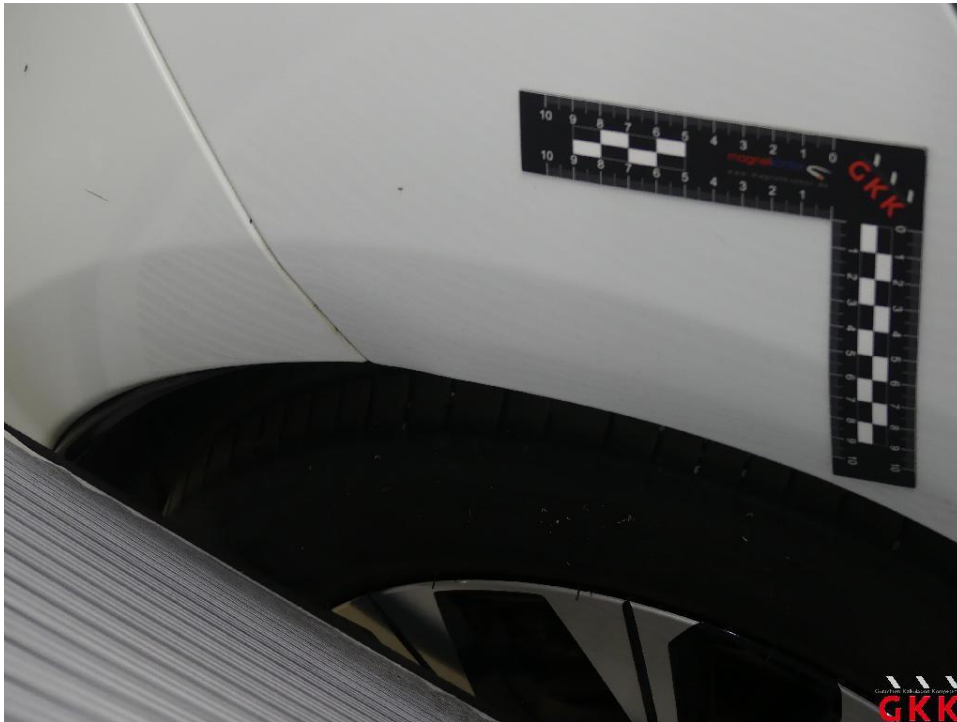
Bild 25 Seitenwand rechts, beschädigt, instand setzen - lackieren
