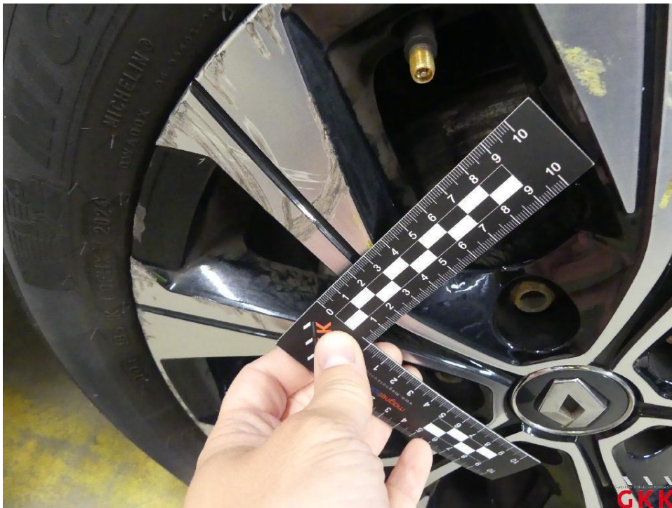
Bild 16 LM-Rad, vorne rechts, beschädigt, ersetzen
