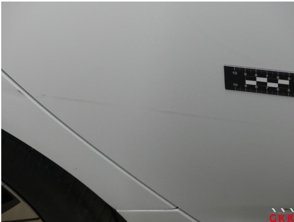
Bild 22 Tür hinten rechts, beschädigt, instand setzen - lackieren
