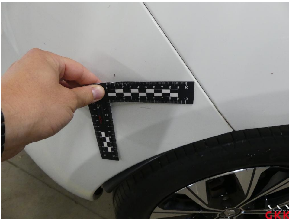
Bild 26 Stoßfänger hinten, Verkleidung -lackiert-, verkratzt, lackieren
