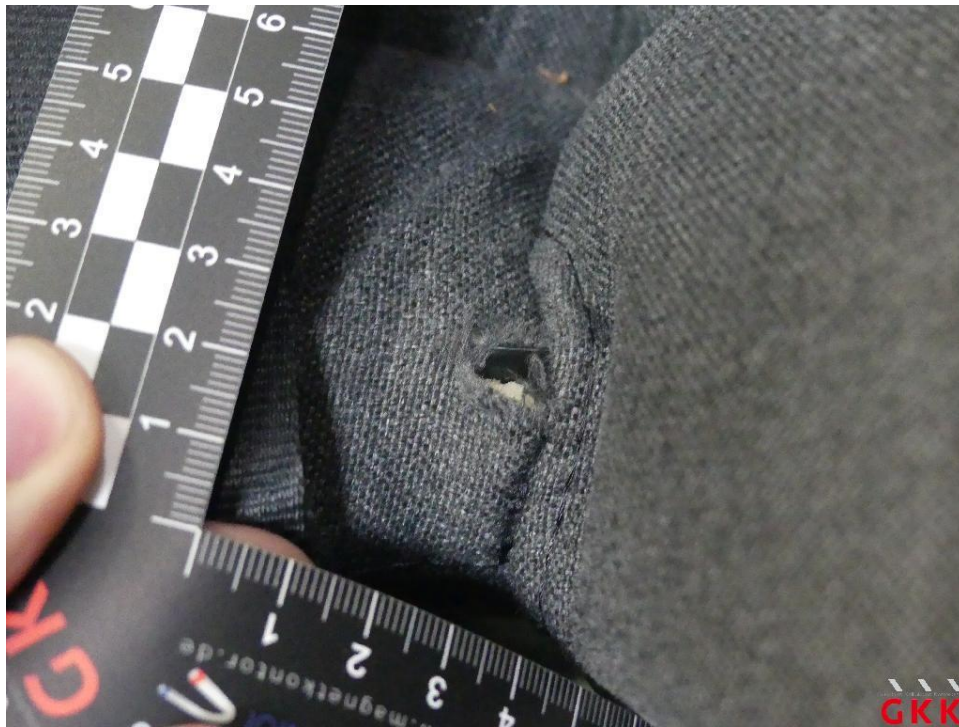
Bild 34 Sitz vorne links, Bezug Sitzkissen -Stoff-, gerissen, ersetzen
