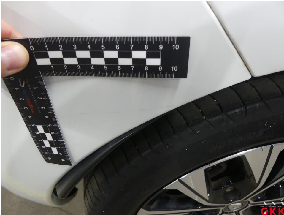
Bild 28 Stoßfänger hinten, Verkleidung -lackiert-, verkratzt, lackieren
