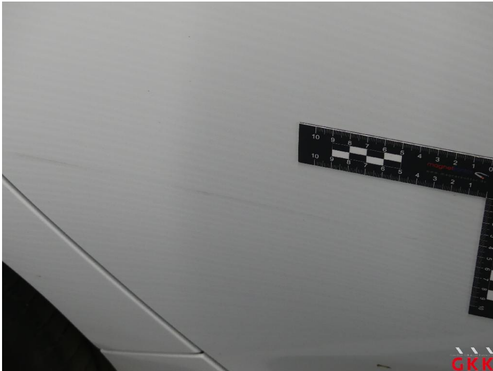
Bild 21 Tür hinten rechts, beschädigt, instand setzen - lackieren
