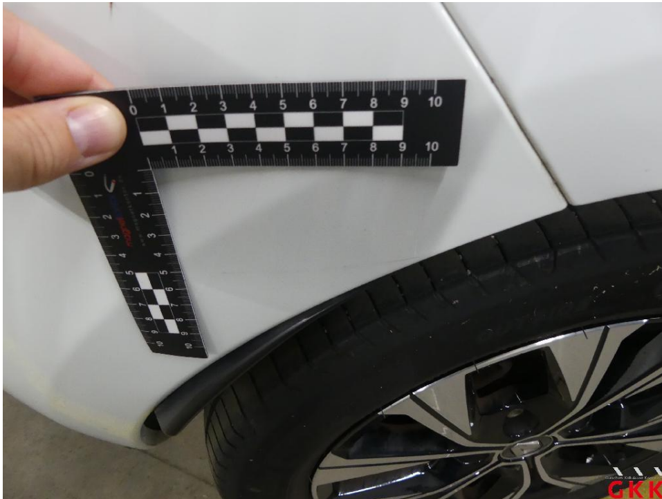
Bild 27 Stoßfänger hinten, Verkleidung -lackiert-, verkratzt, lackieren
