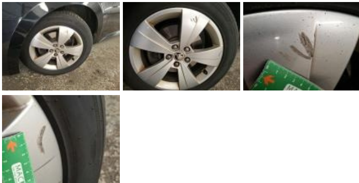
Aile AVG, Mauvaise réparation, Acceptable
