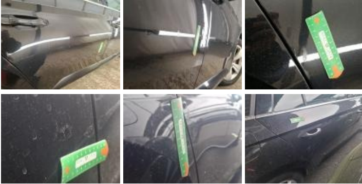
Porte AVD, Mauvaise réparation, Peindre
