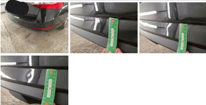
Pare-chocs AR, Déformé / Forcé, LI - Réparer et peindre (complet)
