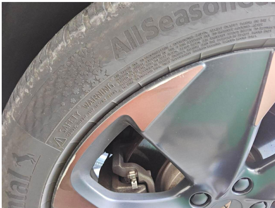
Bild 18 : Glanzgedrehte LM-Felge vorne rechts verkratzt
