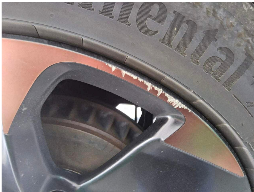
Bild 16 : Glanzgedrehte LM-Felge hinten rechts verkratzt
