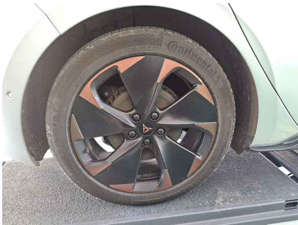
Bild 15 : Glanzgedrehte LM-Felge hinten rechts verkratzt
