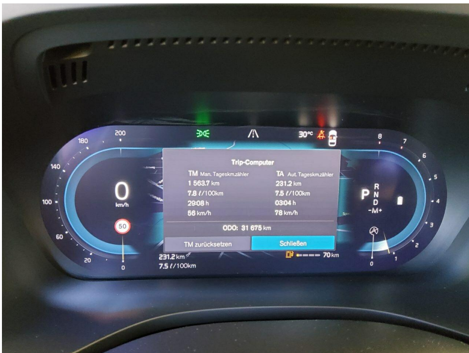
Bild 6 : Kombiinstrument (betriebsbereit) mit Km-Stand
