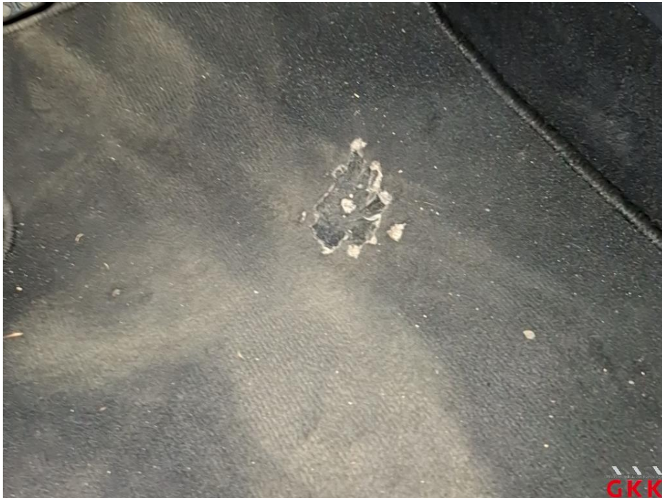
Bild 17 Fußmatte(n), vorne links, beschädigt, ersetzen
