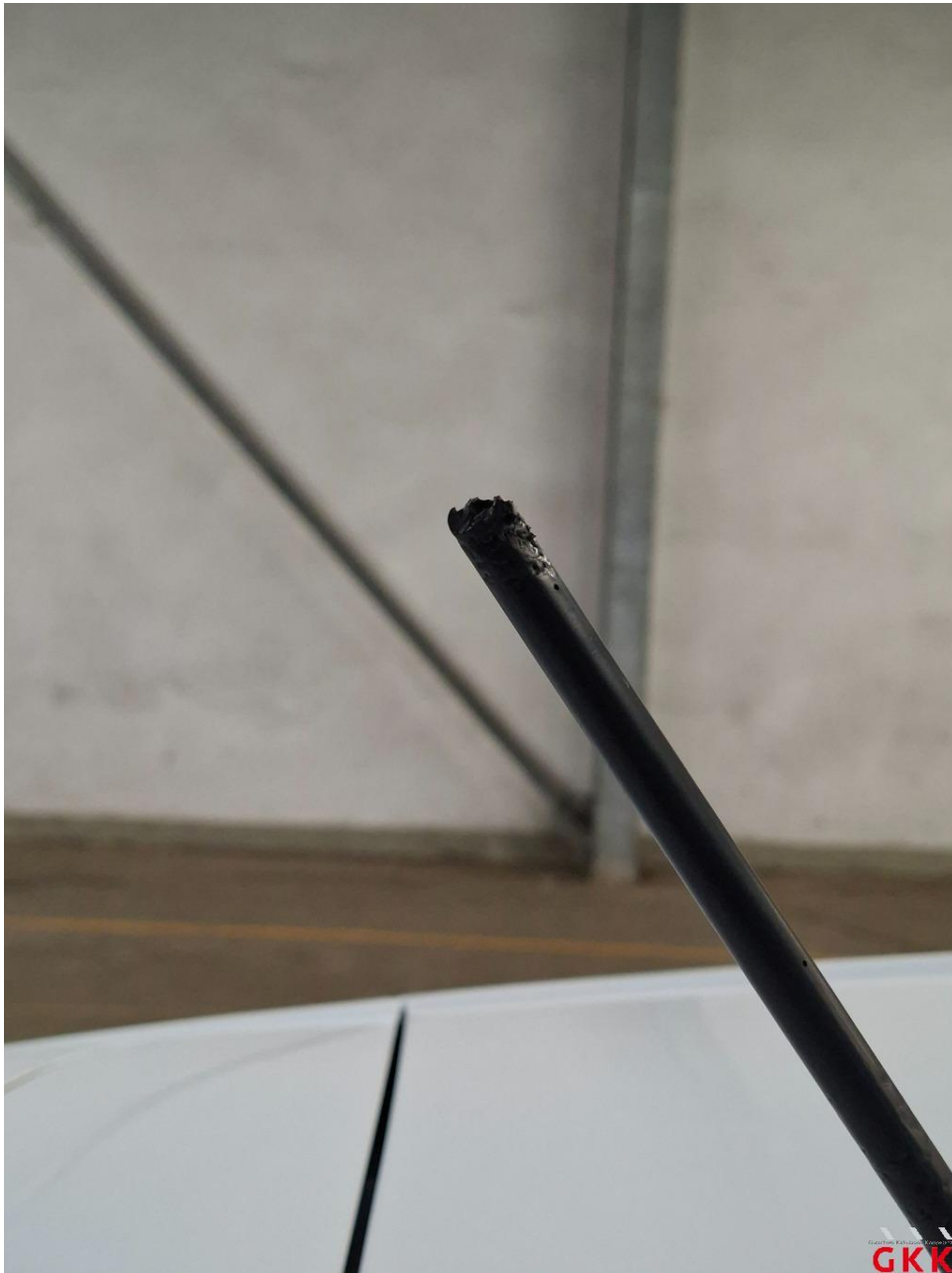
Bild 14 Antenne, Stab, beschädigt, ersetzen
