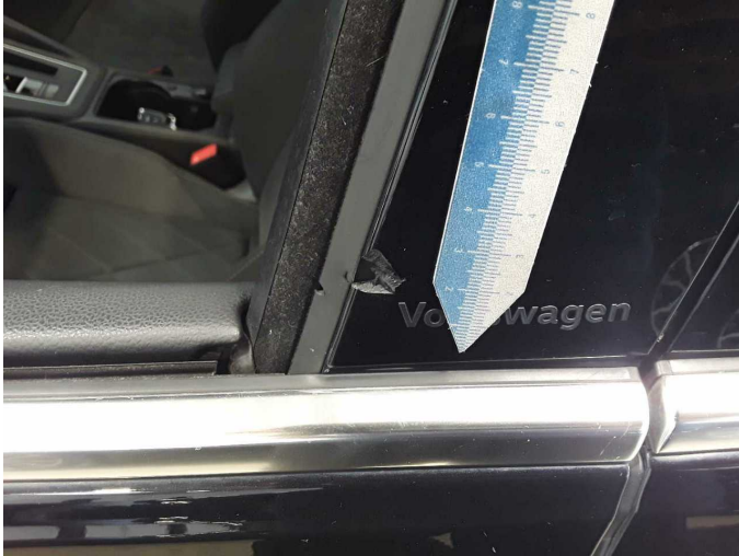
Damage 2: Body: B-pillar - left side (Zierleiste) - Broken / torn - Replace
