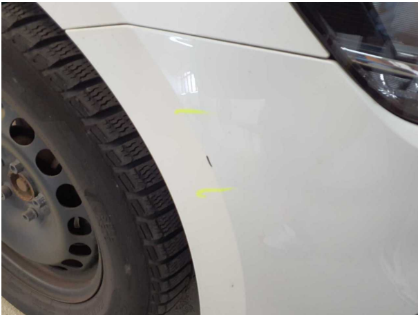
Beschädigung #6: Stossfänger vorn: Stossfänger vorn - verkratzt / verschürft - instandsetzen und lackieren
