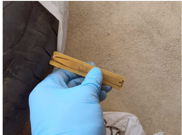
Beschädigung #4: 2.Radsatz: Reifensatz komplett - verschlissen - instandsetzen/lackieren (S1)
