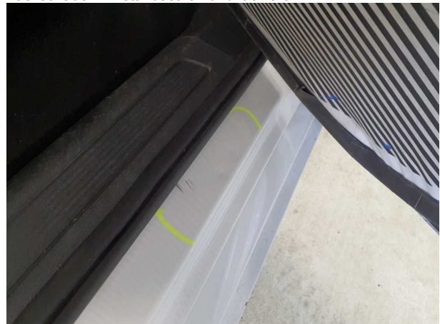
Beschädigung #3: Schweller rechts: Einstieg - Delle / Lackschaden - instandsetzen und lackieren
