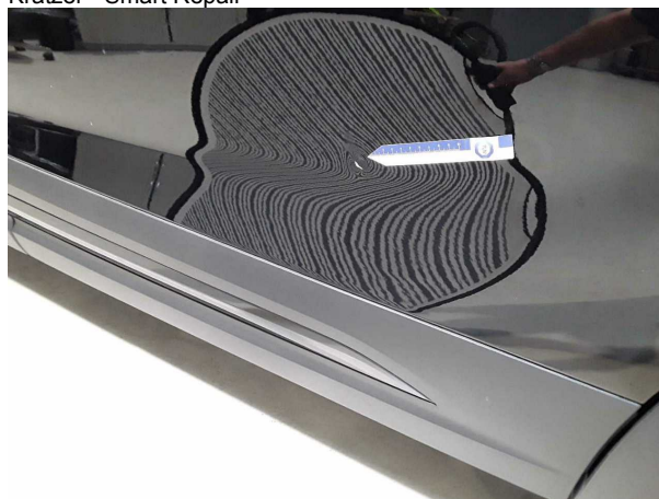
Beschädigung #2: Tür vorn rechts: Tür - Delle / Lackschade... instandsetzen und lackieren
