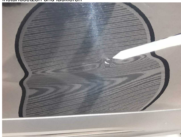
Beschädigung #2: Tür vorn rechts: Tür - Delle / Lackschade... instandsetzen und lackieren
