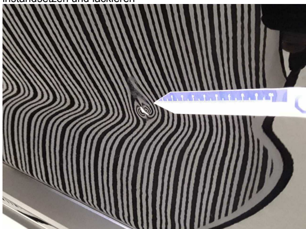
Beschädigung #2: Tür vorn rechts: Tür - Delle / Lackschaden - instandsetzen und lackieren
