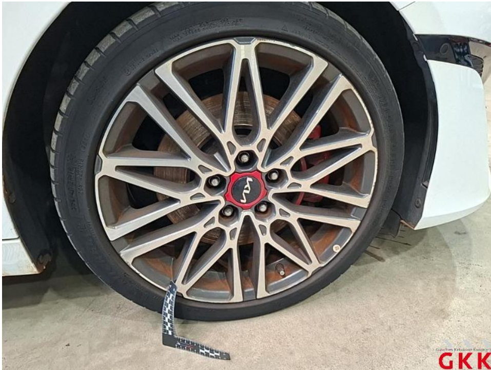
Bild 39. LM-Rad, vorne rechts, Materialabtrag, ersetzen
