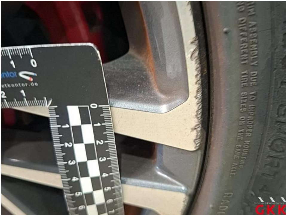
Bild 41. LM-Rad, vorne rechts, Materialabtrag, ersetzen
