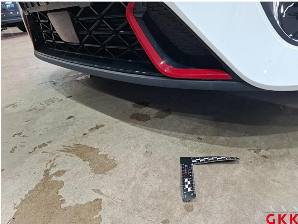
Bild 26. Stoßfänger vorne, Spoiler -unlackiert-, beschädigt, ersetzen
