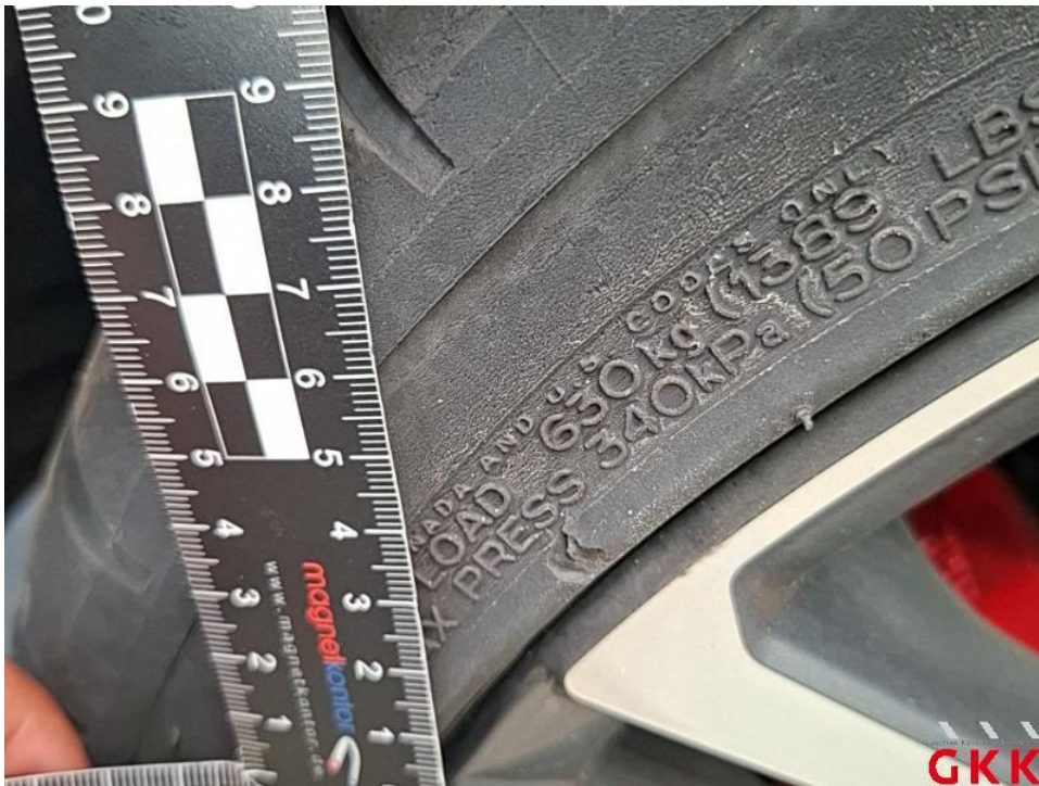
Bild 35. Reifen, hinten rechts, beschädigt, ersetzen
