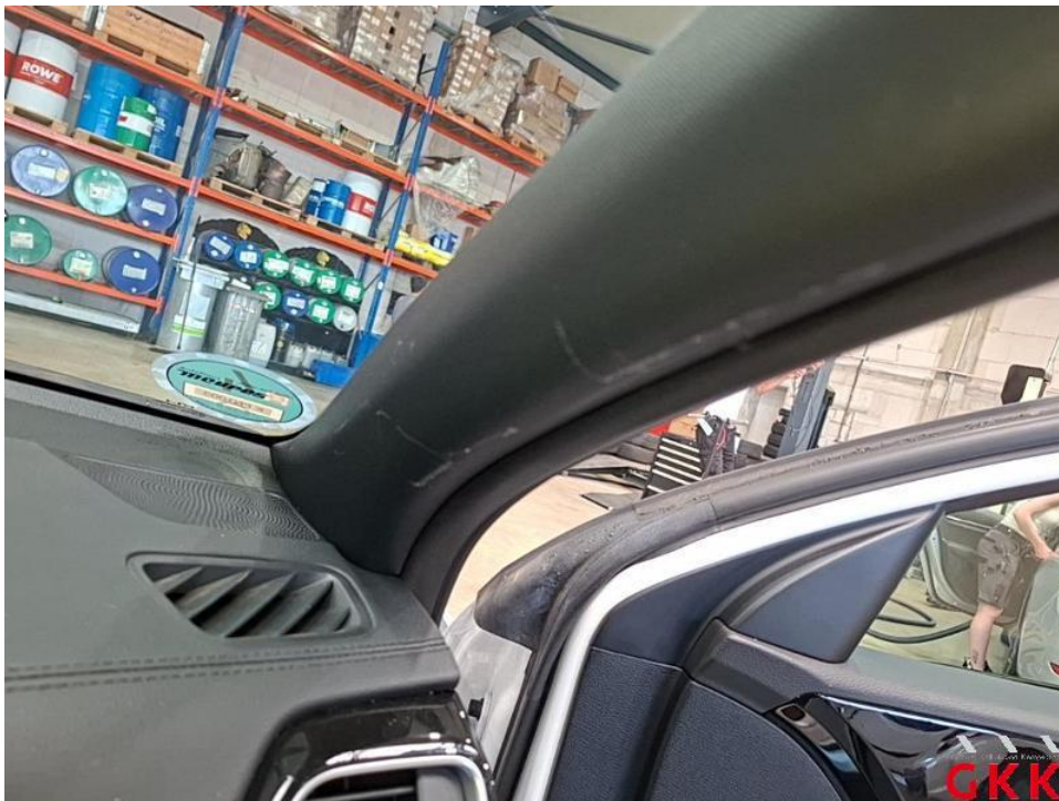
Bild 44. A- Säule rechts, Innenverkleidung, verkratzt, ersetzen
