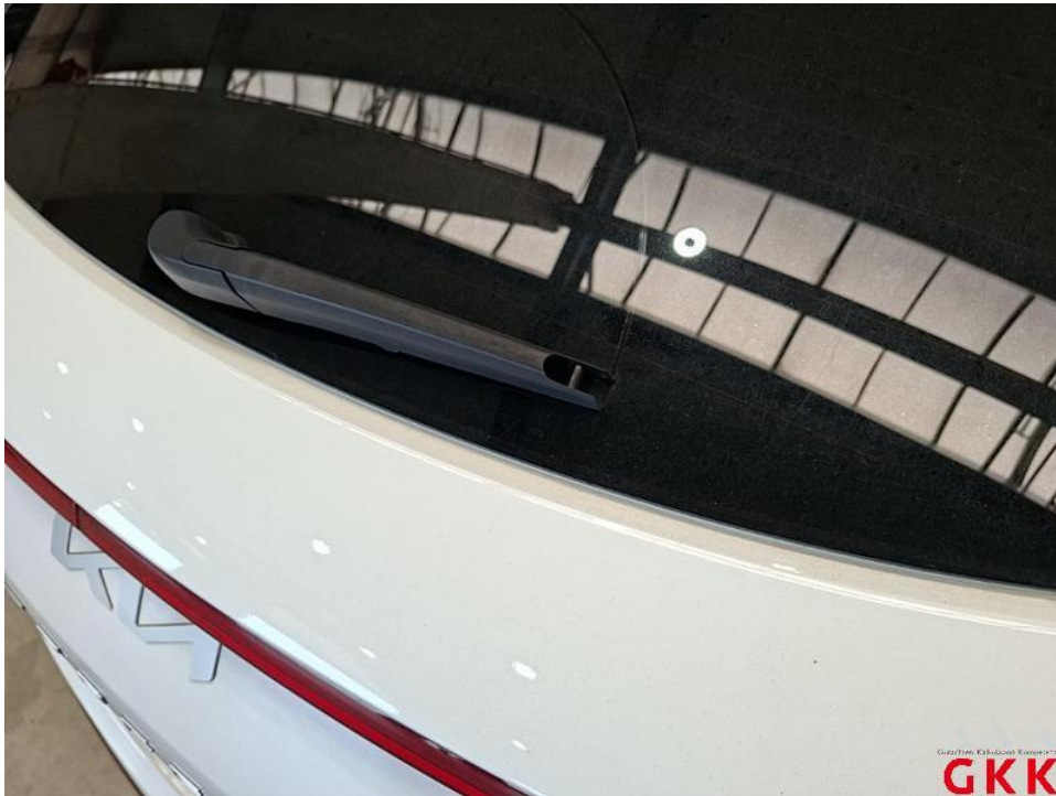
Bild 17. Heckwischer, Blatt, fehlt, ersetzen
