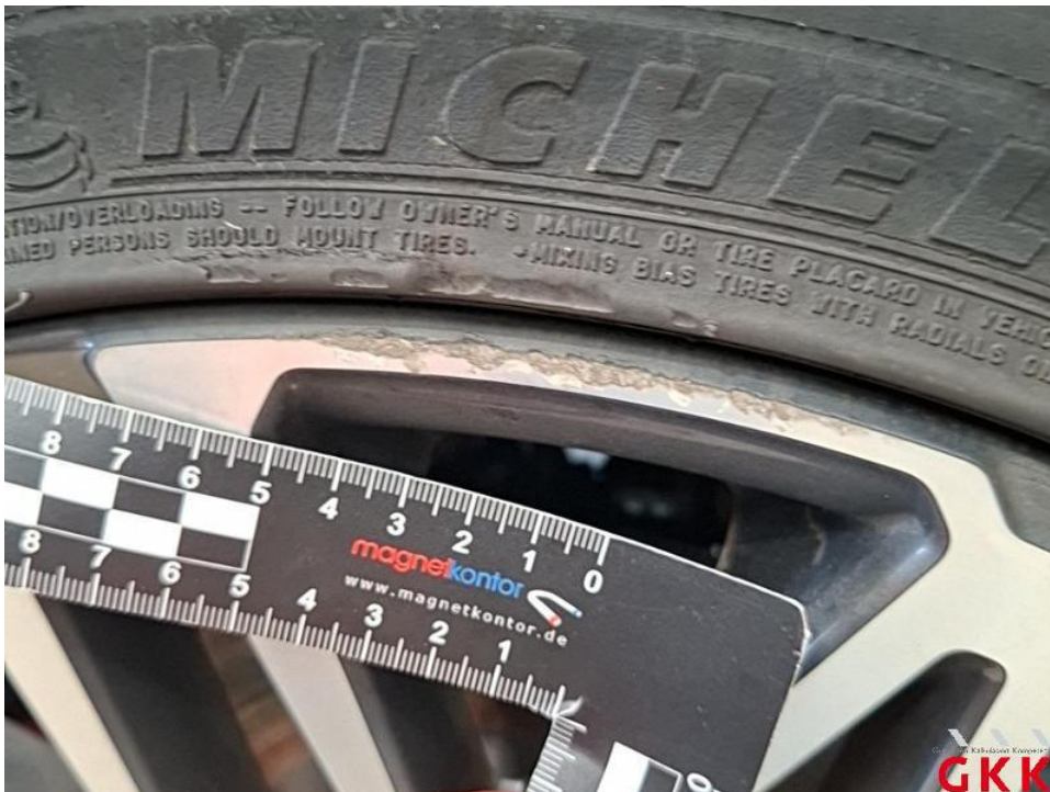
Bild 34. Reifen, hinten rechts, beschädigt, ersetzen
