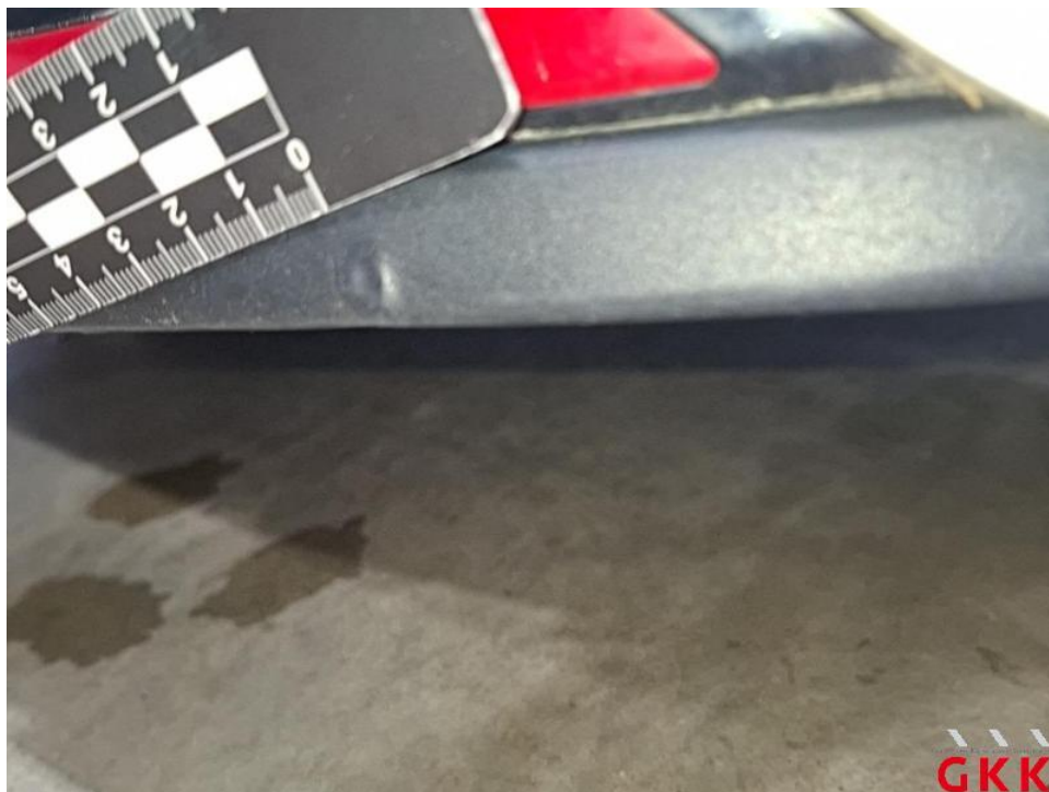
Bild 27. Stoßfänger vorne, Spoiler -unlackiert-, beschädigt, ersetzen
