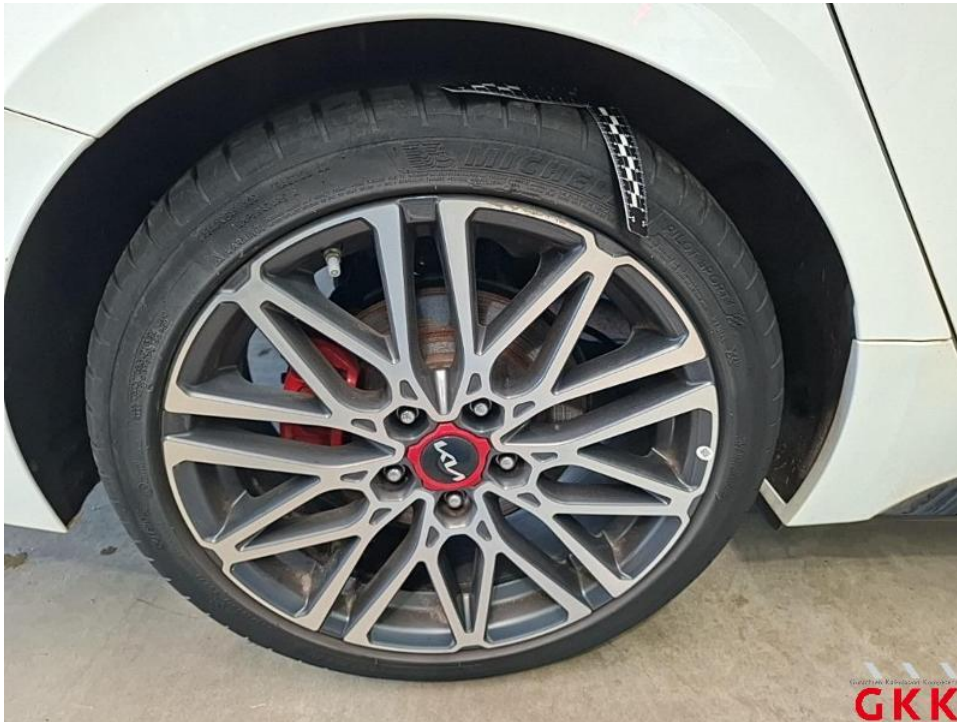
Bild 31. LM-Rad, hinten rechts, Materialabtrag, ersetzen
