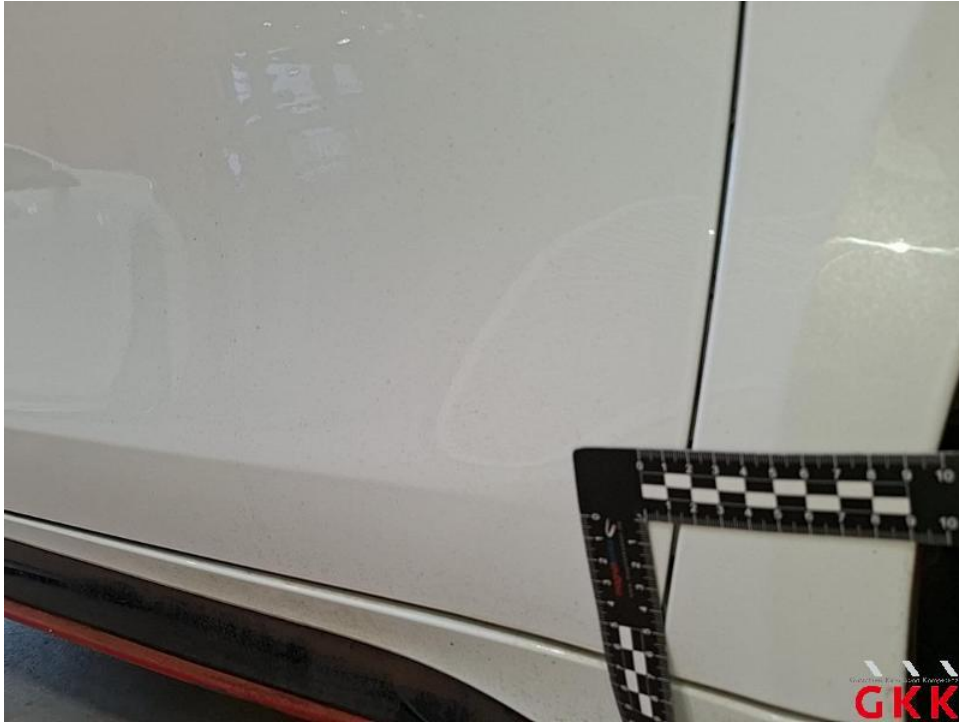
Bild 47. Fahrzeug, außen, Industriestaubanhaftung / Flugrost, aufbereiten
