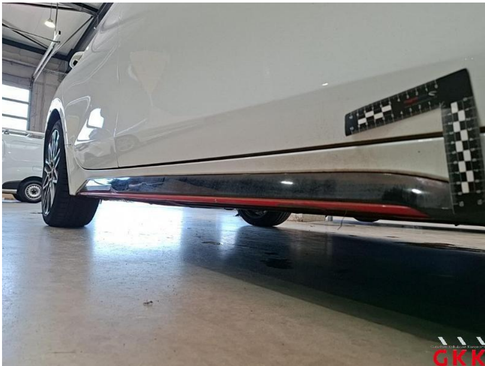
Bild 36. Schweller rechts, Verkleidung -lackiert-, beschädigt, ersetzen
