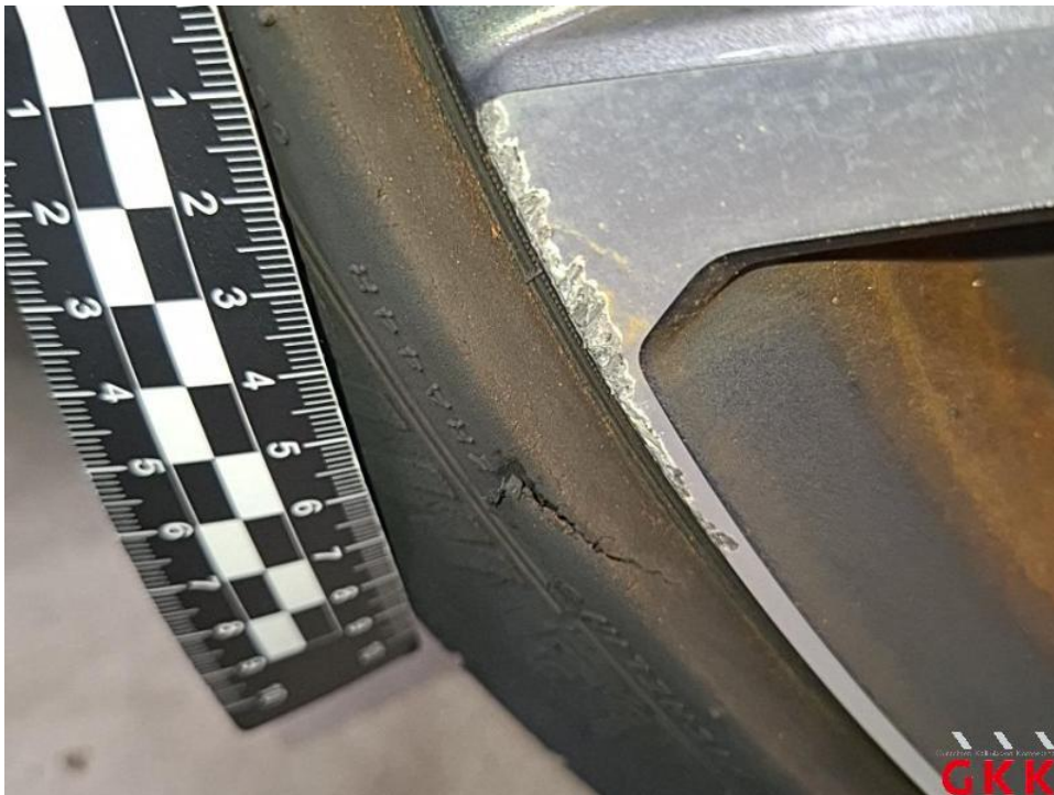
Bild 40. LM-Rad, vorne rechts, Materialabtrag, ersetzen
