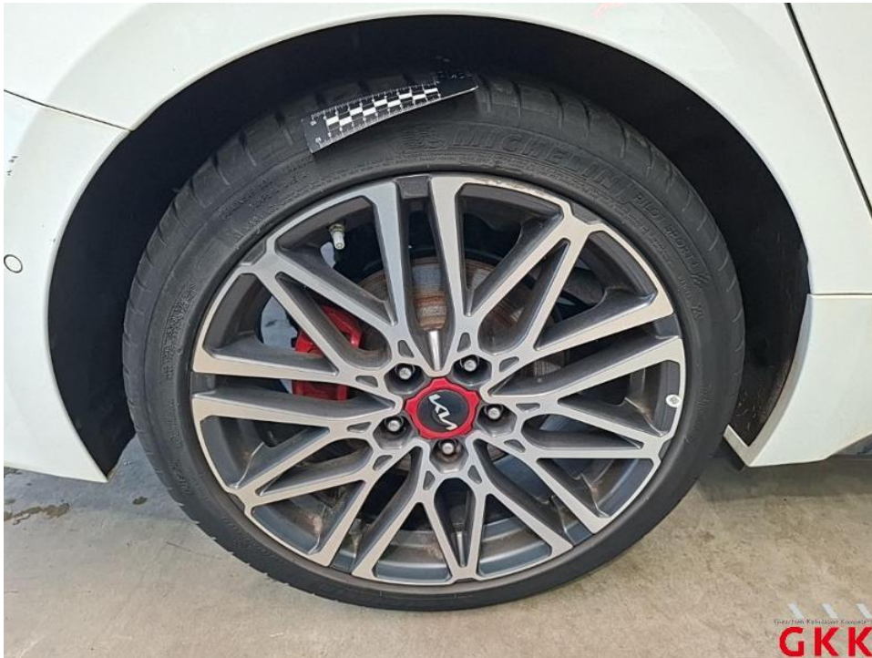
Bild 33. Reifen, hinten rechts, beschädigt, ersetzen
