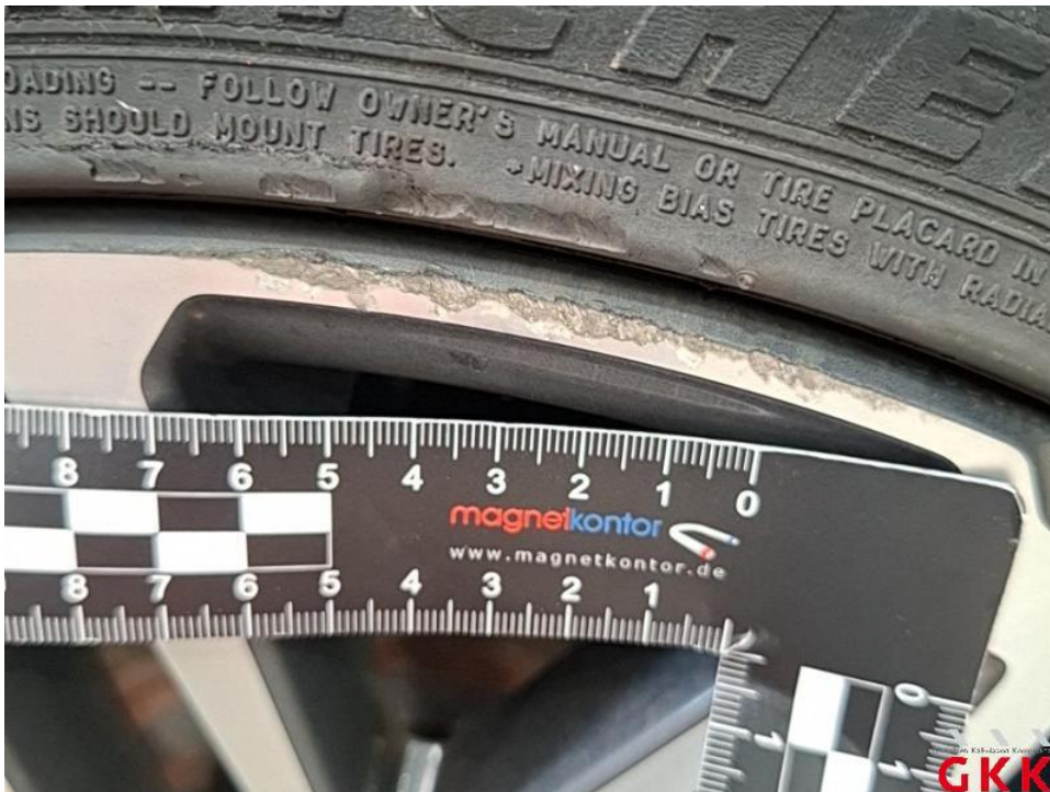
Bild 32. LM-Rad, hinten rechts, Materialabtrag, ersetzen
