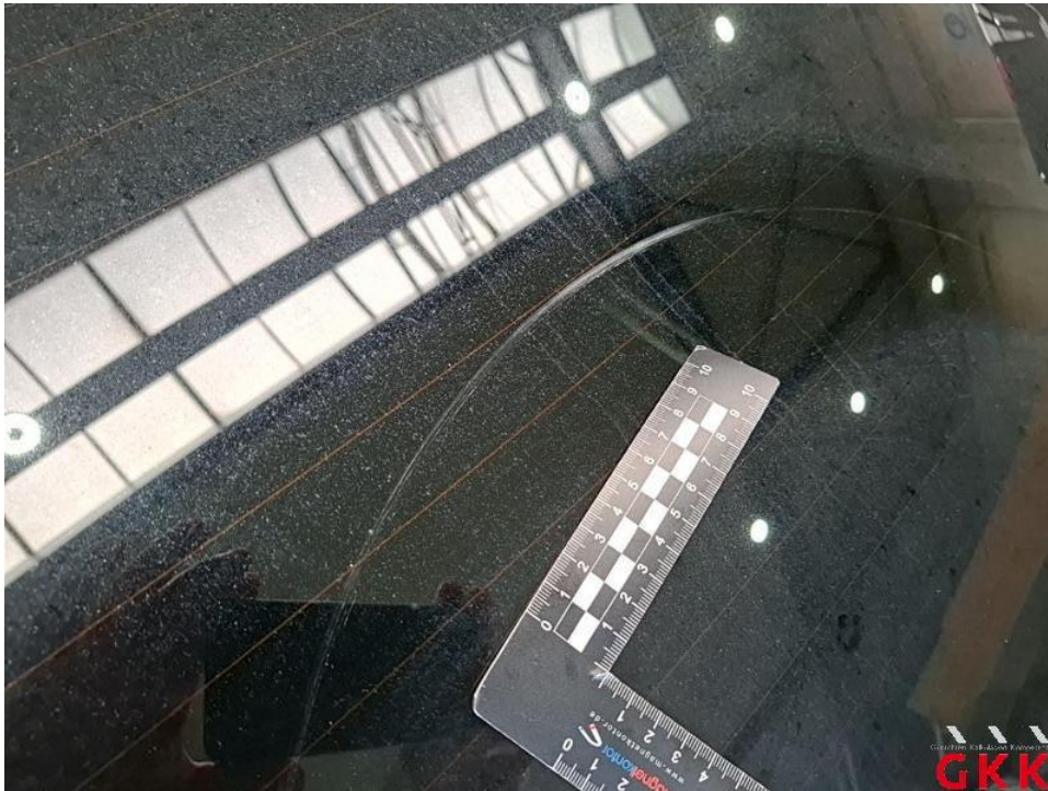
Bild 19. Heckscheibe, getönt, verkratzt, ersetzen
