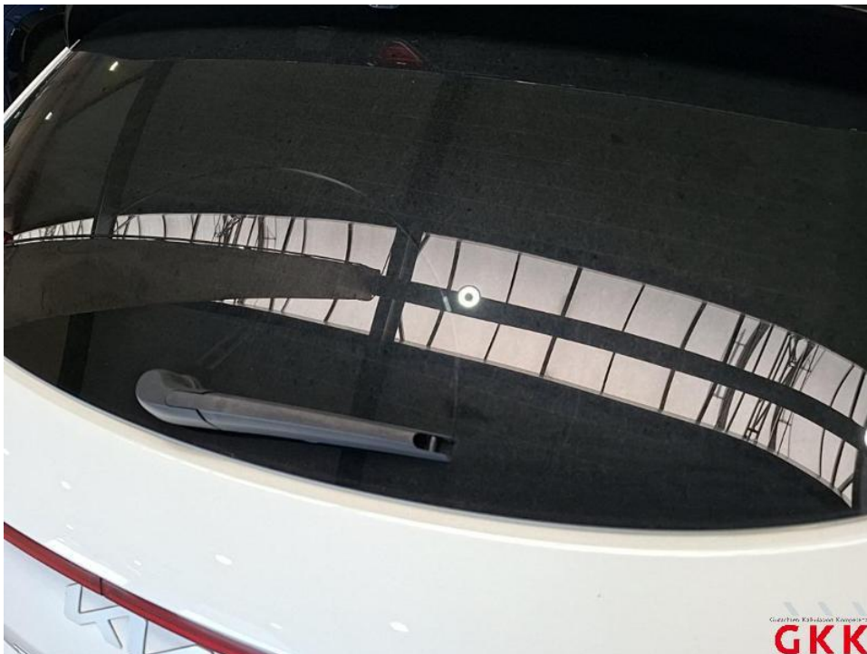
Bild 18. Heckscheibe, getönt, verkratzt, ersetzen
