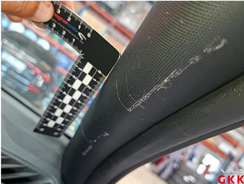
Bild 45. A- Säule rechts, Innenverkleidung, verkratzt, ersetzen
