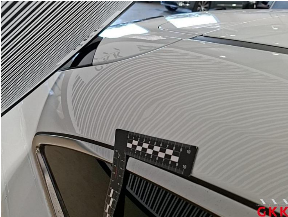
Bild 43. Dach, Holm rechts, beschädigt, kalt drücken
