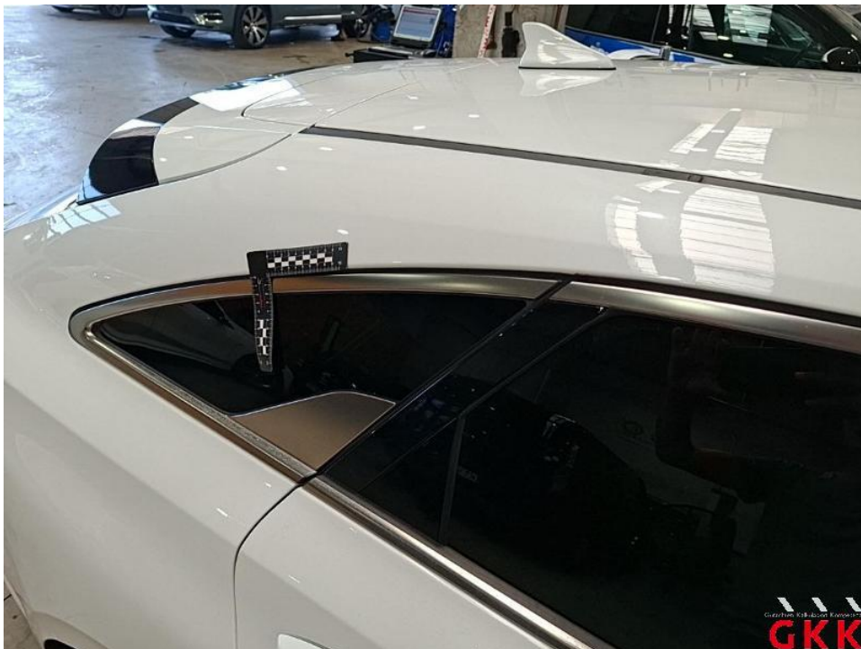
Bild 42. Dach, Holm rechts, beschädigt, kalt drücken
