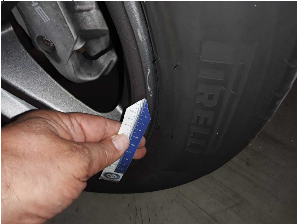
Beschädigung #4: Rad/Reifen: Leichtmetallfelge vorn links (Materialabrieb) - verkratzt / verschürft - erneuern
