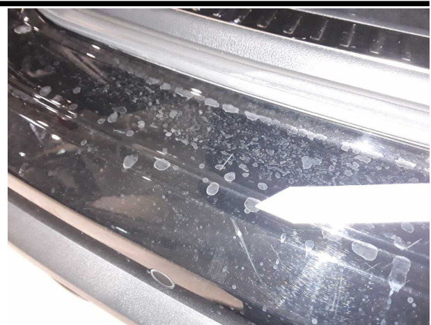
Beschädigung #2: Stossfänger hinten: Stossfänger hinten - Kratzer - lackieren
