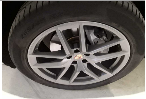
Beschädigung #4: Rad/Reifen: Leichtmetallfelge vorn links (Materialabrieb) - verkratzt / verschürft - erneuern
