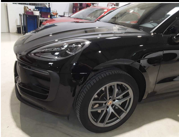
Beschädigung #4: Rad/Reifen: Leichtmetallfelge vorn links (Materialabrieb) - verkratzt / verschürft - erneuern
