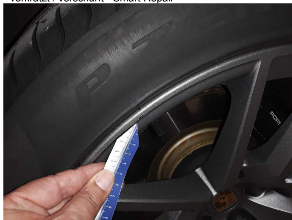
Beschädigung #1: Rad/Reifen: Leichtmetallfelge hinten rechts - verkratzt / verschürft - Smart Repair
