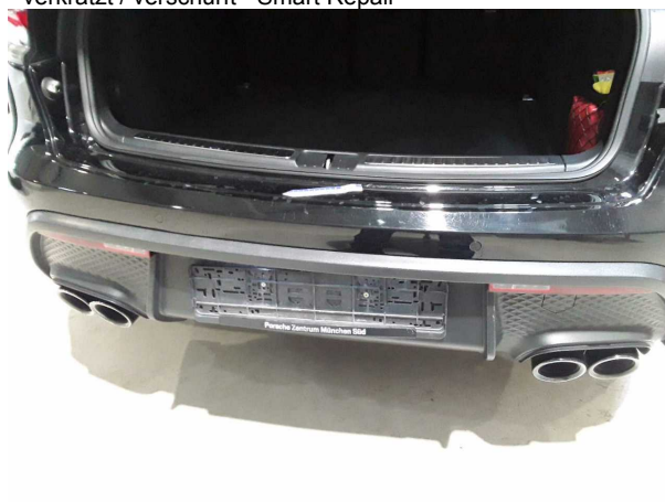
Beschädigung #2: Stossfänger hinten: Stossfänger hinten - Kratzer - lackieren
