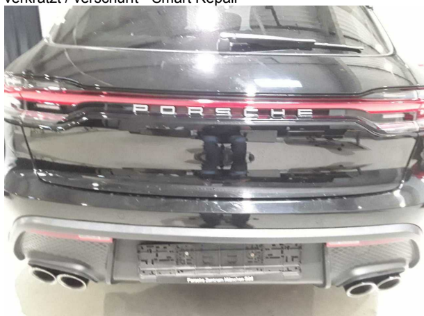
Beschädigung #2: Stossfänger hinten: Stossfänger hinten - Kratzer - lackieren
