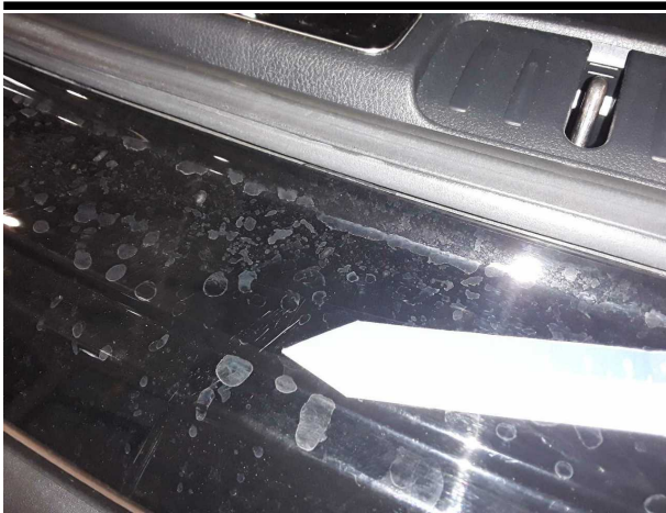
Beschädigung #2: Stossfänger hinten: Stossfänger hinten - Kratzer - lackieren
