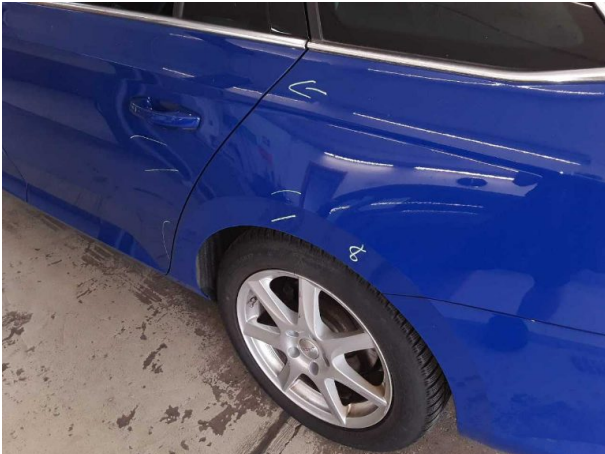
Beschädigung #1: Seitenwand links: Seitenwand - Kratzer - auslegen / polieren
