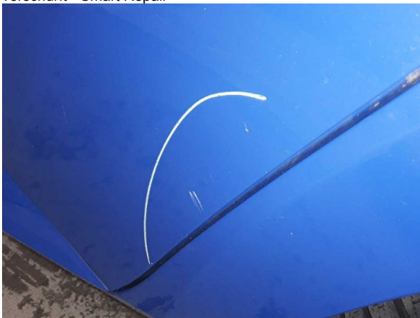
Beschädigung #5: Tür hinten links: Tür - verkratzt / verschürft - instandsetzen und lackieren
