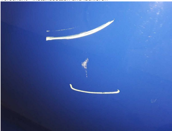
Beschädigung #8: Tür vorn links: Tür - verkratzt / verschürft - instandsetzen und lackieren
