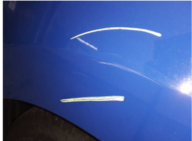
Beschädigung #1: Seitenwand links: Seitenwand - Kratzer - auslegen / polieren
