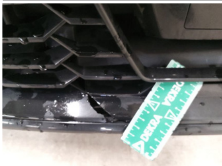
Grille de pare-chocs / Avant / Cassé
