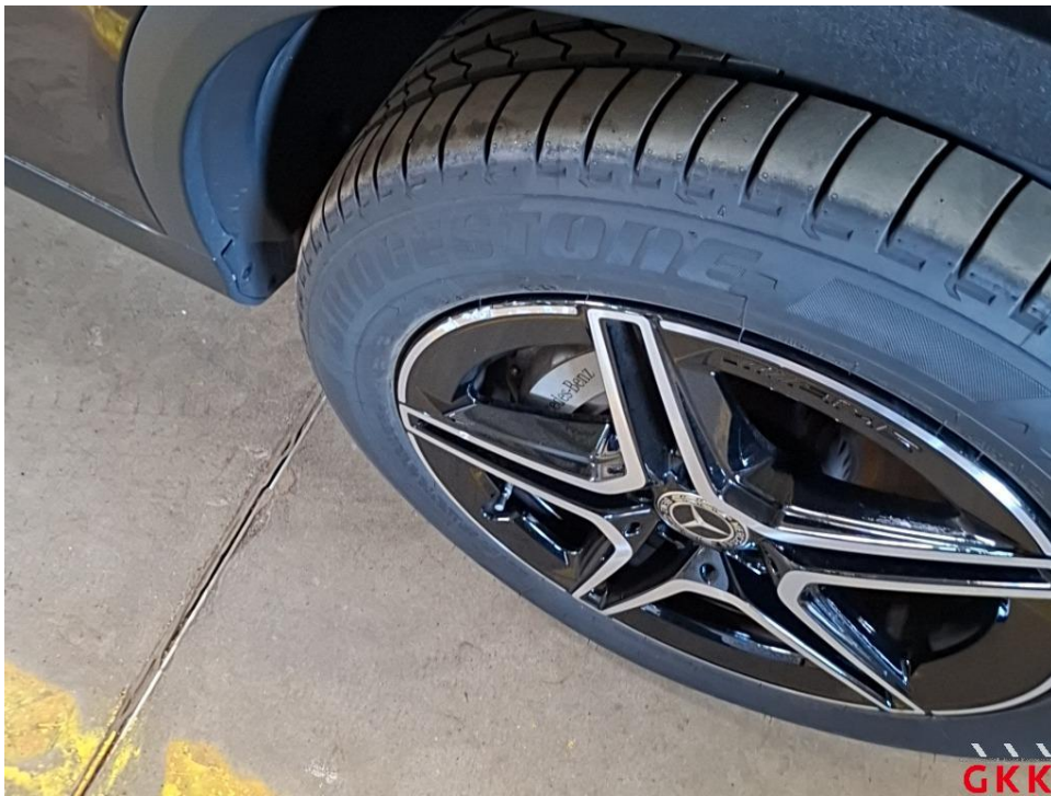
Bild 22 LM-Rad, vorne rechts, Materialabtrag, ersetzen
