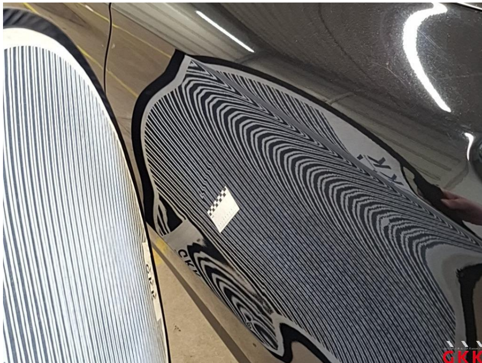
Bild 27 Tür hinten links, beschädigt, instand setzen - lackieren
