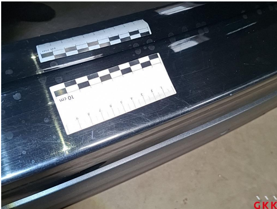
Bild 30 Stoßfänger hinten, Verkleidung oberhalb -lackiert-, verkratzt, lackieren
