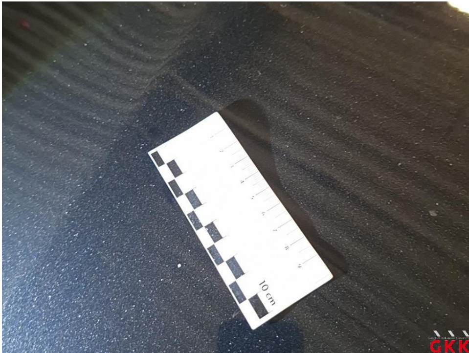
Bild 25 Motorhaube, Steinschlag, lackieren
