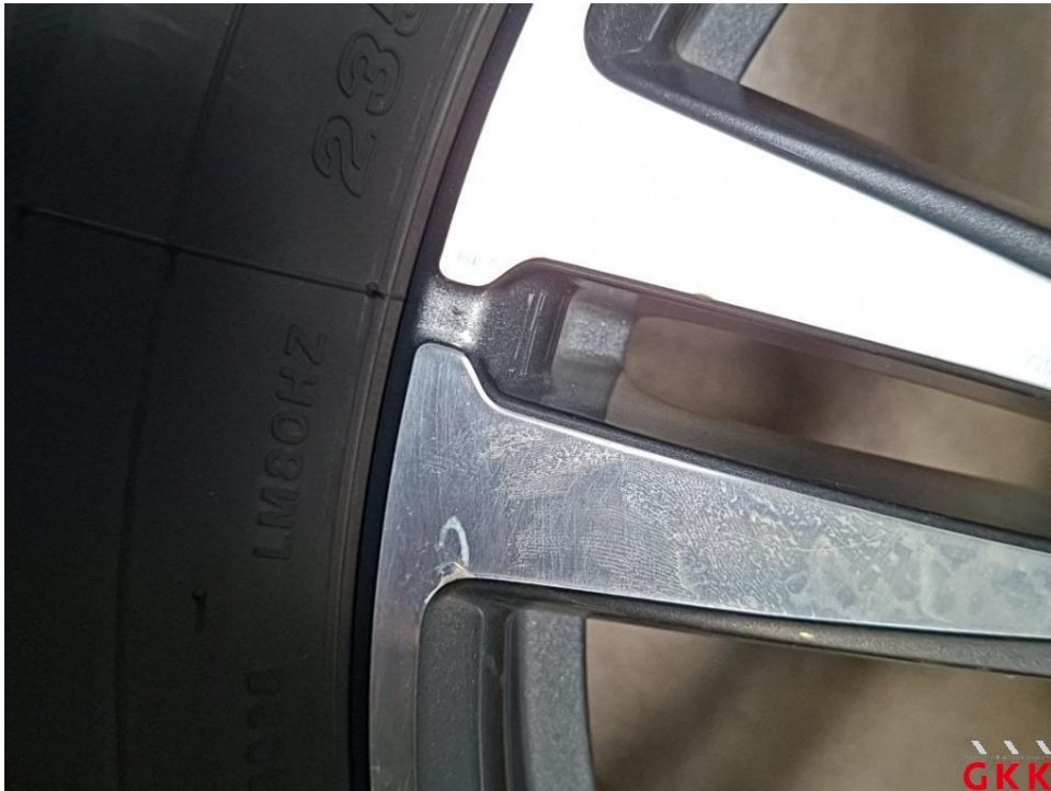
Bild 21 LM-Rad, 4 x beiliegend, beschädigt, aufbereiten
