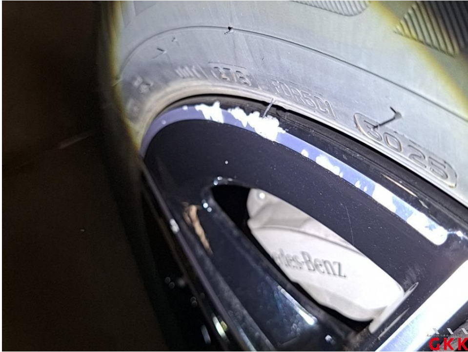
Bild 23 LM-Rad, vorne rechts, Materialabtrag, ersetzen
