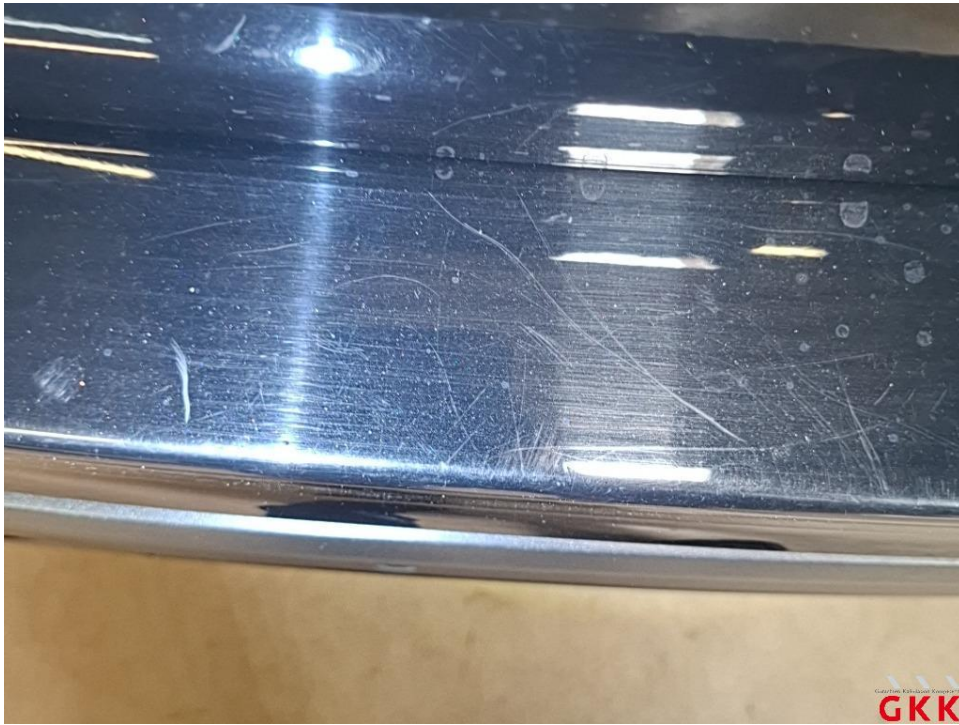
Bild 31 Stoßfänger hinten, Verkleidung oberhalb -lackiert-, verkratzt, lackieren
