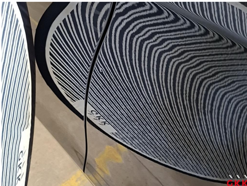
Bild 28 Tür hinten links, beschädigt, instand setzen - lackieren
