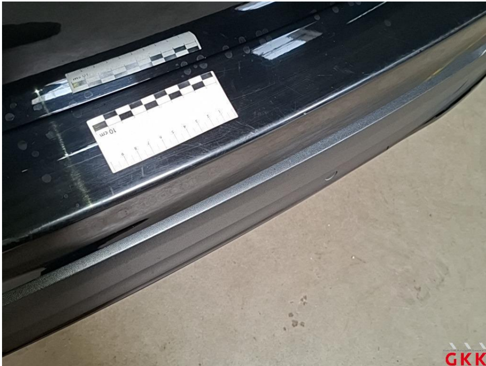
Bild 29 Stoßfänger hinten, Verkleidung oberhalb -lackiert-, verkratzt, lackieren
