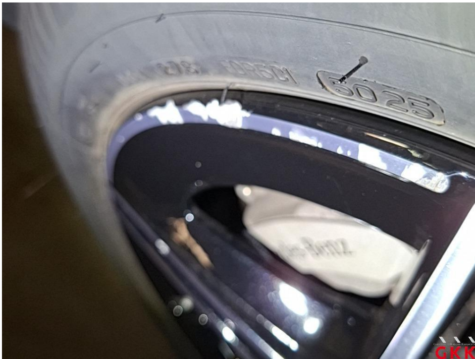
Bild 24 LM-Rad, vorne rechts, Materialabtrag, ersetzen
