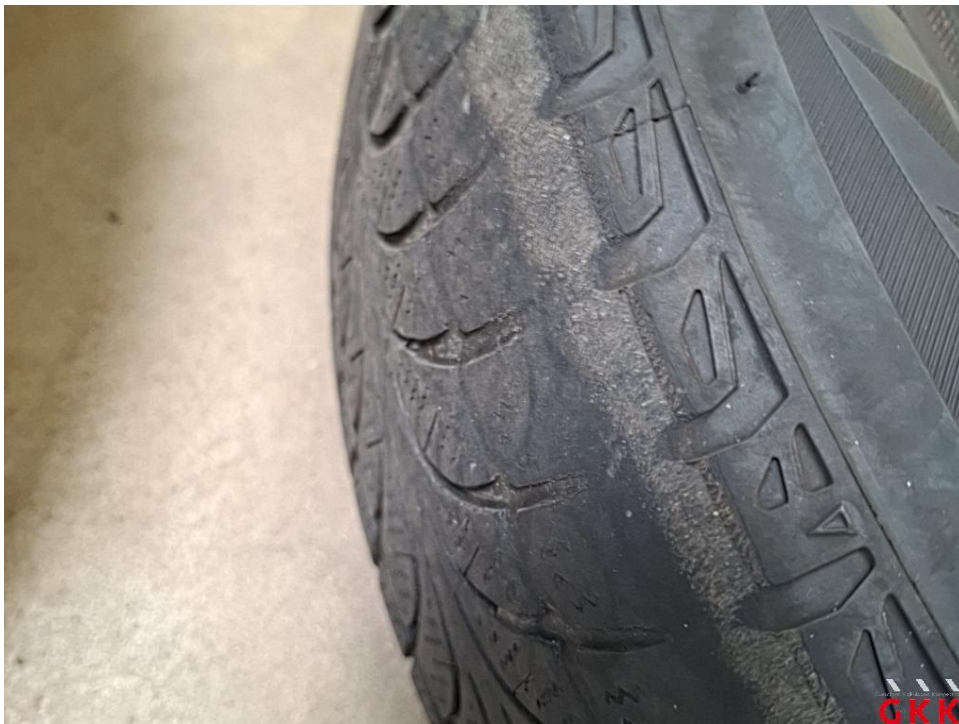
Bild 18 Reifen, 2 x beiliegend, einseitig abgefahren und Untermaß, ersetzen
