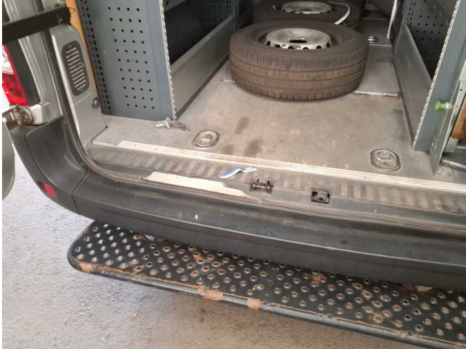
Damage 4: Rear of vehicle: Rear panel (Verkleidung Abschlussblech Innen) - Broken / torn - Replace
