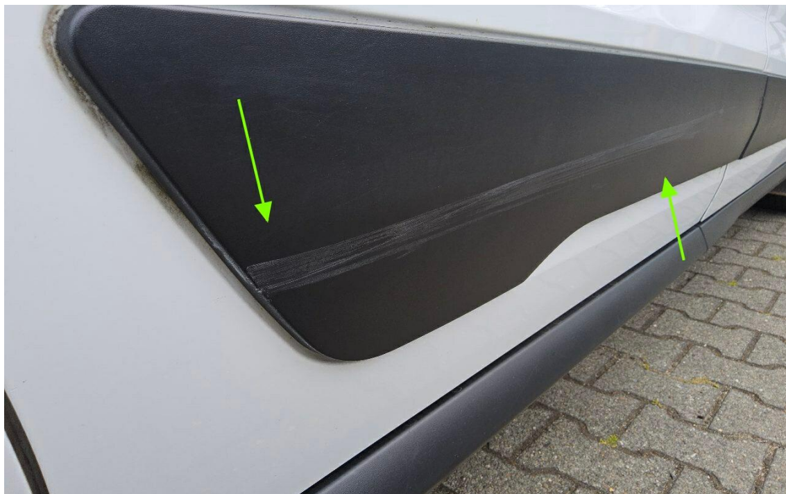
Bild 15 : Schiebetürzierblende rechts, zerkratzt
