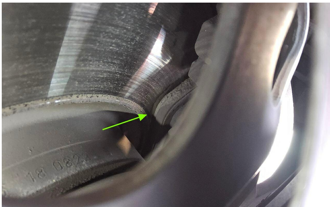
Bild 22 : T- Bremsbeläge vorne, kurz vor Verschleiß
