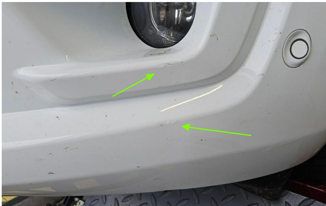
Bild 13 : Stoßfänger vorne Lackierung, zerkratzt, lackieren
