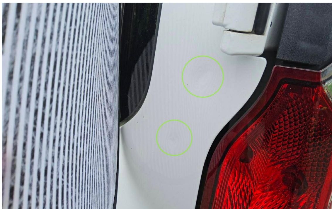
Bild 20 : Heckklappe, eingedellt, drücken
