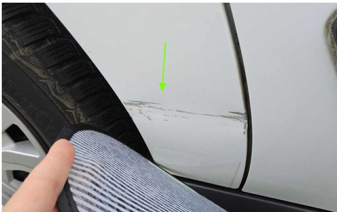
Bild 16 : Seitenteil hinten rechts, eingedellt, instandsetzen und lackieren mit Lackaufbau
