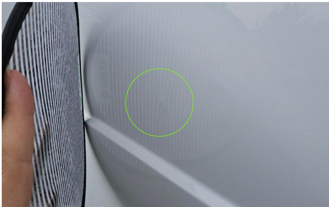
Bild 17 : Seitenteil hinten links, eingedellt, drücken
