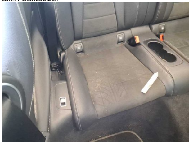
Beschädigung #6: Sitz hinten: Sitzbezug - beschädigt - Wertminderung
