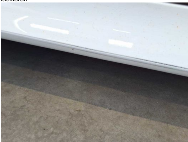
Beschädigung #10: Schweller rechts: Verkleidung - Kratzer - lackieren
