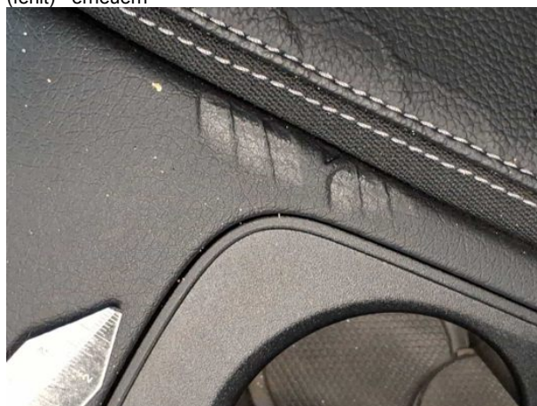
Beschädigung #4: Instrumententafel: Mittelkonsole hinten (Becherhalter) - beschädigt - Wertminderung
