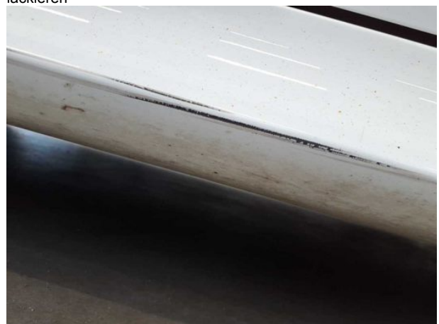
Beschädigung #10: Schweller rechts: Verkleidung - Kratzer - lackieren
