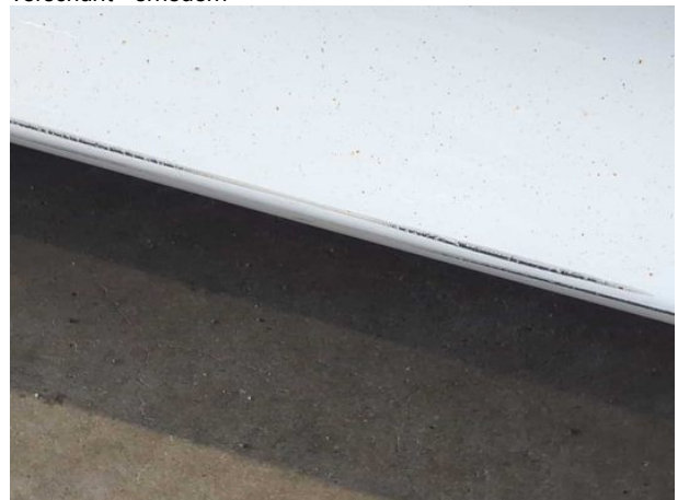
Beschädigung #10: Schweller rechts: Verkleidung - Kratzer - lackieren
