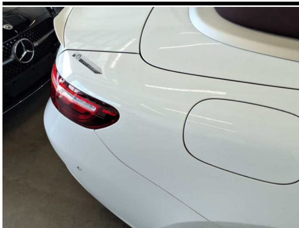
Beschädigung #5: Seitenwand rechts: Seitenwand - Delle(n) - sanft instandsetzen
