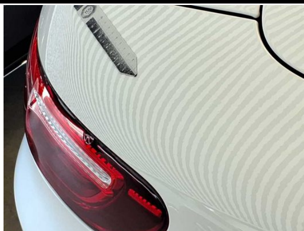
Beschädigung #5: Seitenwand rechts: Seitenwand - Delle(n) - sanft instandsetzen
