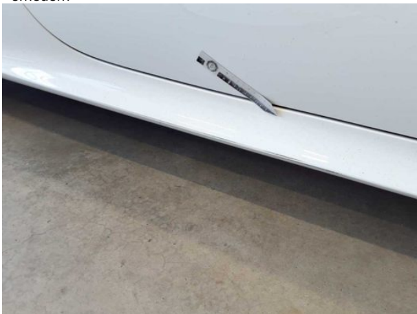
Beschädigung #10: Schweller rechts: Verkleidung - Kratzer - lackieren
