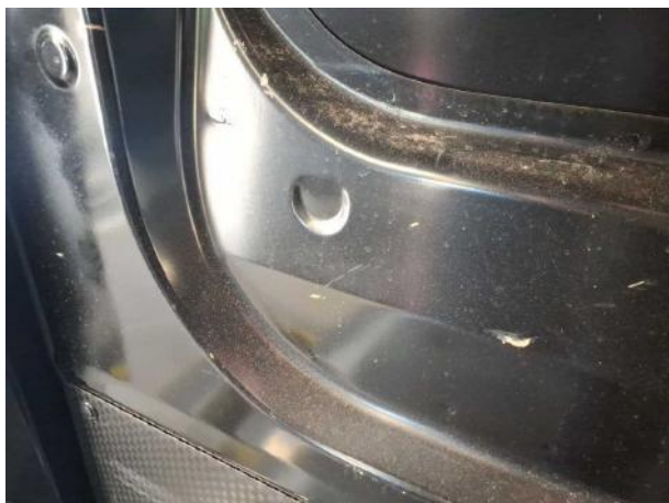
Beschädigung #8: Interieur: Laderraumunterteilung - Delle / Lackschaden - Wertminderung
