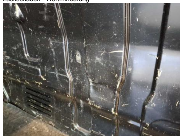
Beschädigung #8: Interieur: Laderraumunterteilung - Delle / Lackschaden - Wertminderung
