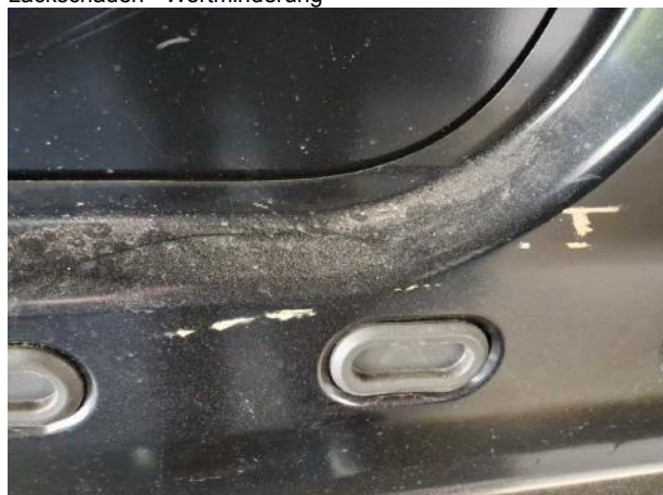
Beschädigung #8: Interieur: Laderaumunterteilung - Delle / Lackschaden - Wertminderung
