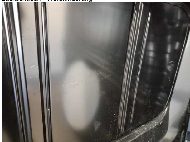
Beschädigung #8: Interieur: Laderraumunterteilung - Delle / Lackschaden - Wertminderung
