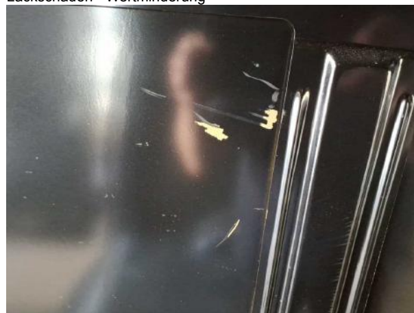
Beschädigung #8: Interieur: Laderaumunterteilung - Delle / Lackschaden - Wertminderung
