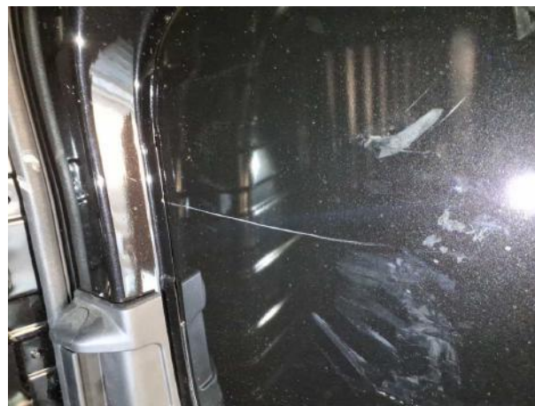
Beschädigung #8: Interieur: Laderraumunterteilung - Delle / Lackschaden - Wertminderung
