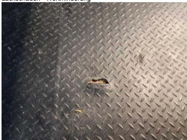
Beschädigung #8: Interieur: Laderraumunterteilung - Delle / Lackschaden - Wertminderung
