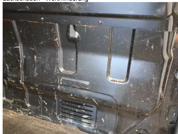
Beschädigung #8: Interieur: Laderraumunterteilung - Delle / Lackschaden - Wertminderung
