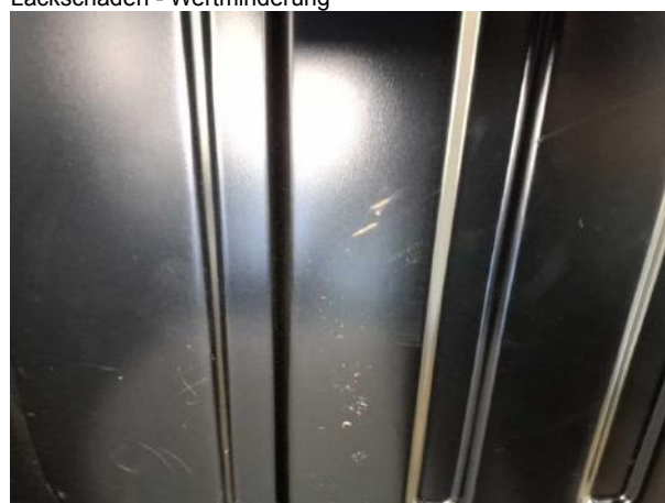
Beschädigung #8: Interieur: Laderraumunterteilung - Delle / Lackschaden - Wertminderung
