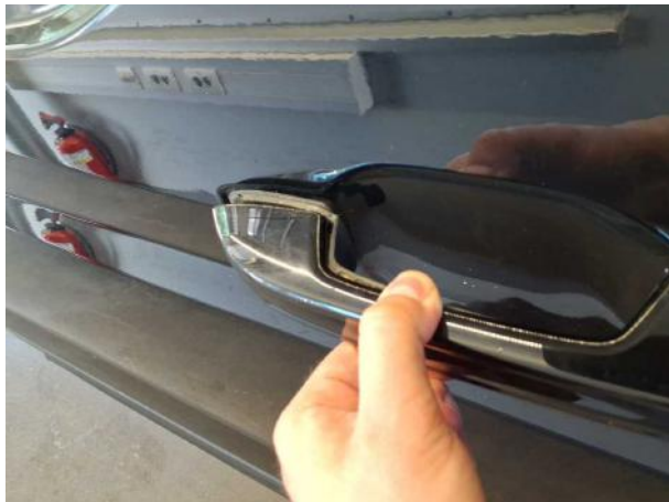
Beschädigung #1: Tür hinten rechts: Griff außen - lose - instandsetzen
