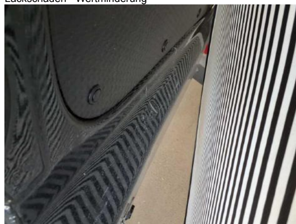
Beschädigung #8: Interieur: Laderraumunterteilung - Delle / Lackschaden - Wertminderung
