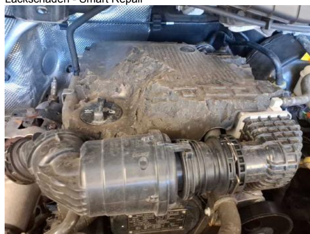
Beschädigung #4: Motor: Motorabdeckung - Marderschaden - erneuern
