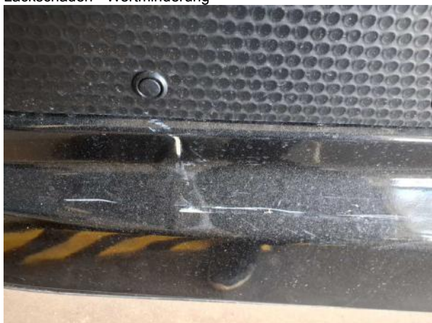
Beschädigung #8: Interieur: Laderraumunterteilung - Delle / Lackschaden - Wertminderung
