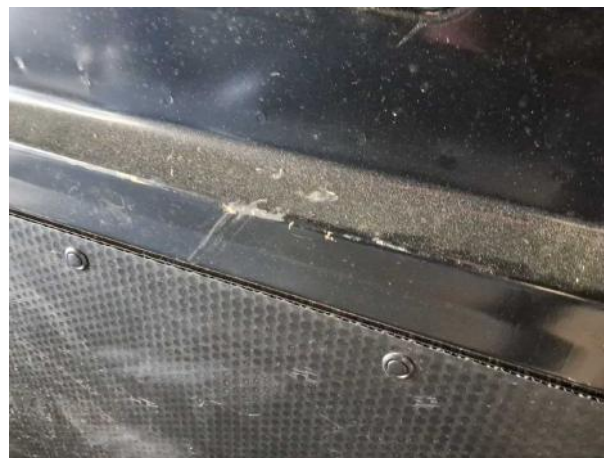
Beschädigung #8: Interieur: Laderaumunterteilung - Delle / Lackschaden - Wertminderung
