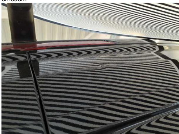
Beschädigung #5: Heckklappe/-tür: Hecktür rechts - Delle / Lackschaden - Smart Repair
