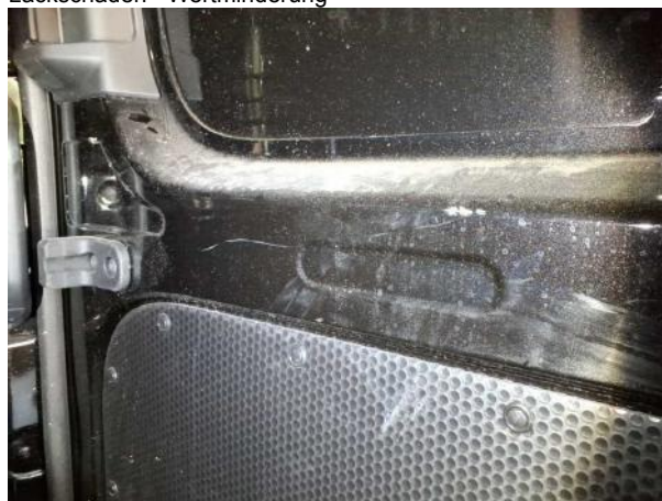
Beschädigung #8: Interieur: Laderaumunterteilung - Delle / Lackschaden - Wertminderung
