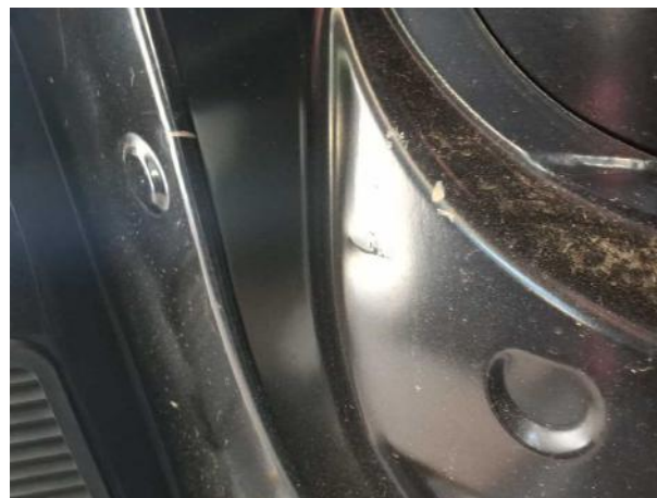
Beschädigung #8: Interieur: Laderraumunterteilung - Delle / Lackschaden - Wertminderung
