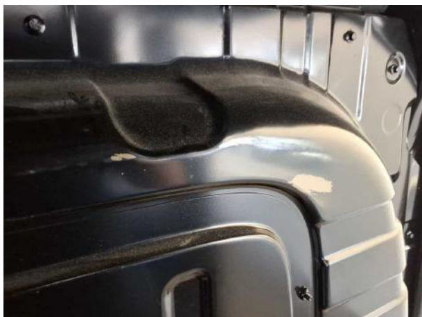
Beschädigung #8: Interieur: Laderraumunterteilung - Delle / Lackschaden - Wertminderung
