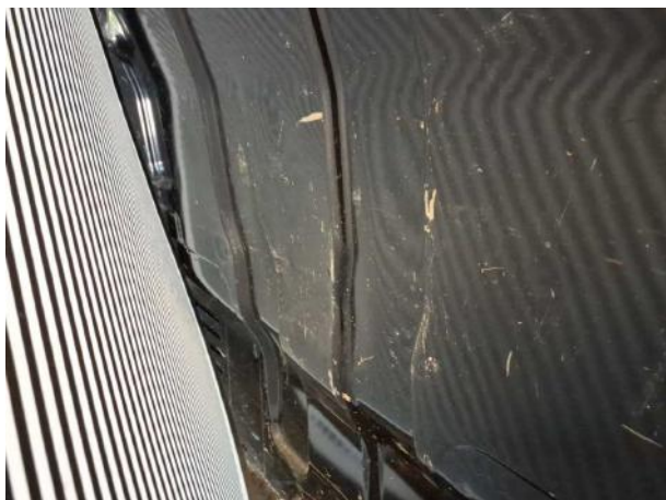
Beschädigung #8: Interieur: Laderraumunterteilung - Delle / Lackschaden - Wertminderung
