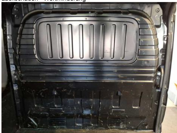
Beschädigung #8: Interieur: Laderaumunterteilung - Delle / Lackschaden - Wertminderung
