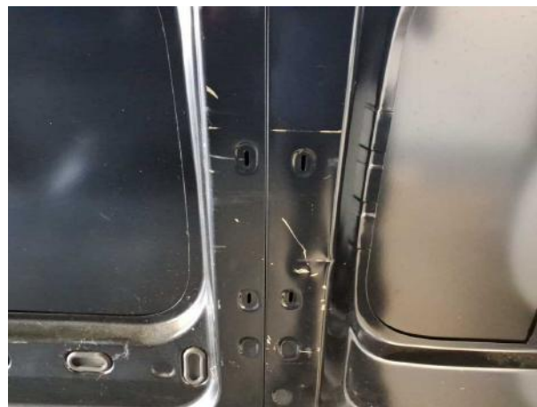
Beschädigung #8: Interieur: Laderraumunterteilung - Delle / Lackschaden - Wertminderung
