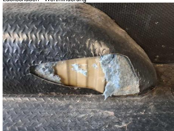
Beschädigung #8: Interieur: Laderraumunterteilung - Delle / Lackschaden - Wertminderung
