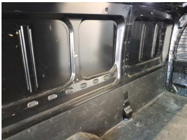
Beschädigung #8: Interieur: Laderraumunterteilung - Delle / Lackschaden - Wertminderung
