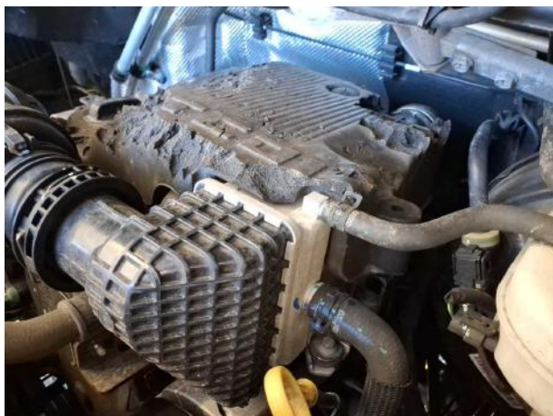
Beschädigung #4: Motor: Motorabdeckung - Marderschaden - erneuern
