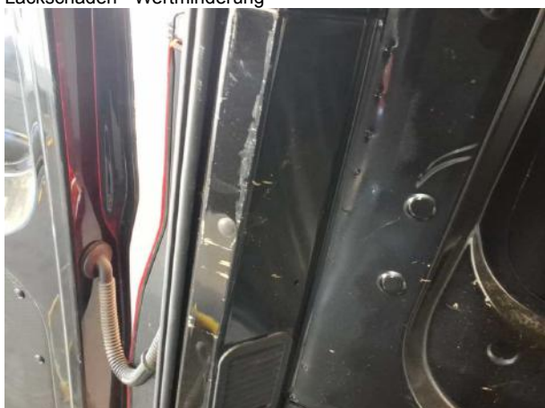
Beschädigung #8: Interieur: Laderraumunterteilung - Delle / Lackschaden - Wertminderung
