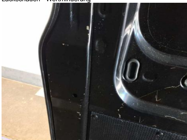
Beschädigung #8: Interieur: Laderraumunterteilung - Delle / Lackschaden - Wertminderung
