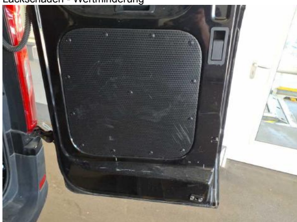
Beschädigung #8: Interieur: Laderraumunterteilung - Delle / Lackschaden - Wertminderung
