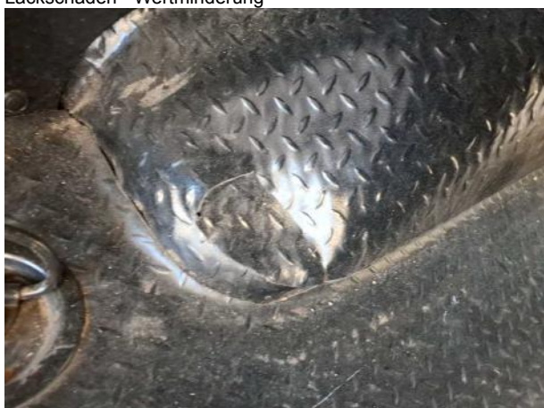
Beschädigung #8: Interieur: Laderraumunterteilung - Delle / Lackschaden - Wertminderung
