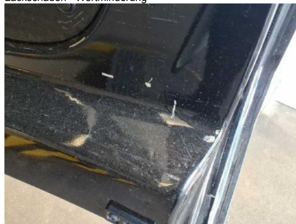
Beschädigung #8: Interieur: Laderraumunterteilung - Delle / Lackschaden - Wertminderung
