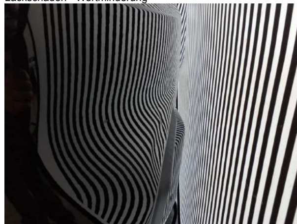
Beschädigung #9: Stossfänger vorn: Stossfänger vorn - verformt - erneuern
