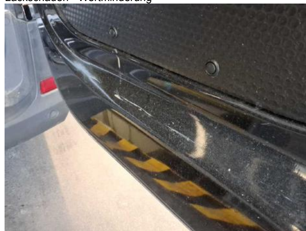
Beschädigung #8: Interieur: Laderraumunterteilung - Delle / Lackschaden - Wertminderung
