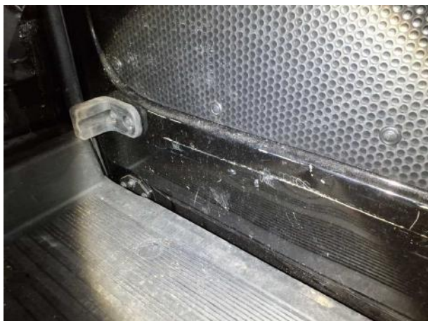
Beschädigung #8: Interieur: Laderraumunterteilung - Delle / Lackschaden - Wertminderung
