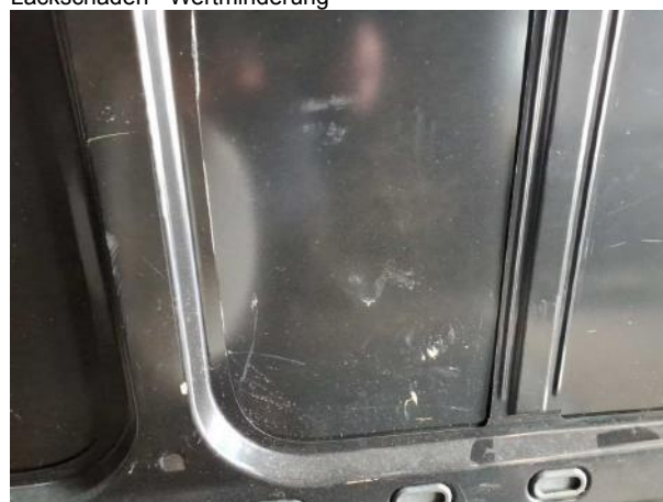
Beschädigung #8: Interieur: Laderraumunterteilung - Delle / Lackschaden - Wertminderung
