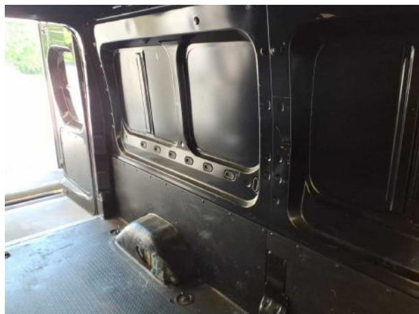
Beschädigung #8: Interieur: Laderaumunterteilung - Delle / Lackschaden - Wertminderung
