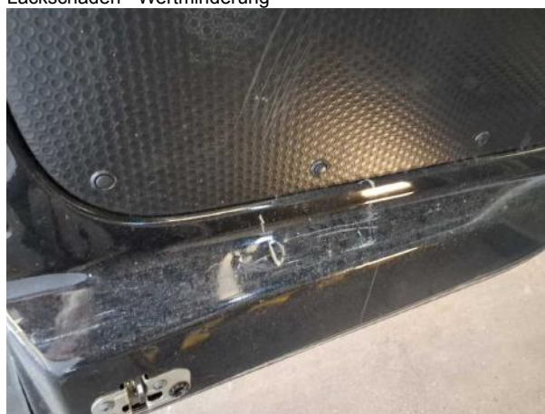
Beschädigung #8: Interieur: Laderaumunterteilung - Delle / Lackschaden - Wertminderung
