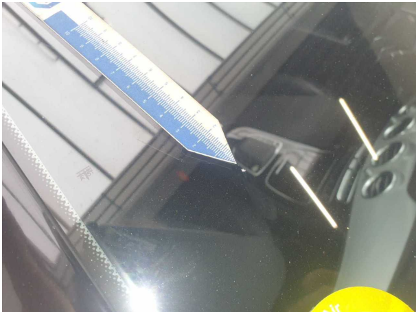
Beschädigung #4: Verglasung: Frontscheibe - Steinschlag - erneuern
