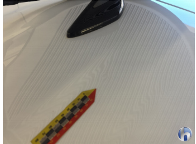
3. Dach 1 Delle - Sanft Instandsetzen
