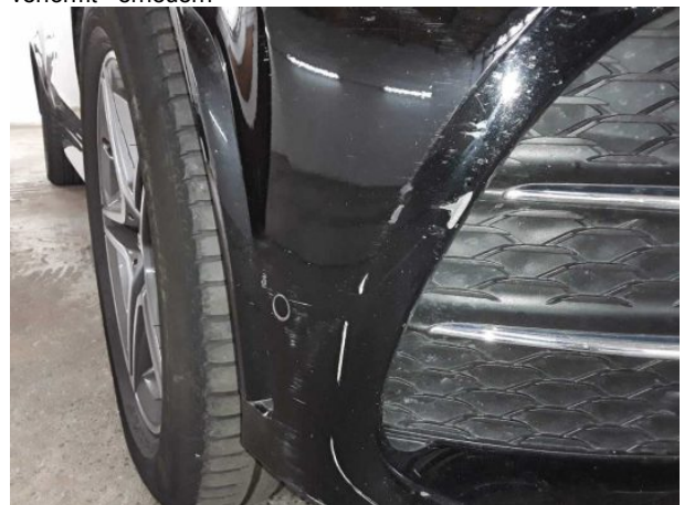
Beschädigung #18: Stossfänger vorn: Stossfänger vorn - verformt - erneuern
