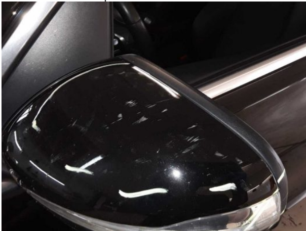
Beschädigung #11: Außenspiegel links: Abdeckkappe - verkratzt / verschürft - Smart Repair
