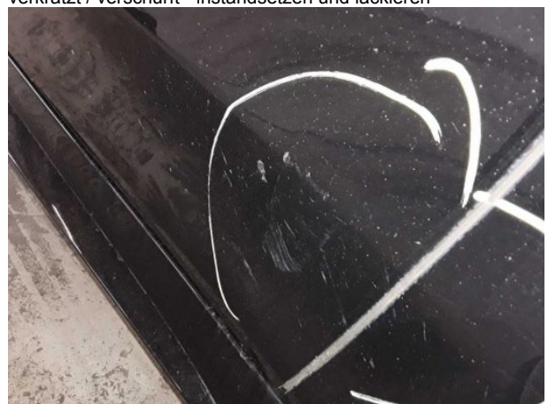
Beschädigung #16: Tür vorn rechts: Tür - Delle / Lackschaden - instandsetzen und lackieren
