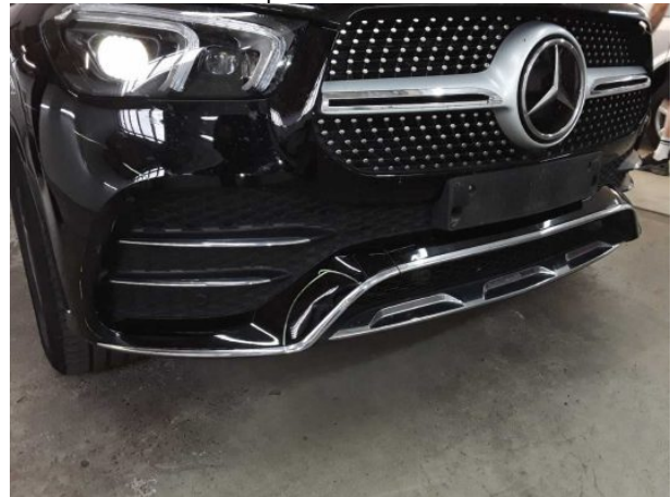
Beschädigung #14: Stossfänger vorn: Spoiler - verkratzt / verschürft - erneuern
