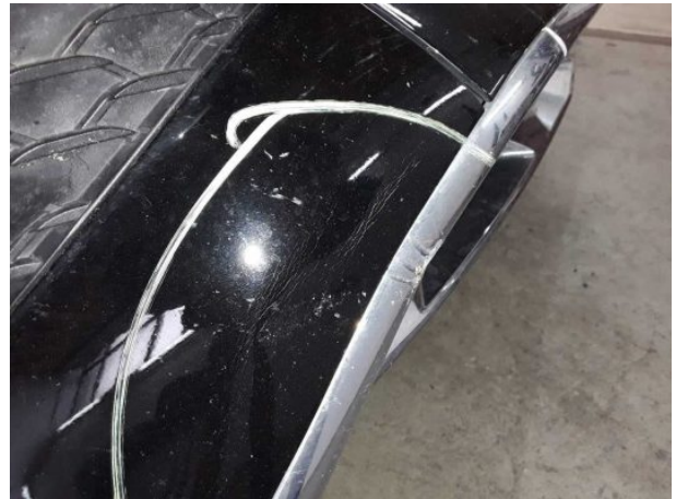
Beschädigung #18: Stossfänger vorn: Stossfänger vorn - verformt - erneuern
