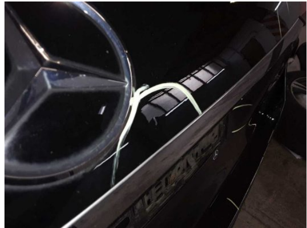
Beschädigung #17: Heckklappe/-tür: Heckklappe - Delle / Lackschaden - instandsetzen und lackieren
