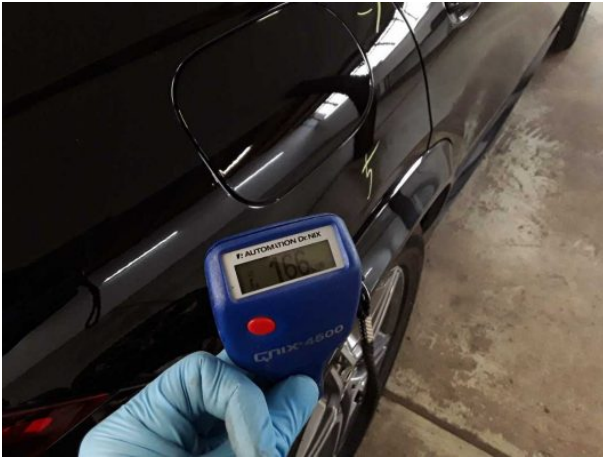
Nachlackierung 1: Seitenwand rechts
