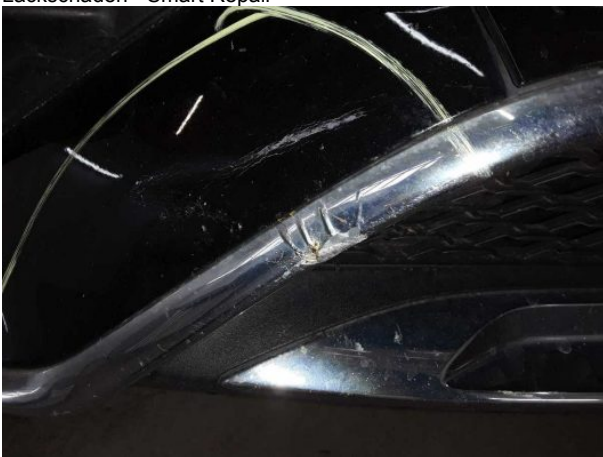
Beschädigung #14: Stossfänger vorn: Spoiler - verkratzt / verschürft - erneuern
