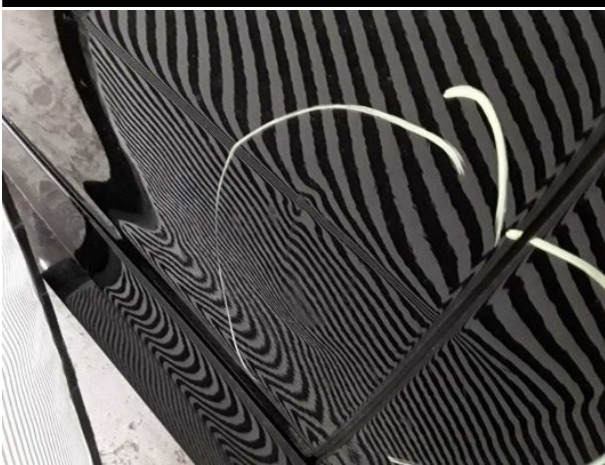
Beschädigung #16: Tür vorn rechts: Tür - Delle / Lackschaden - instandsetzen und lackieren
