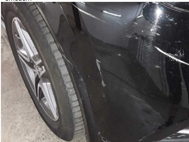
Beschädigung #18: Stossfänger vorn: Stossfänger vorn - verformt - erneuern
