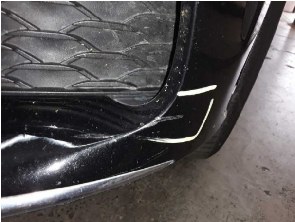
Beschädigung #18: Stossfänger vorn: Stossfänger vorn - verformt - erneuern
