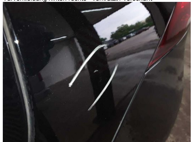
Beschädigung #9: Seitenwand links: Seitenwand - Kratzer - Smart Repair
