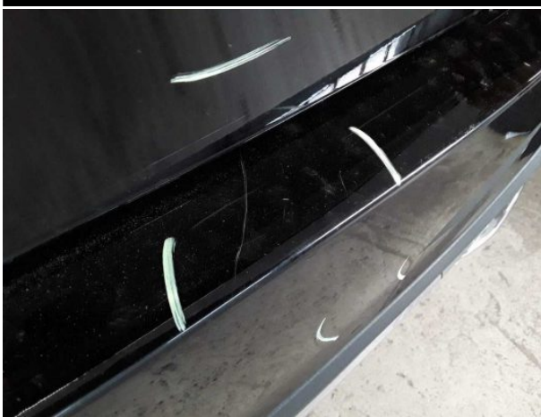
Beschädigung #15: Stossfänger hinten: Stossfänger hinten - verkratzt / verschürft - instandsetzen und lackieren
