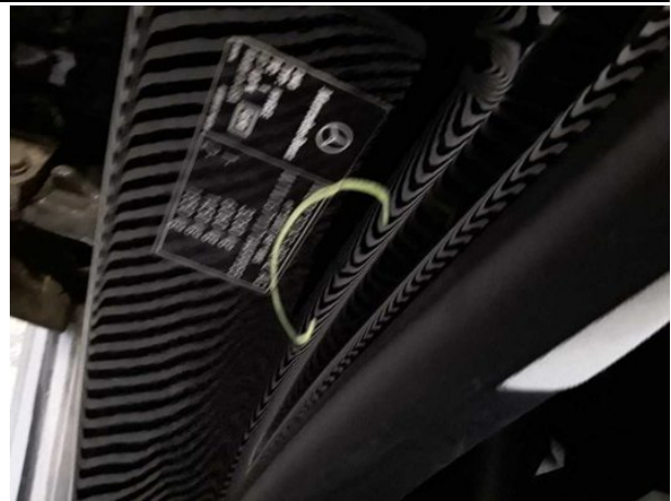
Beschädigung #7: Schweller rechts: Einstieg - Delle(n) - sanft instandsetzen
