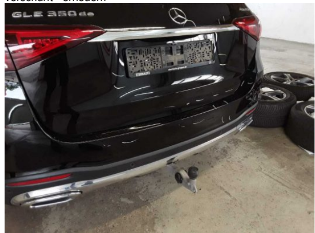
Beschädigung #15: Stossfänger hinten: Stossfänger hinten - verkratzt / verschürft - instandsetzen und lackieren
