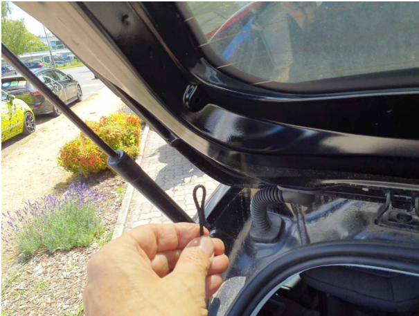
Beschädigung #1: Interieur: Hutablage (Halterung links) - beschädigt - erneuern
