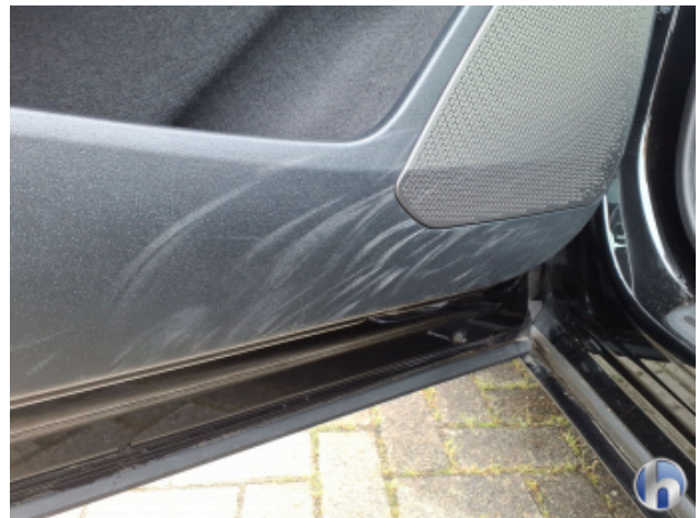
1. Verkleidung Verschmutzt - Reinigen
