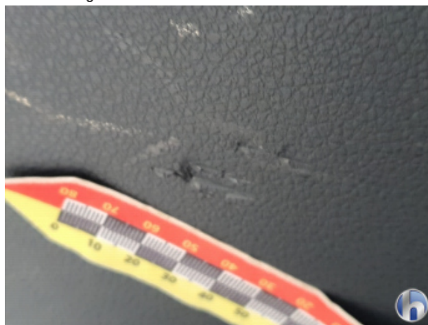
8. Heckdeckelverkleidung Beschädigt - Erneuern
