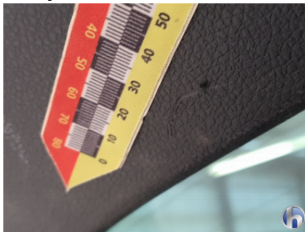
8. Heckdeckelverkleidung Beschädigt - Erneuern
