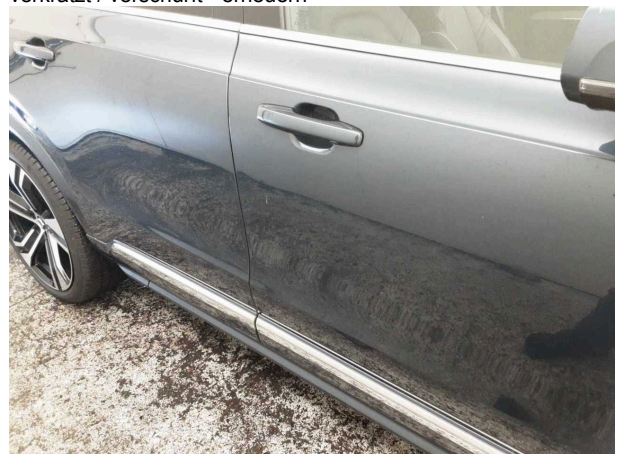
Beschädigung #4: Tür vorn rechts: Tür - Kratzer - lackieren
