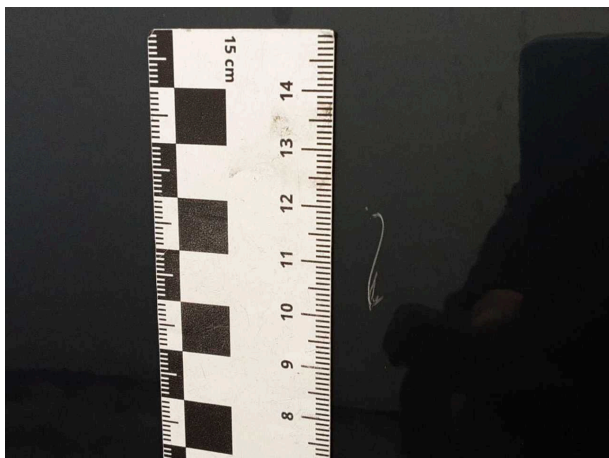
Beschädigung #4: Tür vorn rechts: Tür - Kratzer - lackieren
