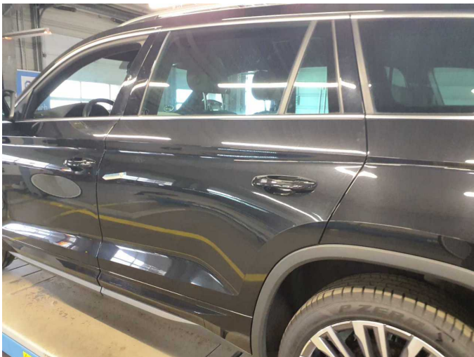
Damage 4: Door - rear left side: Door (erhöhter Aufbereitungsaufwand (schleifen/ polieren)) - Scratch(es) - Smart repair
