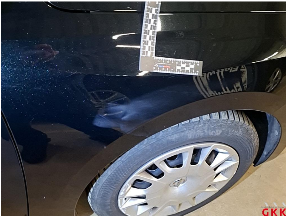
Bild 18 Kotflügel vorne rechts, verkratzt, lackieren
