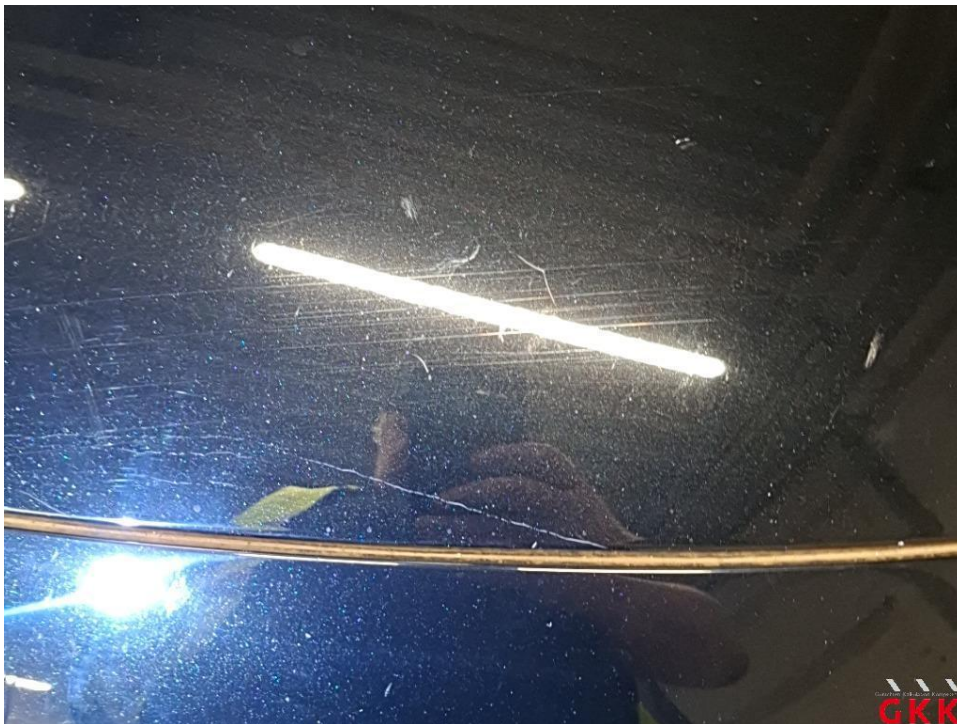
Bild 26 Motorhaube, Steinschlag und Kratzer, lackieren
