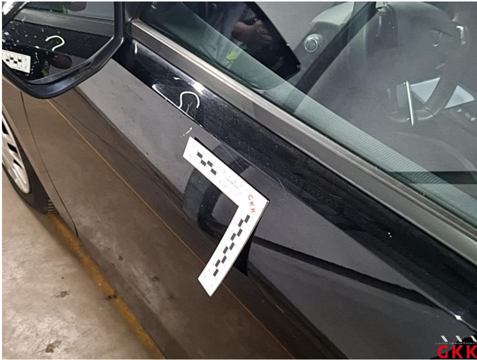
Bild 35 Tür vorne links, verkratzt, lackieren
