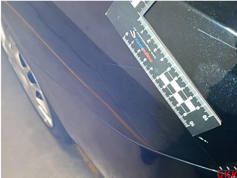
Bild 41 Seitenwand links, verkratzt, lackieren
