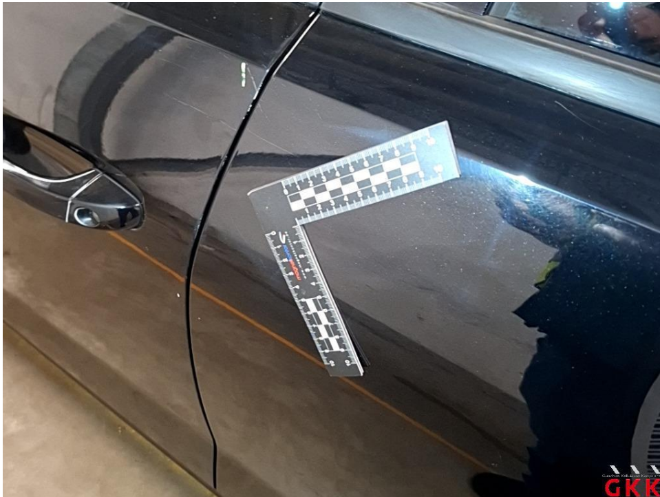
Bild 37 Tür hinten links, verkratzt, lackieren
