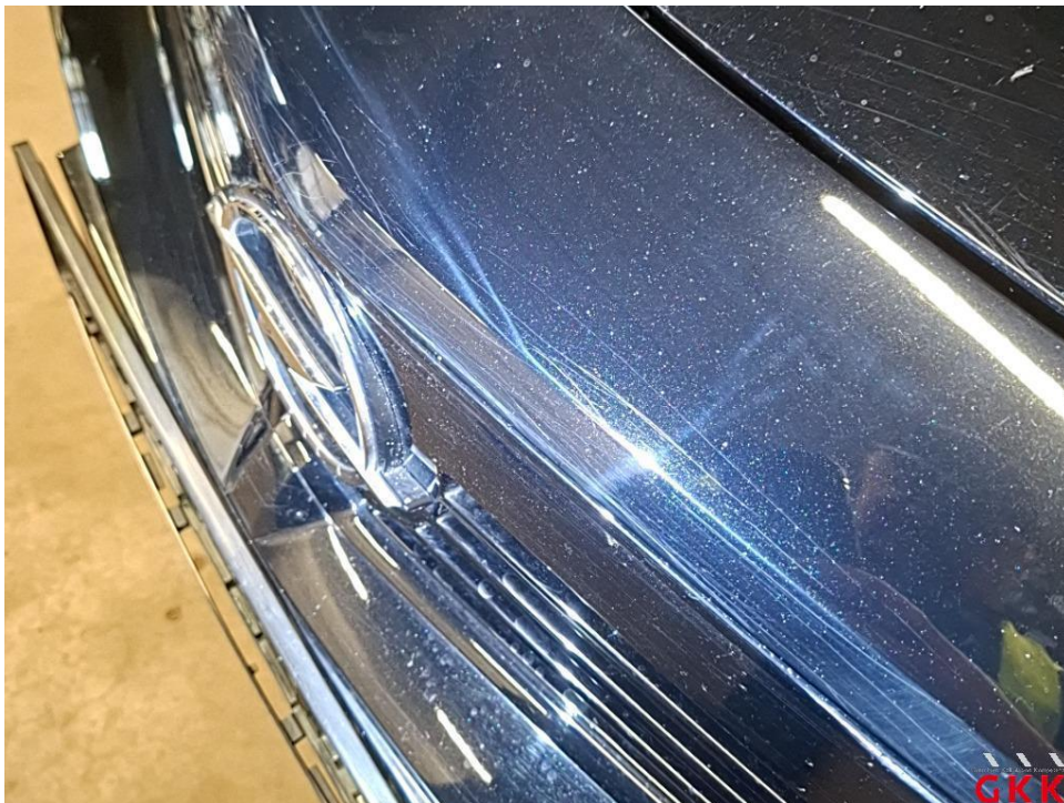
Bild 28 Frontgrill, lackiert, verkratzt, lackieren
