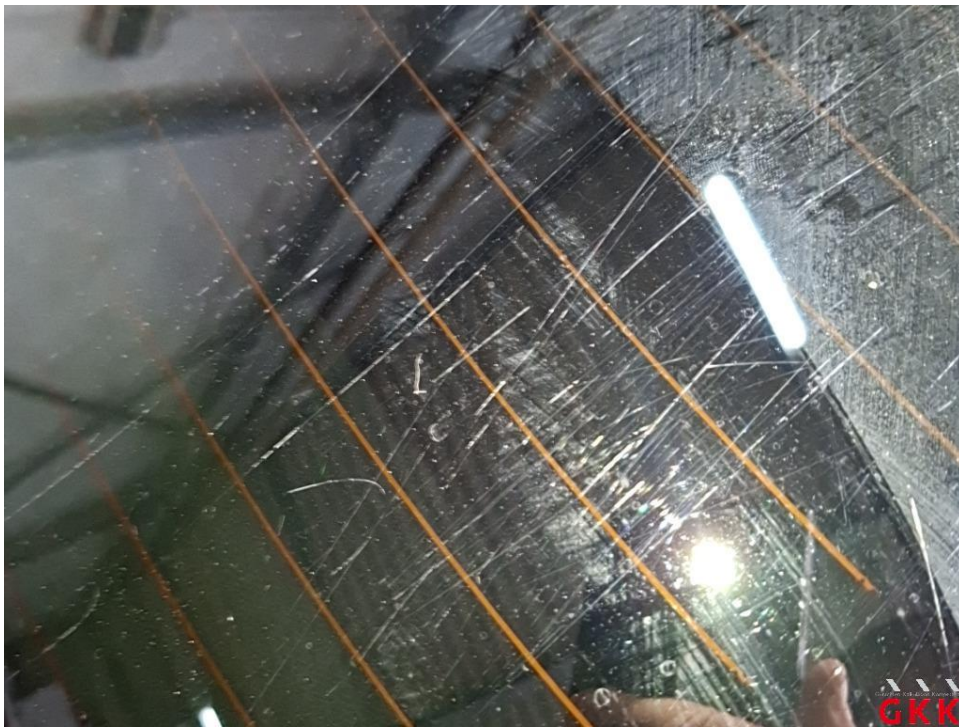
Bild 42 Heckscheibe, verkratzt, ersetzen
