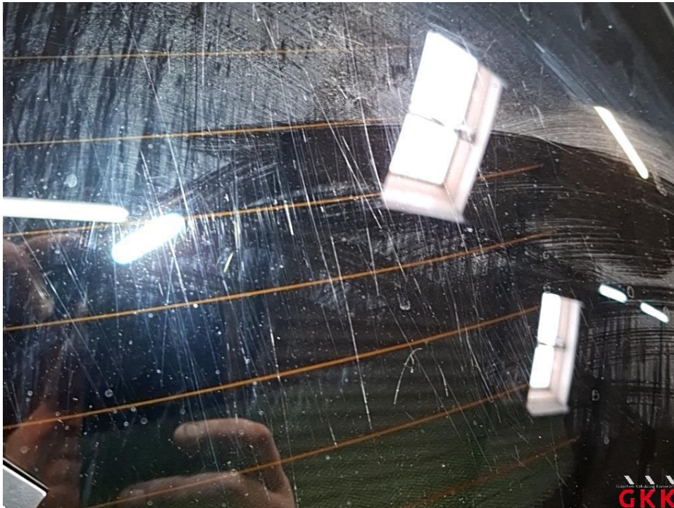
Bild 43 Heckscheibe, verkratzt, ersetzen
