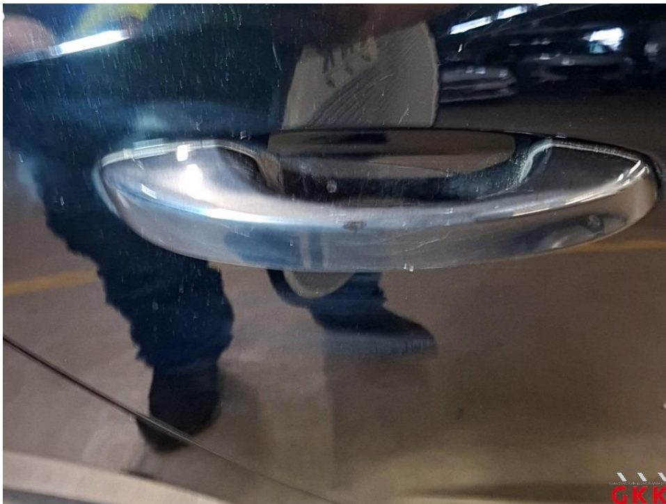
Bild 50 Tür hinten rechts, Griff, verkratzt, lackieren
