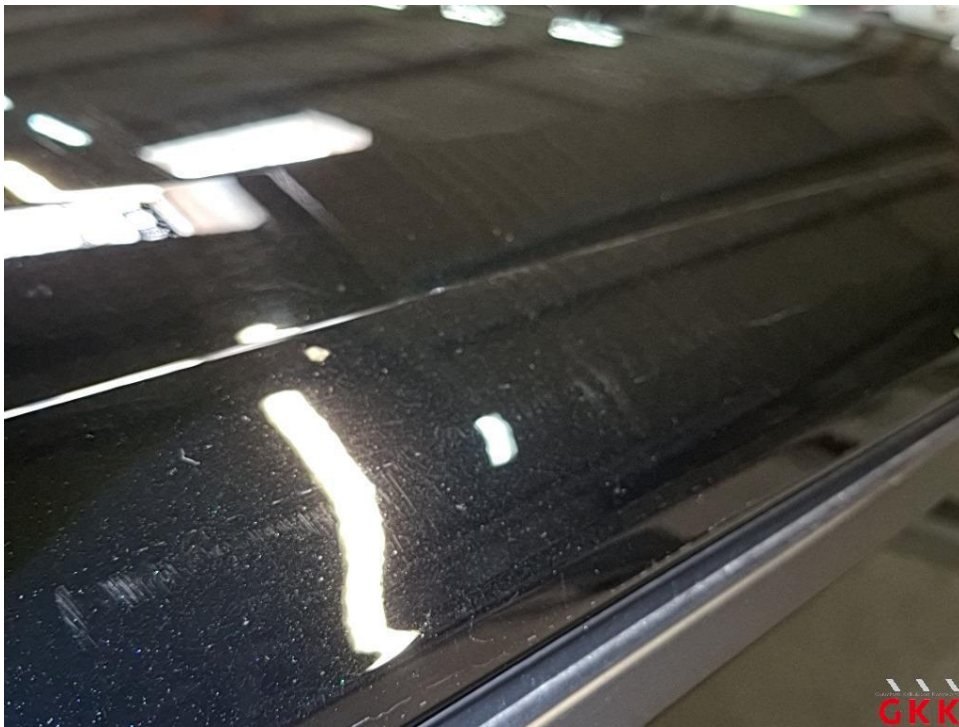
Bild 32 Fahrzeug, außen, verkratzt, aufbereiten
