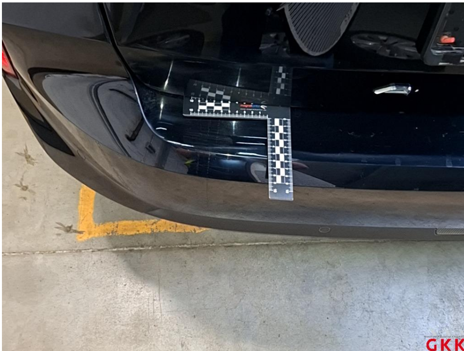
Bild 44 Stoßfänger hinten, Verkleidung -lackiert-, verkratzt, lackieren
