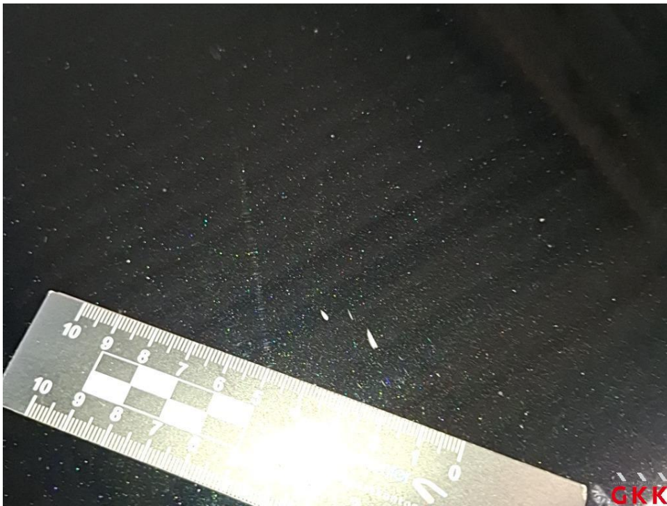
Bild 24 Motorhaube, Steinschlag und Kratzer, lackieren
