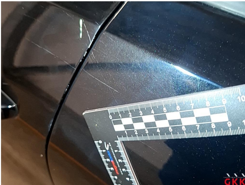
Bild 38 Tür hinten links, verkratzt, lackieren
