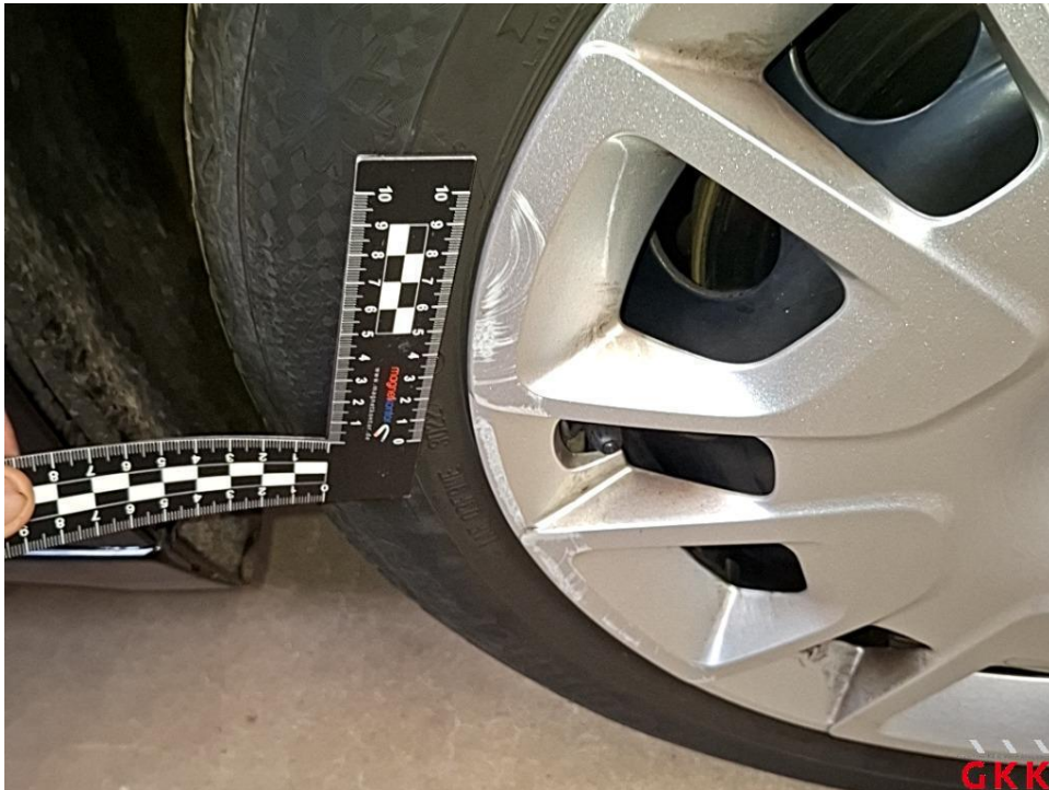
Bild 17 Radkappe(n), vorne rechts, beschädigt, ersetzen
