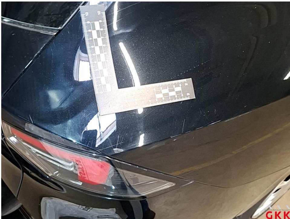
Bild 46 Seitenwand rechts, verkratzt, lackieren
