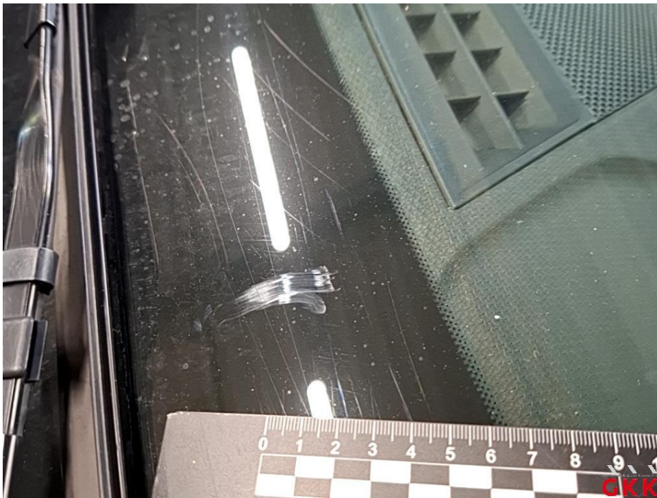
Bild 34 Frontscheibe, mit Regensensor und Frontkamera, verkratzt, ersetzen
