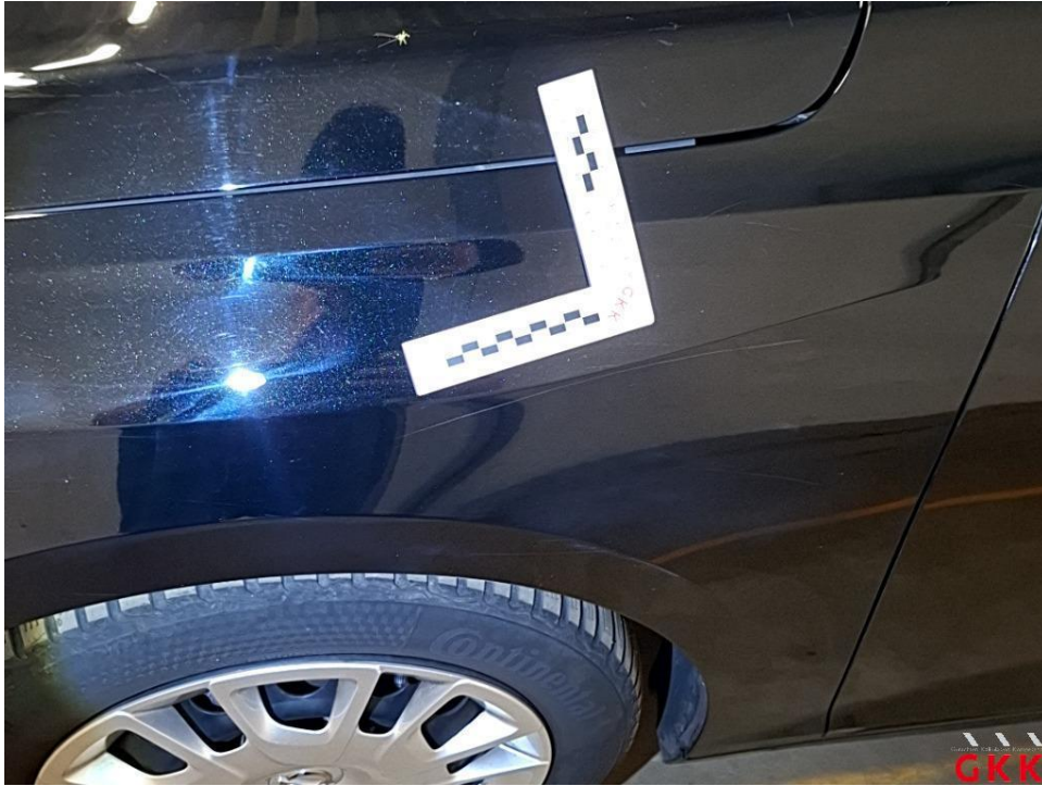
Bild 29 Kotflügel vorne links, verkratzt, lackieren
