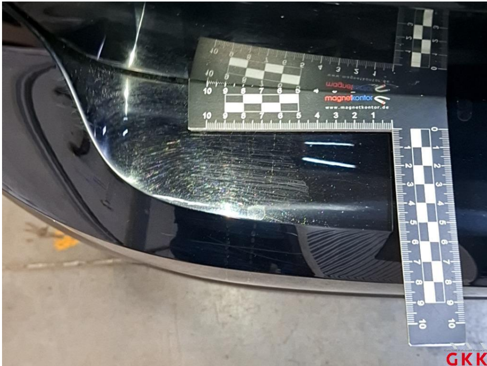
Bild 45 Stoßfänger hinten, Verkleidung -lackiert-, verkratzt, lackieren
