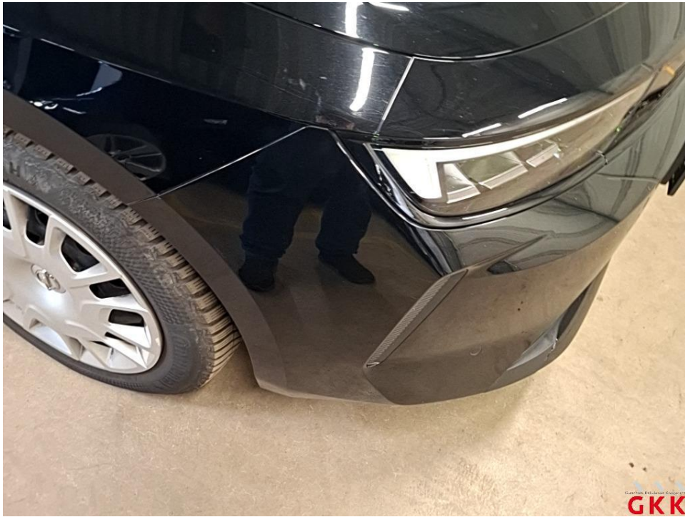
Bild 21 Stoßfänger vorne, Verkleidung -lackiert-, verkratzt, lackieren
