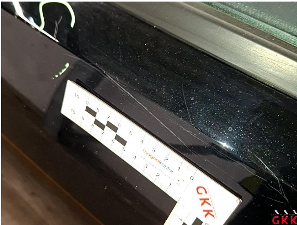
Bild 36 Tür vorne links, verkratzt, lackieren
