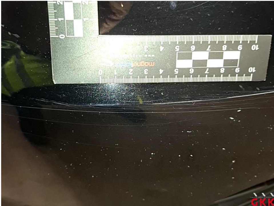
Bild 23 Stoßfänger vorne, Verkleidung -lackiert-, verkratzt, lackieren
