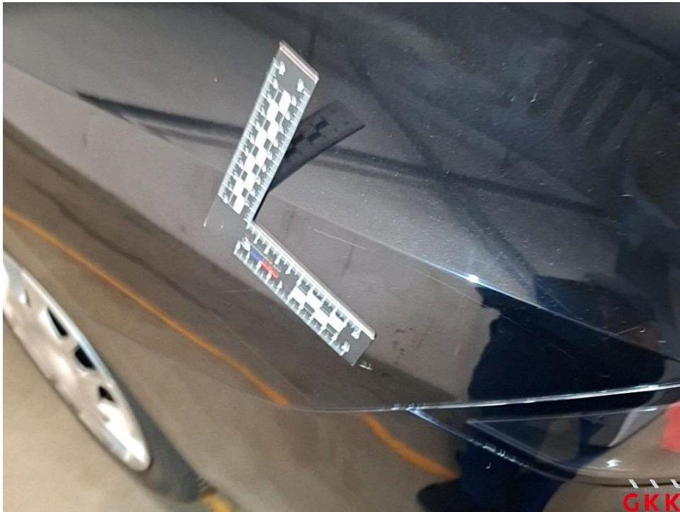
Bild 39 Seitenwand links, verkratzt, lackieren
