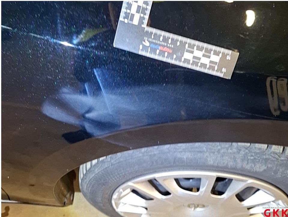
Bild 19 Kotflügel vorne rechts, verkratzt, lackieren
