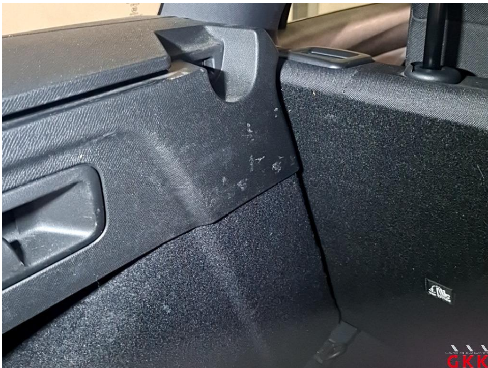
Bild 54 Fahrzeug, innen, verkratzt und verschmutzt, aufbereiten
