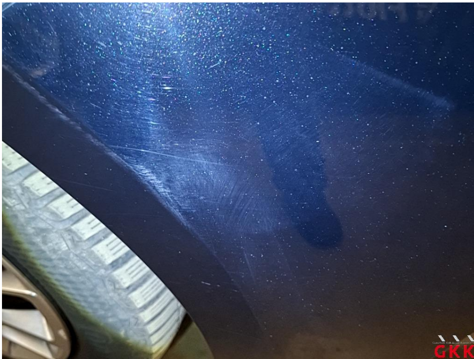
Bild 22 Stoßfänger vorne, Verkleidung -lackiert-, verkratzt, lackieren
