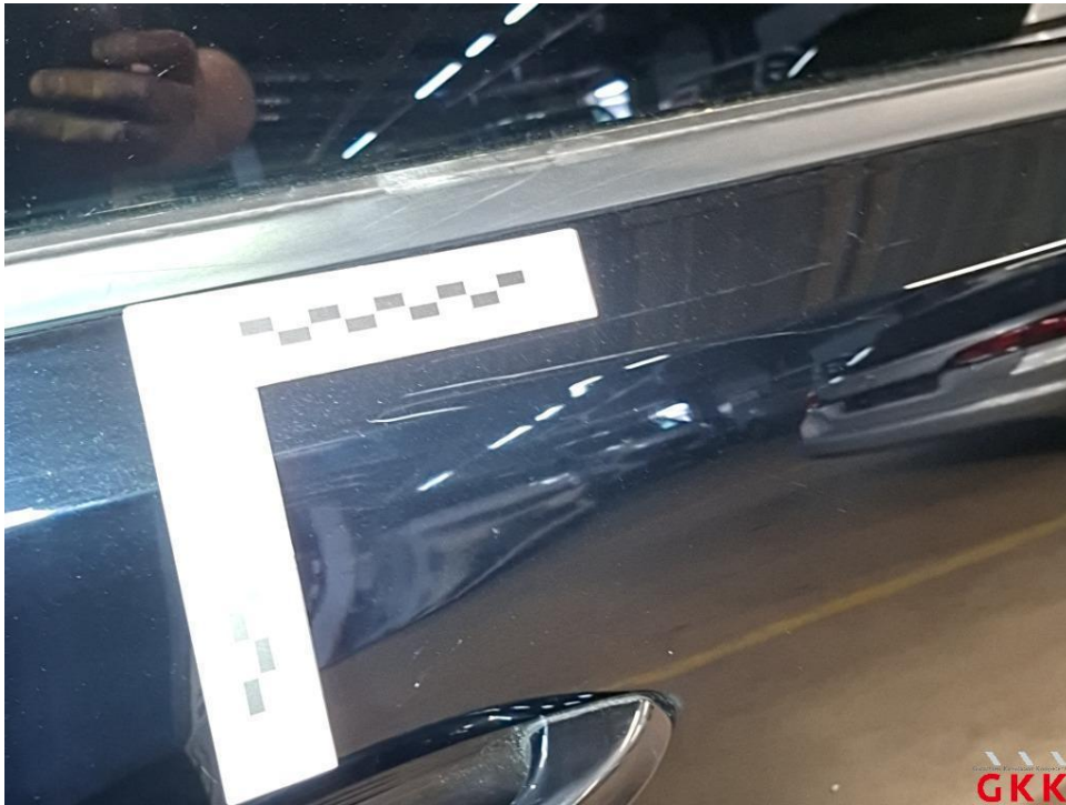
Bild 48 Tür hinten rechts, verkratzt, lackieren
