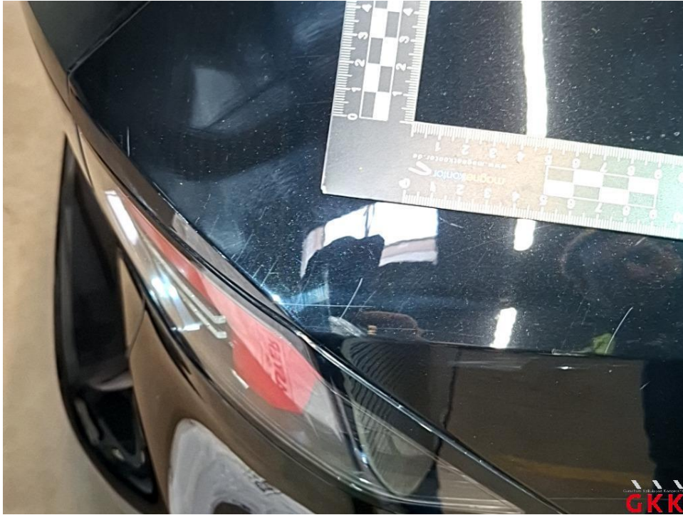
Bild 47 Seitenwand rechts, verkratzt, lackieren
