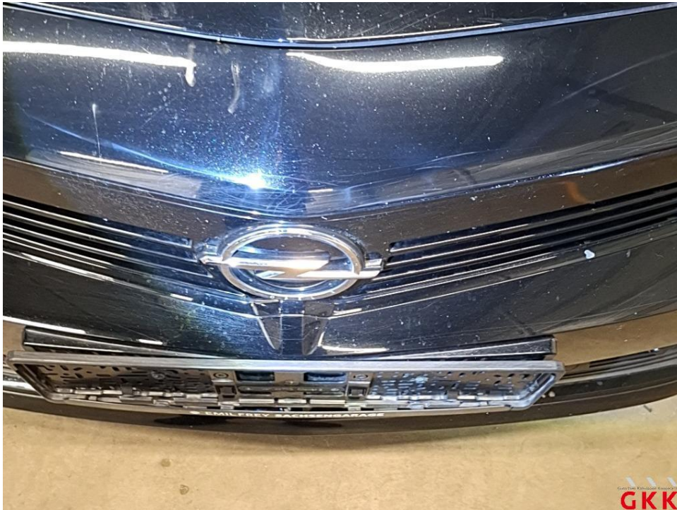
Bild 27 Frontgrill, lackiert, verkratzt, lackieren
