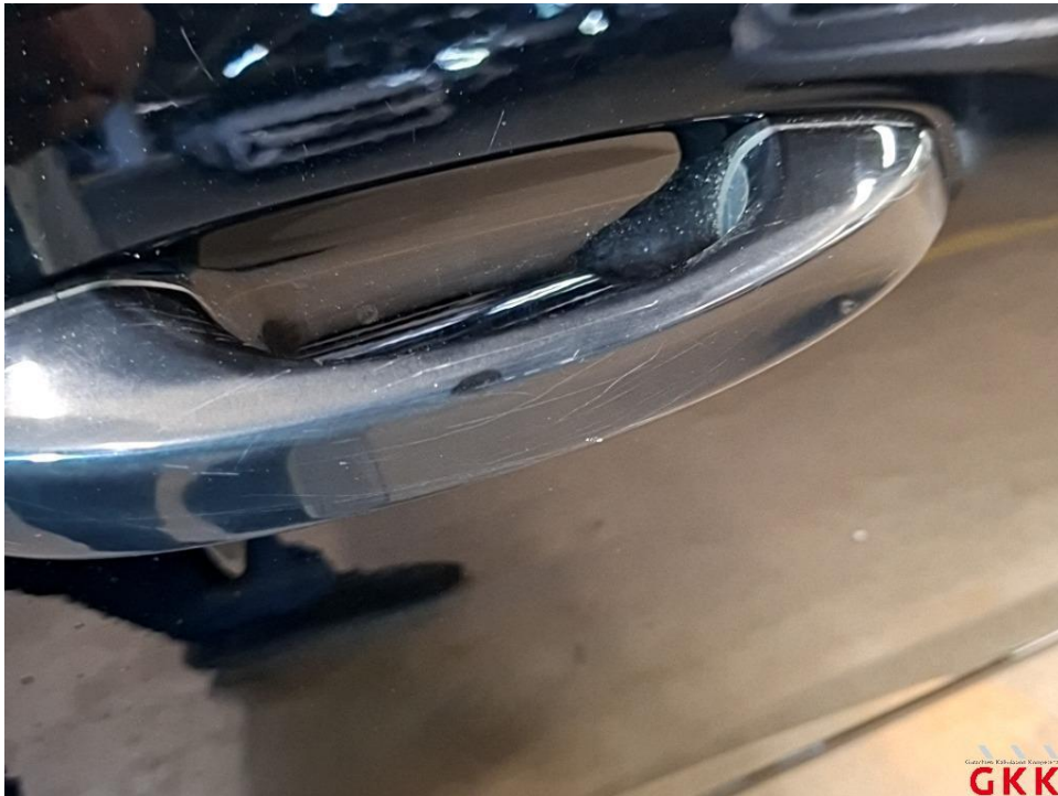
Bild 51 Tür hinten rechts, Griff, verkratzt, lackieren
