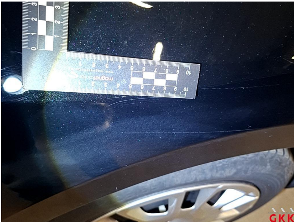
Bild 20 Kotflügel vorne rechts, verkratzt, lackieren
