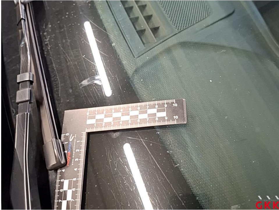
Bild 33 Frontscheibe, mit Regensensor und Frontkamera, verkratzt, ersetzen
