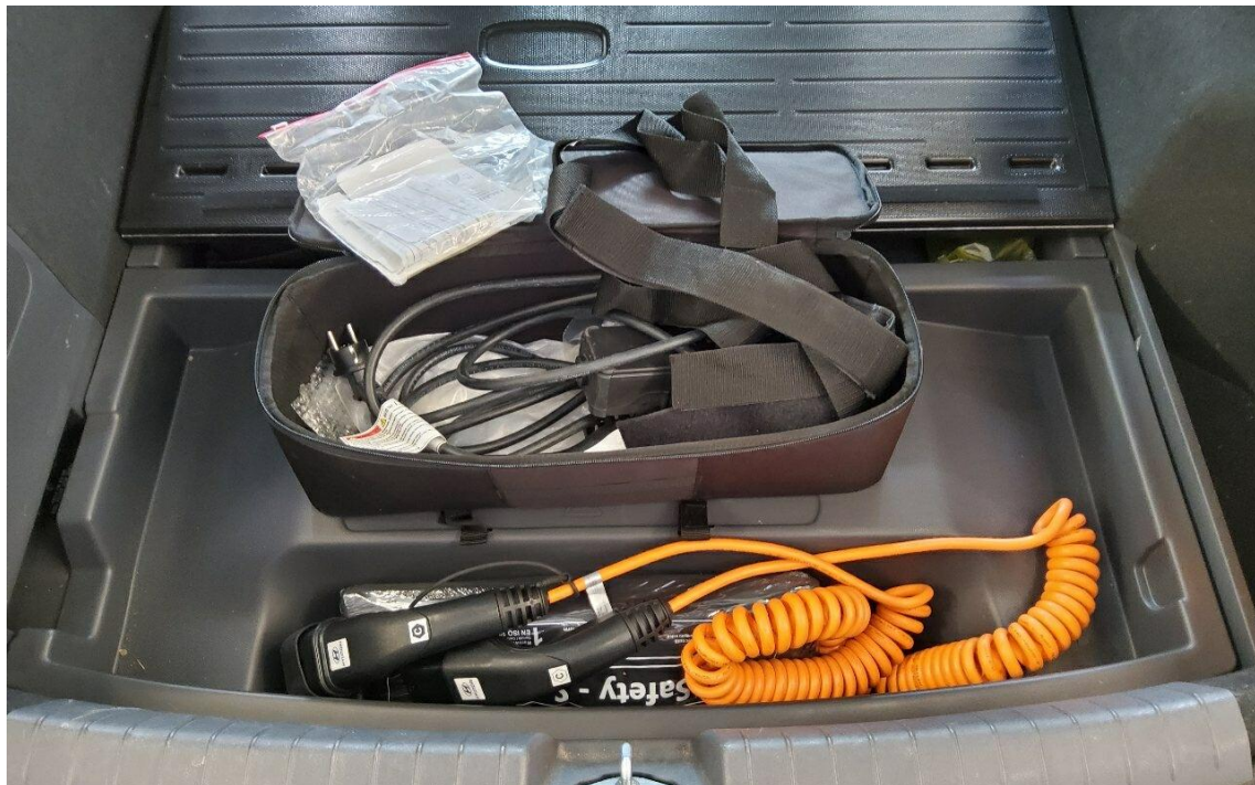
Bild 7 : Ladekabel beim E-Fahrzeug
