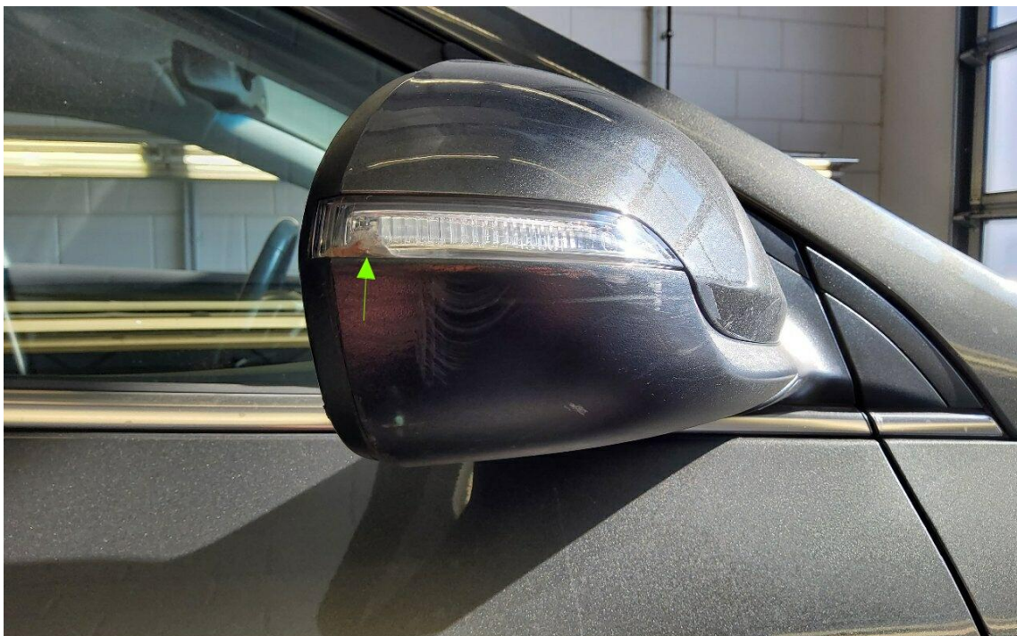
Bild 16 : Blinkerglas Spiegel rechts beschädigt
