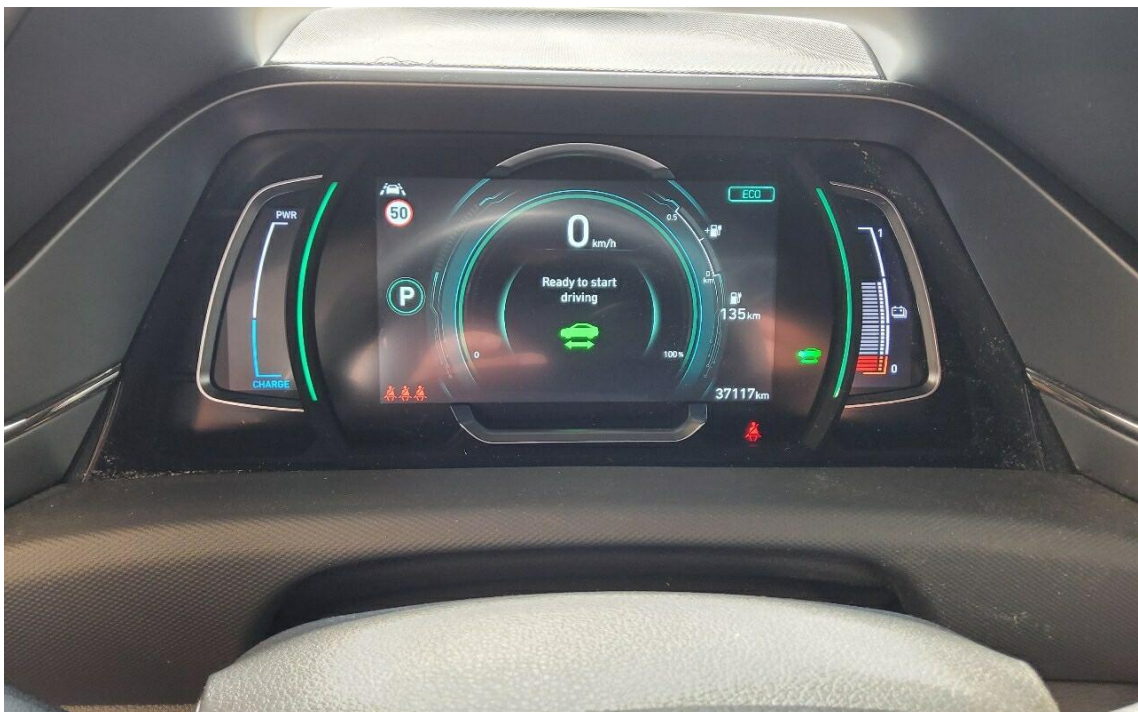
Bild 4 : Kombiinstrument (betriebsbereit) mit Km-Stand
