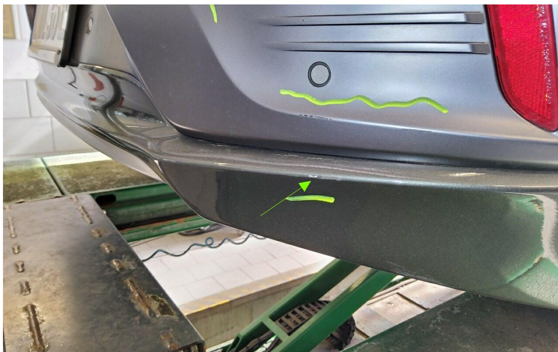
Bild 14 : Stoßfänger hinten verschrammt
