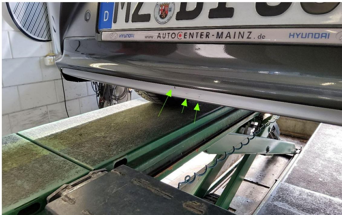
Bild 13 : Zierblende Stoßfänger hinten verschrammt
