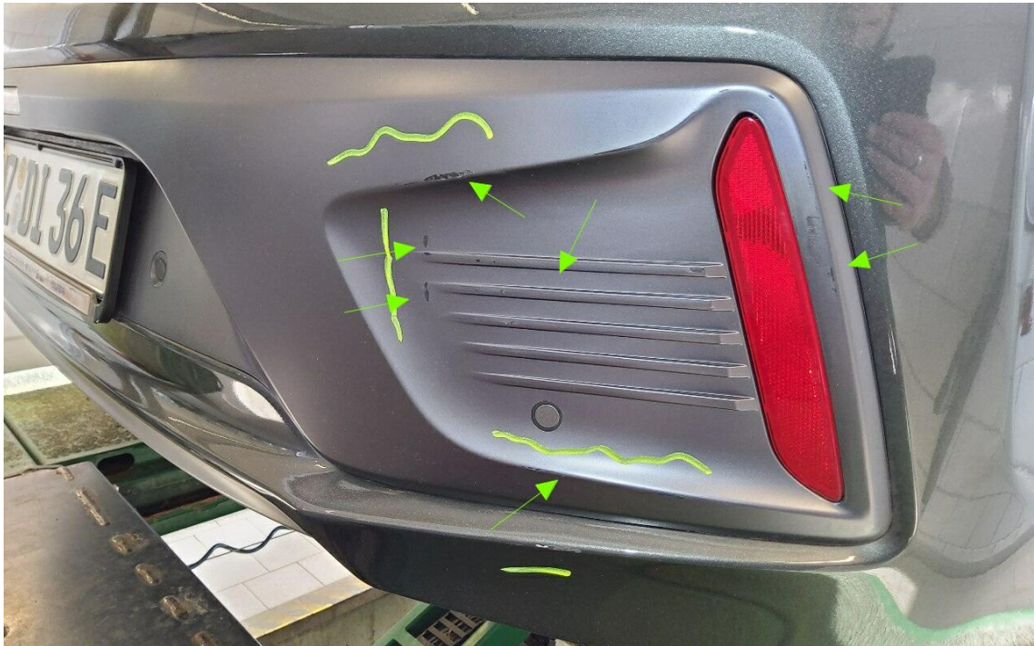
Bild 15 : Verkleidung Stoßfänger hinten verschrammt
