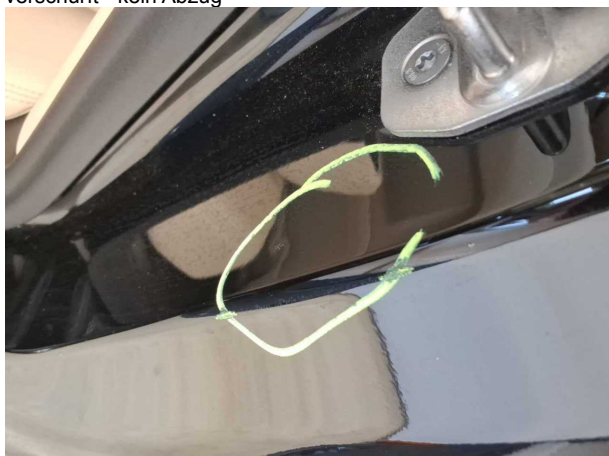
Beschädigung #3: Seitenwand links: Einstieg - Delle(n) - sanft instandsetzen
