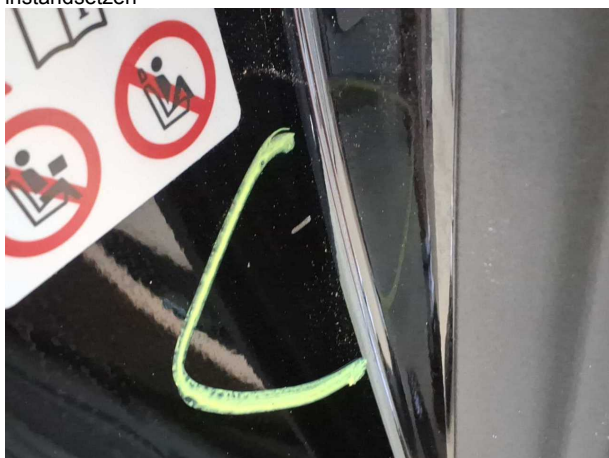
Beschädigung #4: Schweller rechts: Einstieg - Delle / Lackschaden - Smart Repair
