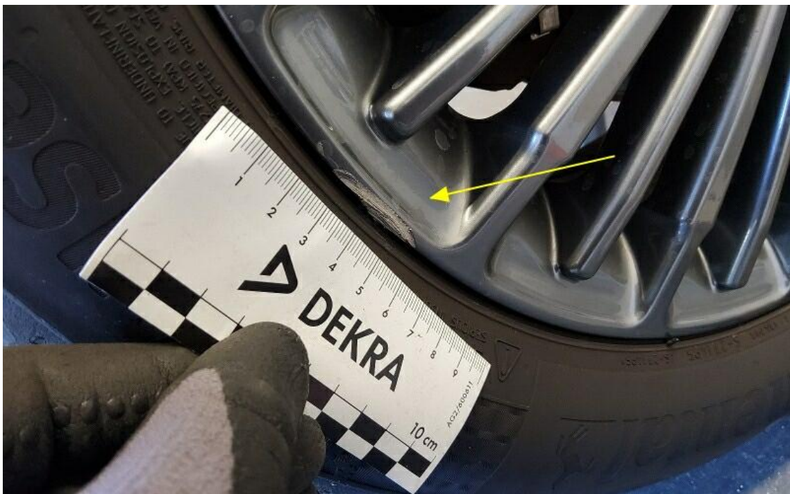
Bild 18 : Felge vorne links, zerkratzt, smart repair
