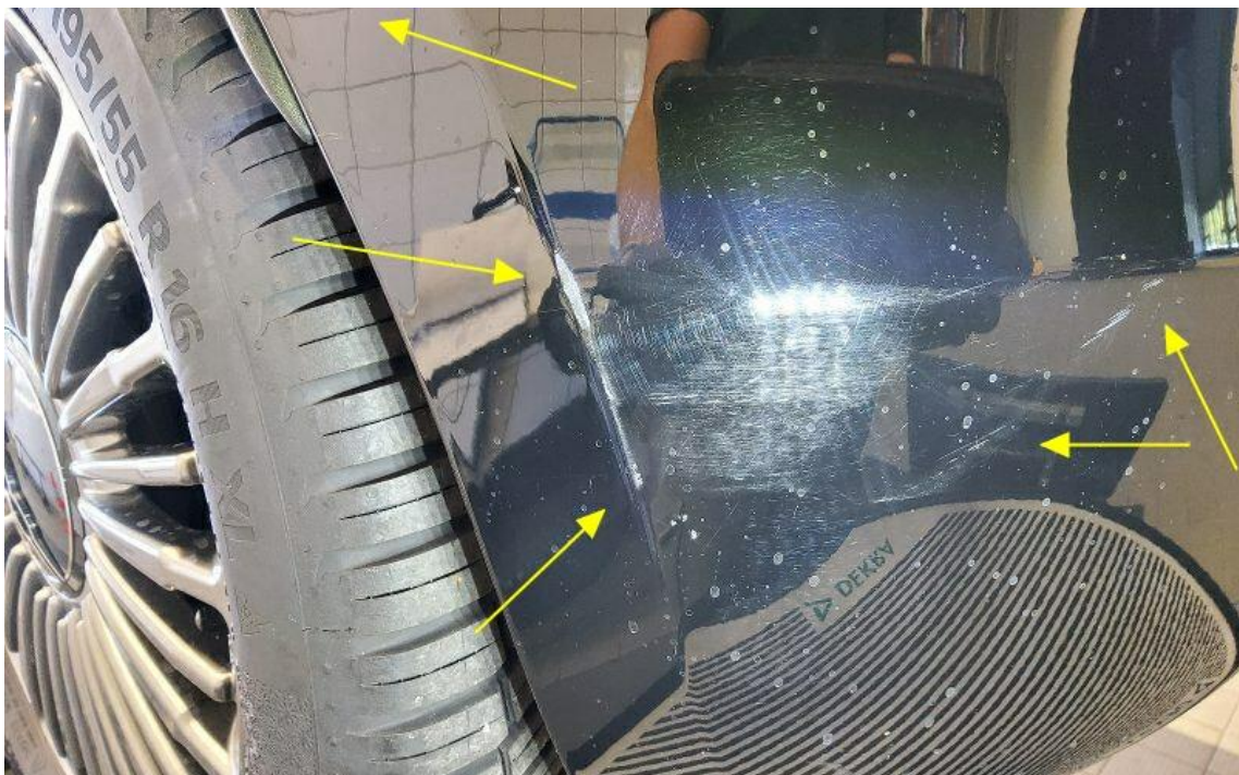
Bild 20 : Stoßfänger hinten deformiert und Rücklicht zerkratzt
