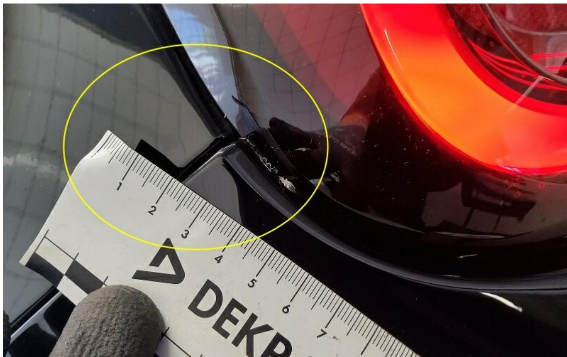
Bild 21 : Stoßfänger hinten deformiert und Rücklicht zerkratzt
