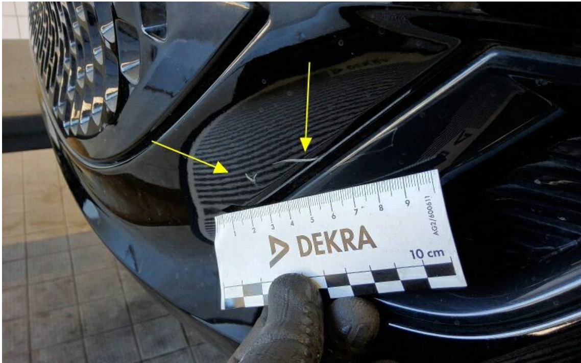
Bild 17 : Stoßfänger vorne, eingedellt, instandsetzen und lackieren mit Lackaufbau
