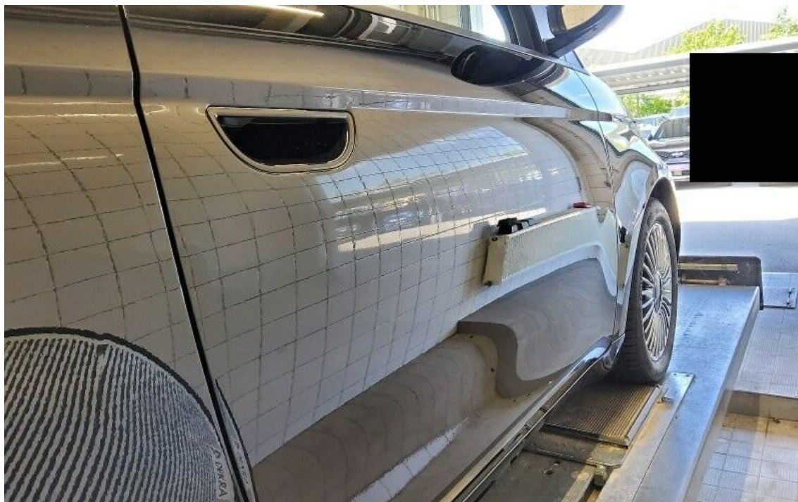
Bild 25 : Tür vorne rechts, eingedellt, Gebrauchsspur
