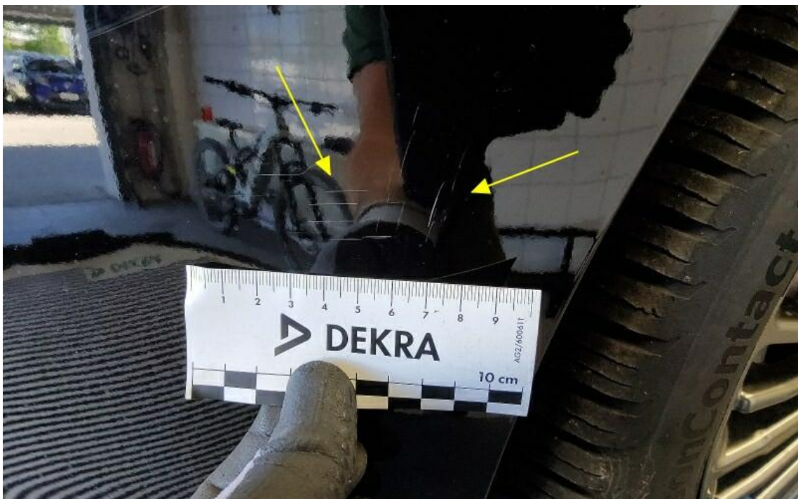
Bild 16 : Stoßfänger vorne, eingedellt, instandsetzen und lackieren mit Lackaufbau
