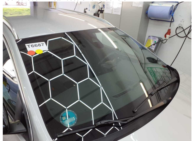
Beschädigung #6: Verglasung: Frontscheibe - beschädigt - erneuern
