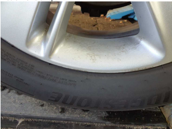
Beschädigung #2: Rad/Reifen: Leichtmetallfelge hinten rechts - Kratzer - Smart Repair
