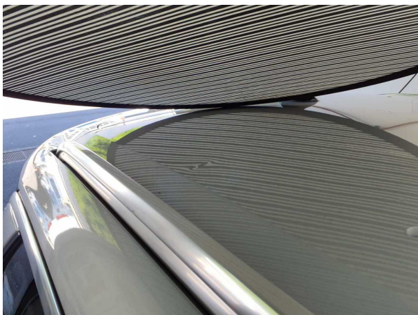
Beschädigung #3: Fahrzeugdach: Dach - Delle(n) - Smart Repair
