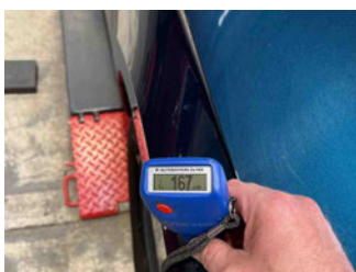
Lackstärke Kotflügel vorne rechts
