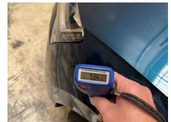
Lackstärke Kotflügel vorne links
