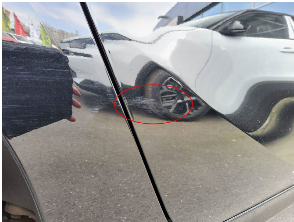
Bild 11 : Tür hinten rechts verkratzt
