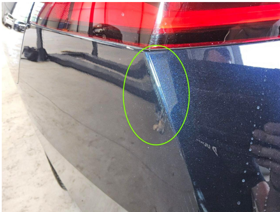
Bild 11 : Stoßfänger hinten links verschrammt
