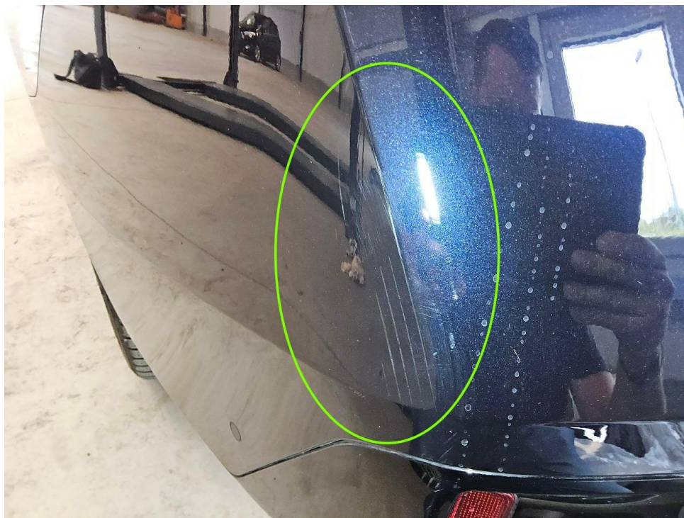
Bild 10 : Stoßfänger hinten links verschrammt
