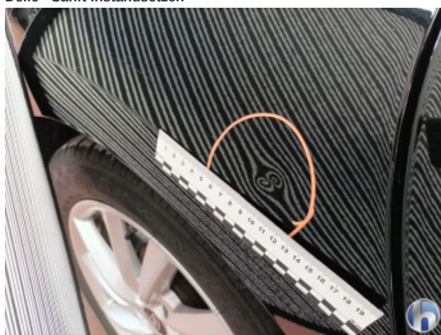
2. Seitenwand - Hinten - Rechts Delle - Sanft Instandsetzen
