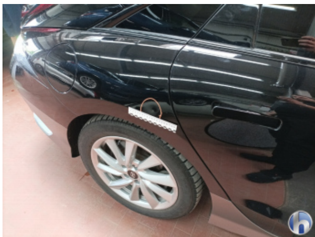
2. Seitenwand - Hinten - Rechts Delle - Sanft Instandsetzen
