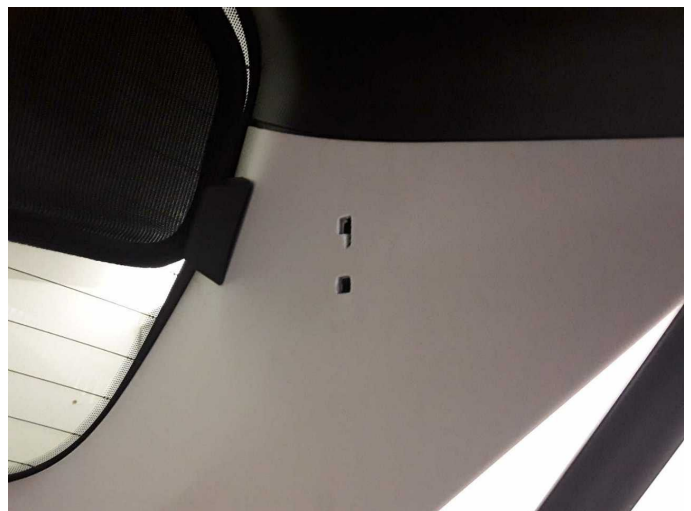
Damage 2: Boot lid / rear door: Trim - standard - lower (Halterung fehlt) - Missing - Replace
