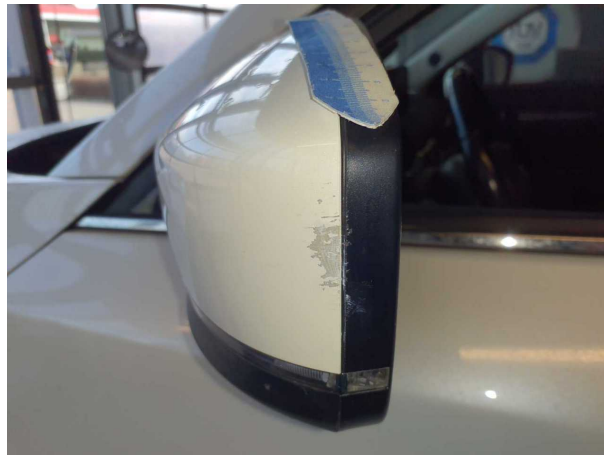
Beschädigung #2: Außenspiegel links: Abdeckkappe - verkratzt / verschürft - Smart Repair
