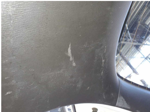
Beschädigung #1: Verkleidungen/Abdeckungen: Heckdeckel, Innenverkleidung - verkratzt / verschürft - Wertminderung
