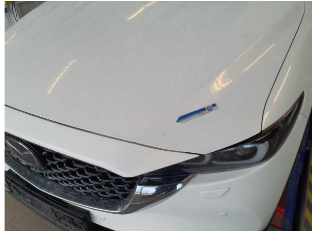
Beschädigung #7: Motorhaube: Motorhaube - Lackmangel - Smart Repair
