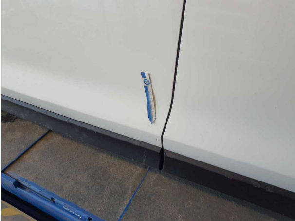
Beschädigung #12: Tür vorn links: Tür - verkratzt / verschürft - lackieren
