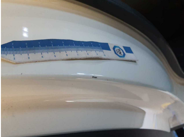
Beschädigung #10: Seitenwand rechts: Einstieg - Delle / Lackschaden - Smart Repair
