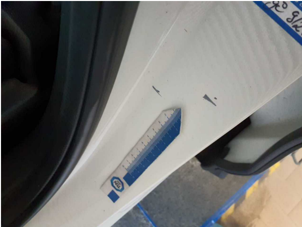
Beschädigung #9: Karosserie: B-Säule links - Delle / Lackschaden - Smart Repair
