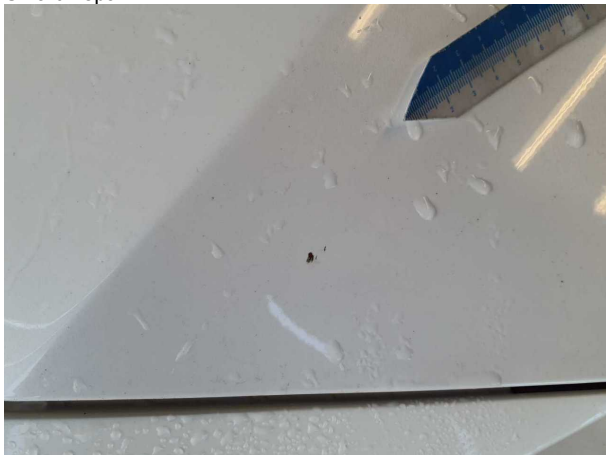
Beschädigung #7: Motorhaube: Motorhaube - Lackmangel - Smart Repair
