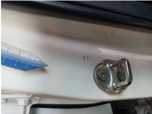
Beschädigung #6: Karosserie: B-Säule rechts - verkratzt / verschürft - Smart Repair
