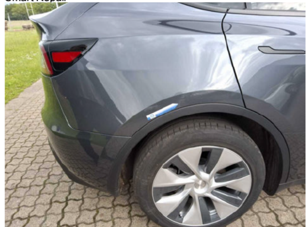
Beschädigung #5: Seitenwand rechts: Seitenwand - Kratzer - Smart Repair
