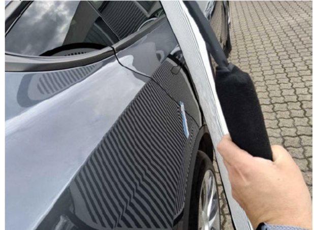
Beschädigung #4: Seitenwand rechts: Seitenwand - Delle(n) - Smart Repair
