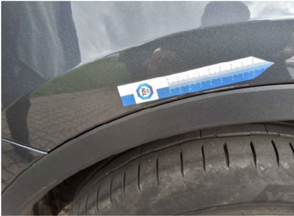
Beschädigung #5: Seitenwand rechts: Seitenwand - Kratzer - Smart Repair
