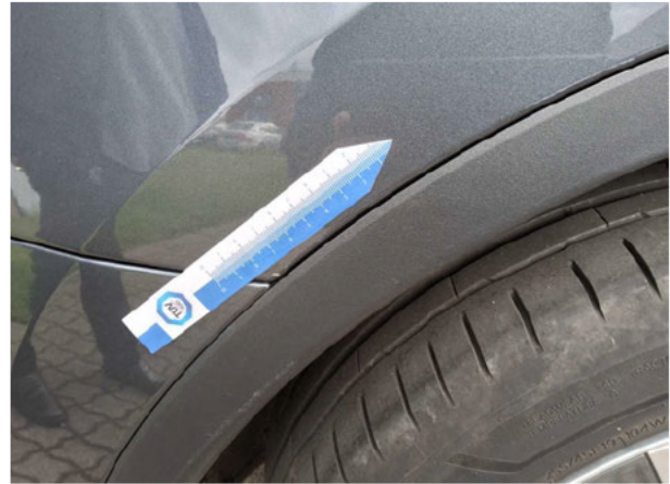
Beschädigung #5: Seitenwand rechts: Seitenwand - Kratzer - Smart Repair
