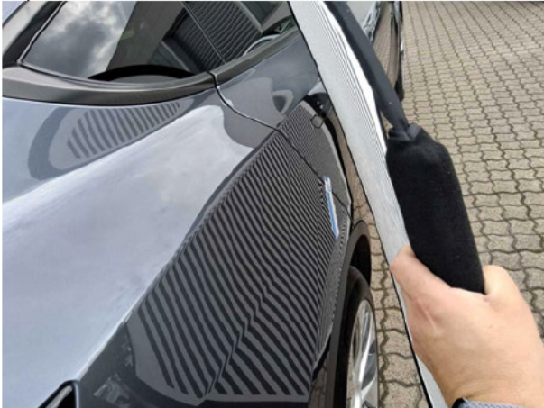
Beschädigung #4: Seitenwand rechts: Seitenwand - Delle(n) - Smart Repair
