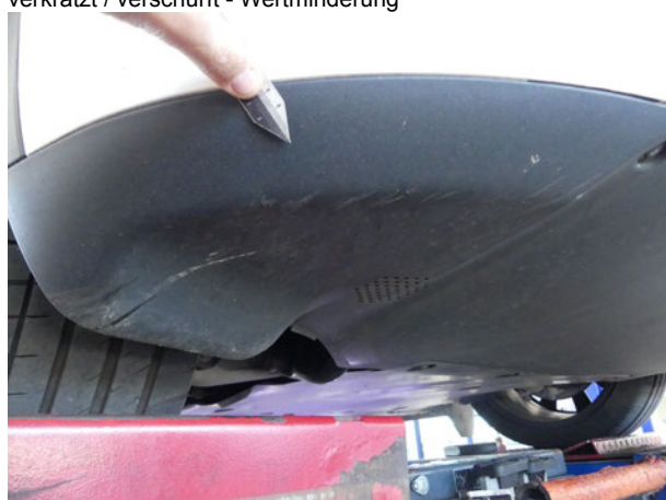
Beschädigung #2: Stossfänger vorn: Spoiler - Kratzer - erneuern
