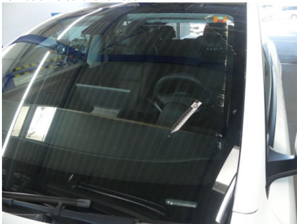
Beschädigung #6: Verglasung: Frontscheibe - Steinschlag - erneuern
