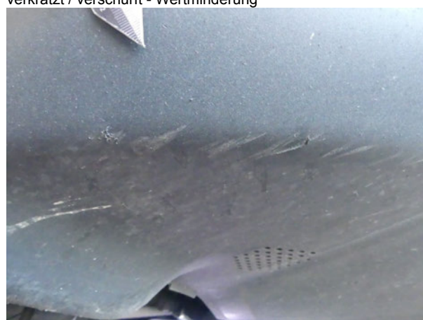
Beschädigung #2: Stossfänger vorn: Spoiler - Kratzer - erneuern
