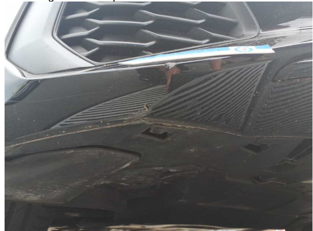
Beschädigung #1: Stossfänger vorn: Stossfänger vorn - beschädigt - Smart Repair
