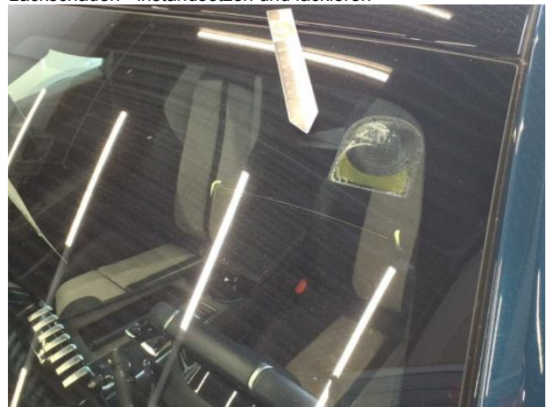
Beschädigung #6: Verglasung: Frontscheibe (Und schleifspurenwischer) - Kratzer - erneuern
