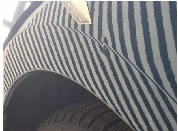
Beschädigung #2: Seitenwand rechts: Seitenwand - Delle(n) - sanft instandsetzen
