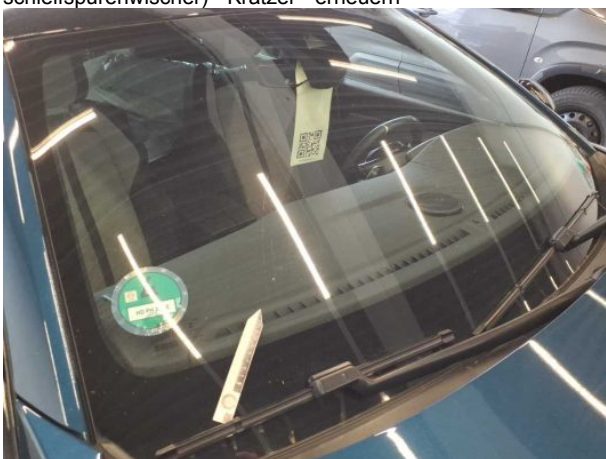
Beschädigung #6: Verglasung: Frontscheibe (Und schleifspurenwischer) - Kratzer - erneuern
