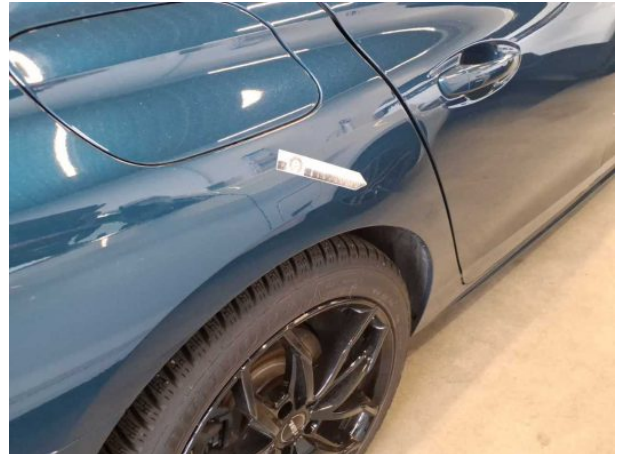
Beschädigung #2: Seitenwand rechts: Seitenwand - Delle(n) - sanft instandsetzen
