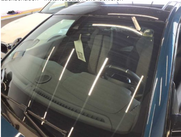
Beschädigung #6: Verglasung: Frontscheibe (Und schleifspurenwischer) - Kratzer - erneuern
