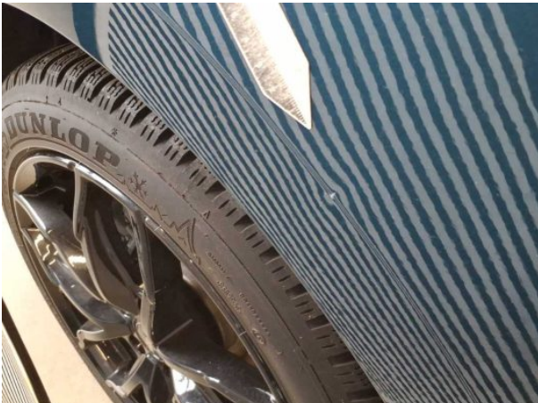
Beschädigung #2: Seitenwand rechts: Seitenwand - Delle(n) - sanft instandsetzen
