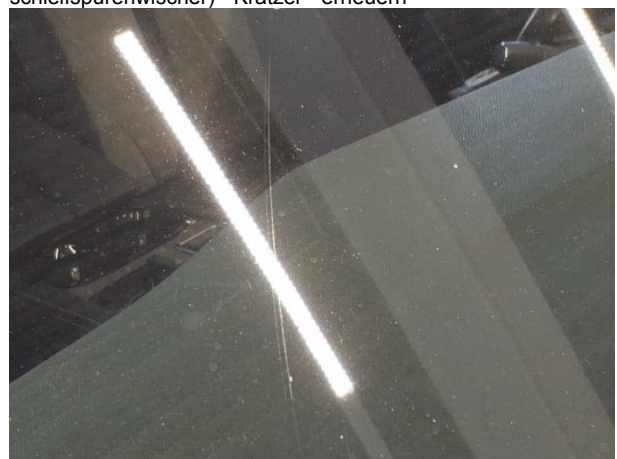
Beschädigung #6: Verglasung: Frontscheibe (Und schleifspurenwischer) - Kratzer - erneuern
