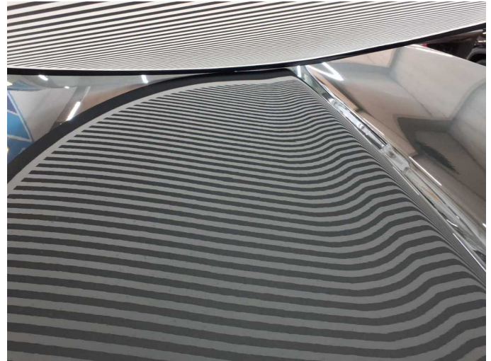
Damage 6: Bonnet: Bonnet (Vermutlich von einem Nussbaum / 12x) - dent(s) - Smooth repair work
