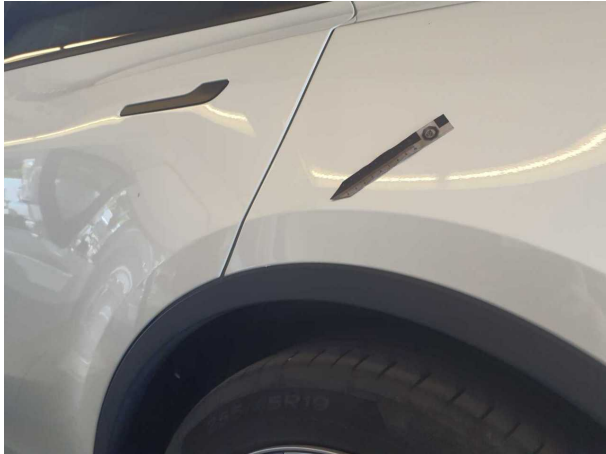
Beschädigung #1: Seitenwand links: Seitenwand - Delle(n) - sanft instandsetzen
