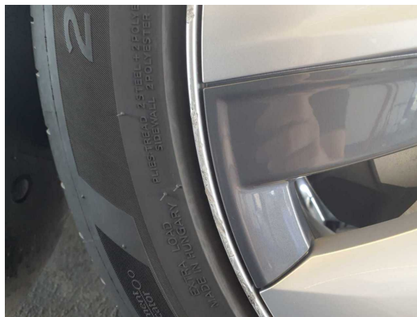
Beschädigung #8: Rad/Reifen: Leichtmetallfelge vorn rechts - verkratzt / verschürft - erneuern
