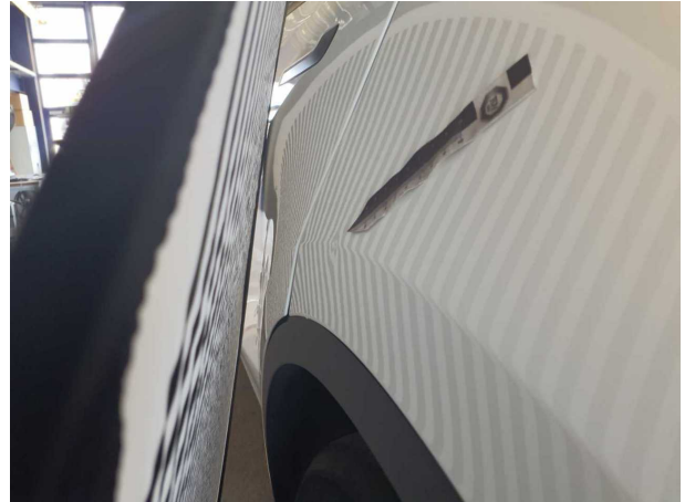
Beschädigung #1: Seitenwand links: Seitenwand - Delle(n) - sanft instandsetzen
