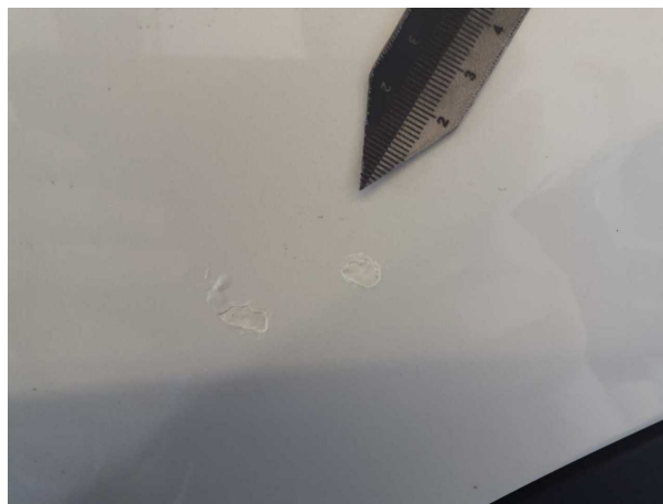
Beschädigung #10: Tür hinten links: Tür - Lackmangel - instandsetzen und lackieren
