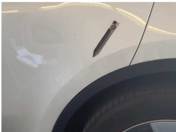
Beschädigung #10: Tür hinten links: Tür - Lackmangel - instandsetzen und lackieren
